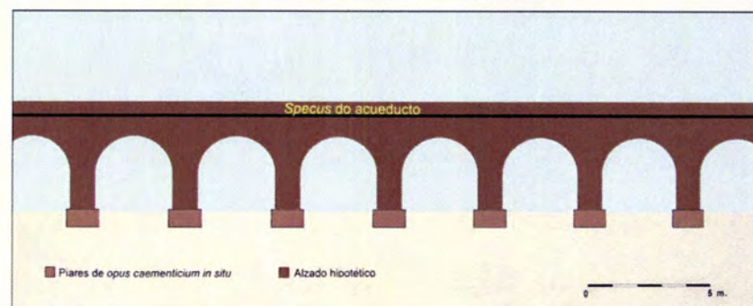
Fig. 24 Planta, alçado e reconstituição hipotética do aqueduto de Lucus Augusti Fonte: Rubén Álvarez Asorey
