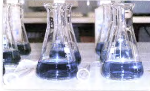
Fig. 3.6 – Determinação do fósforo por colorimetria.
