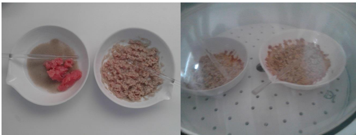
Figura 10. Amostras de carne antes e após mistura com areia tratada e etanol (esquerda) e arrefecimento nos exsicadores (direita)
