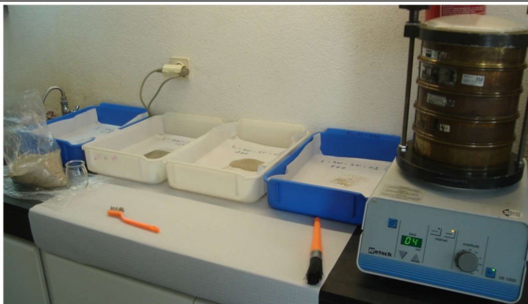
Figura A.11 – Metodologia e equipamento de separação granulométrica (agitador de peneiros) das frações das amostras estudadas.
