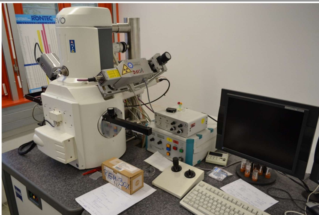
Figura A.14 – Detector de catodoluminescência acoplado a um SEM do Museu de Mineralogia e Geologia do Senckenberg Naturhistorische Sammlungen em Dresden, Alemanha.
