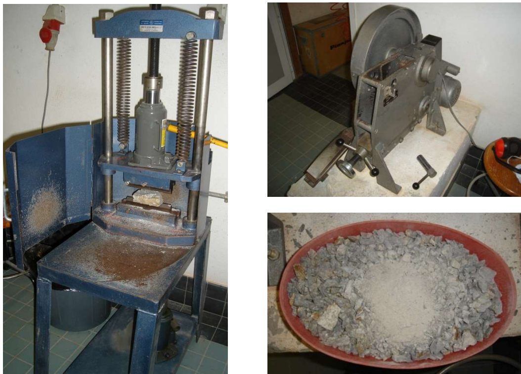
Figura A.10 – Equipamento utilizado para a fraturação inicial da amostra: prensa hidráulica (lado esquerdo) e um moinho de maxilas (lado direito em cima); em baixo, à direita, a amostra em fraturação progressiva até serem obtidas frações inferiores a cerca de 0,5 cm.
