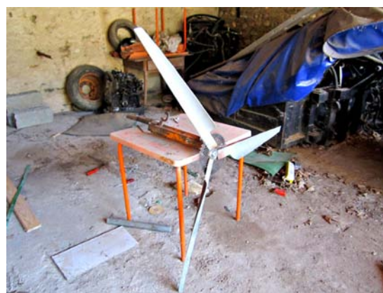
i183. Cabeça acoplada a um suporte construído a partir de uma aba de atrelado de tractor, pronto para receber a polis que ligará ao alternador que carregará uma bateria de 12V.
