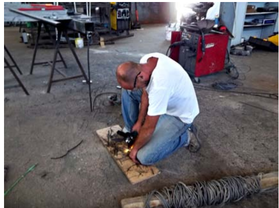
i170. Cortando os cabos de aço à medida, preterindo aquelas partes mais espigadas.
