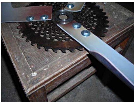
i182. Cabeça da eólica. Disco de 42 dentes de moto-roçadora, pás em tubo de PVC de 120 mm.
