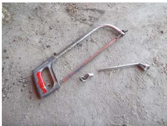
i101. Chave de bocas serrada por Zé Gato, sucateiro e bricoleur, de forma a caber entre o alternador e o bloco de um motor. (2013). A construção de ferramenta própria como expressão de autonomia perante o léxico e a sintaxe dos processos.
