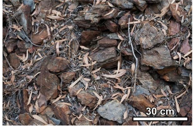
**Figura 6.16** – Aspecto dos xistos acastanhados depositados em escombreira (classe E9).
