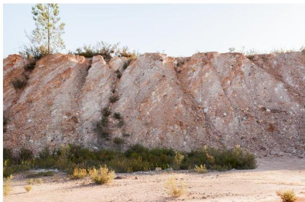
**Figura 6.11** - Escombreira de vulcanitos ácidos vulcanizados (classe E7).
