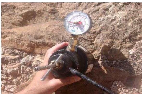
Fig. 7 – Ensaio de arrancamento numa hélice.
