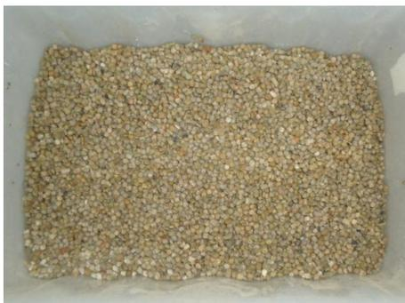
**Figura 29 - Silicato de cálcio embebido na argila expandida.**
