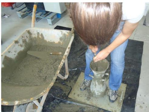
Figura 33 - Enchimento do molde seguido de 25 pancadas.
