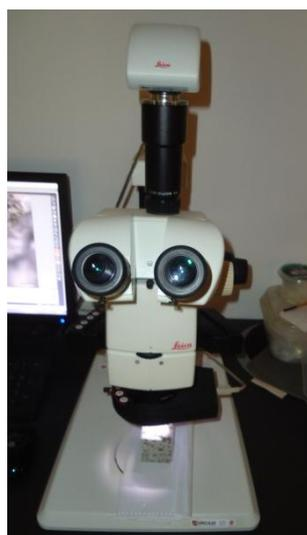
Figura 41 - Microscópio trinocular estéreo zoom, marca Leica.
