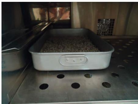
**Figura 5 - Provete de argila expandida na estufa.**
