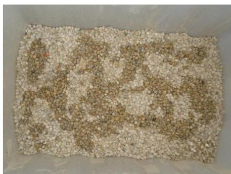
Figura 28 - Silicato de cálcio ao ser embebido na argila expandida.
