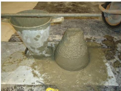
**Figura 34 - Medição do abaixamento.**
