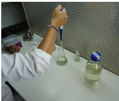
Figura 22 - Introdução do meio alcalino líquido com bactéria no meio de esporulação.
