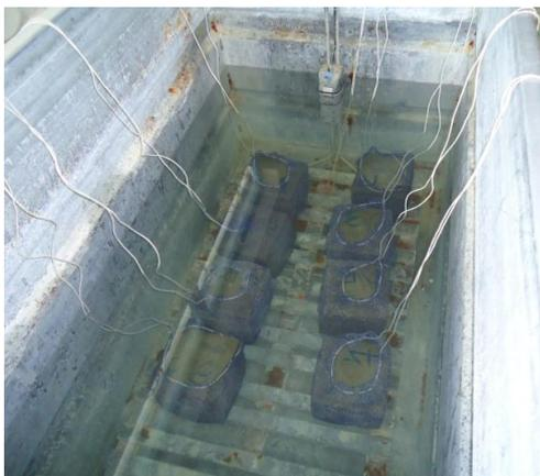
Figura 32 - Provetes BASEH na cura húmida.
