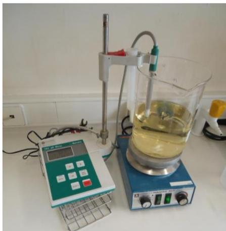
Figura 11 - Aparelho de medição do pH na solução do agar nutritivo.
