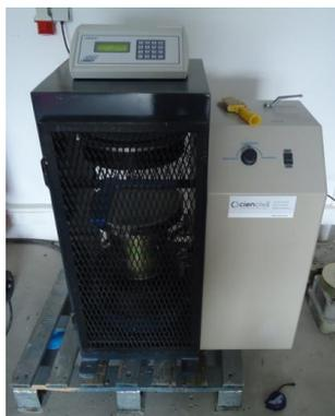
Figura 39 - Máquina de ensaio a resistência à compressão.
