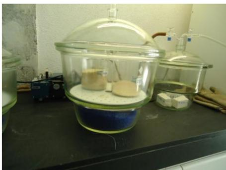
**Figura 6 - Amostra de areia no dessecador de vidro.**
