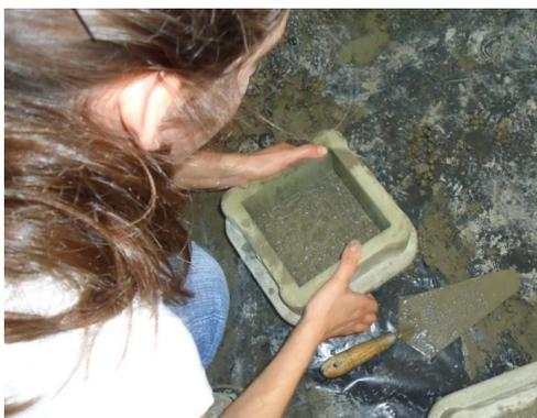
**Figura 35 - Compactação manual do provete.**
