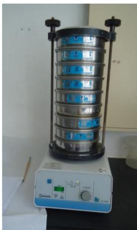
Figura 4 - Máquina de peneiração com os peneiros utilizados.
