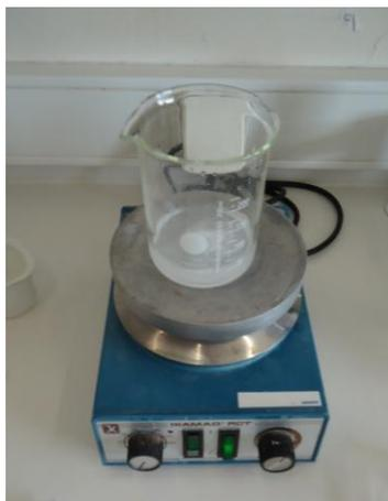
Figura 13 - Recipiente com  $\text{NaHCO}_3$  e água destilada.
