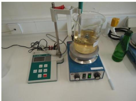
Figura 17 - Medição do pH da solução final.
