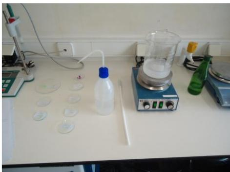
Figura 16 - Diluição do EDTA- Na<sub>2</sub>.2H<sub>2</sub>O na água destilada e os restantes reagentes pesados.
