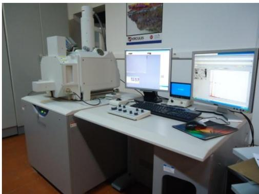
**Figura 42 - Microscópio electrónico de varrimento com espectroscopia dispersiva de Raios-X.**
