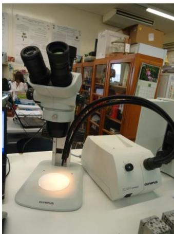
Figura 40 - Microscópio trinocular estéreo zoom, marca Olympus.
