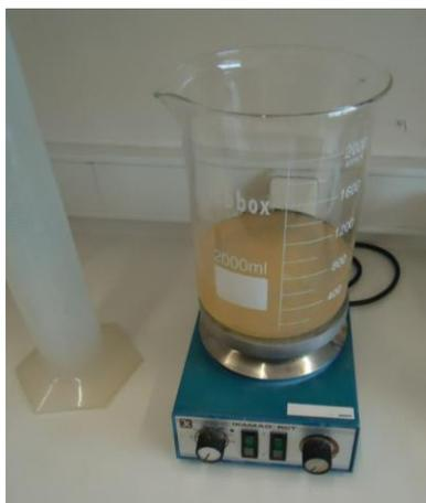
Figura 12 - Solução com 500 ml com agar.
