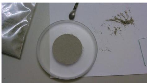
Figura 45 - Amostra de betão preparada para a difração de Raios-X.
