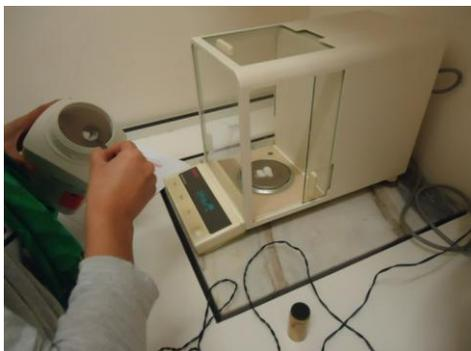
Figura 15 - Pesagem do reagente EDTA- Na<sub>2</sub>.2H<sub>2</sub>O na balança da marca OHAUS analytical plus.
