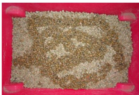
Figura 25 - Impregnação do acetato de cálcio na argila expandida.
