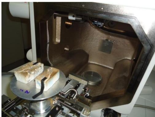
Figura 44 - Amostras apos metalizadas no SEM/EDS.
