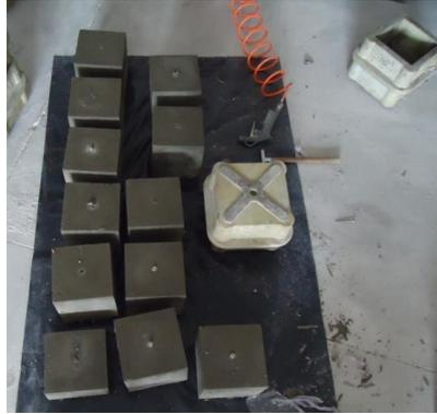
Figura 37 - Desmolde dos provetes.
