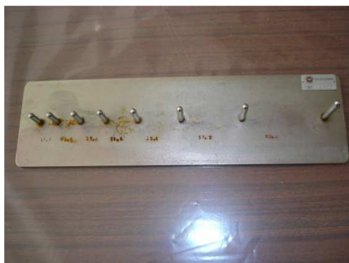
Figura 11 – Régua de Pernes utilizada para a determinação do índice de alongamento, segundo a norma portuguesa.
