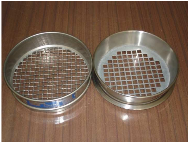
Figura 6 – À esquerda um peneiro da série ASTM utilizado nos ensaios segundo as normas portuguesas. À direita um peneiro de chapa perfurada utilizado nas novas normas europeias.
