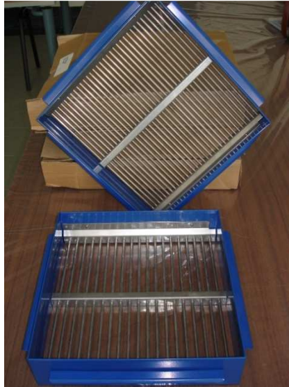
Figura 10 – Peneiros de barras utilizados no ensaio de Índice de achatamento, segundo a norma europeia.
