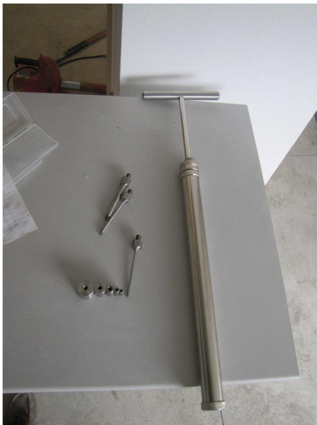
Figura 10 – Penetrómetro
