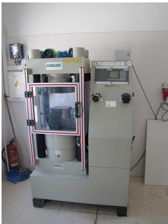
Figura 14 – Prensa resistência compressão
