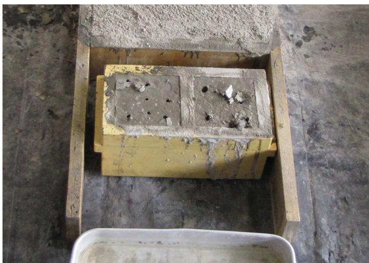
Figura 9 – Cubos para realização ensaio penetrómetro
