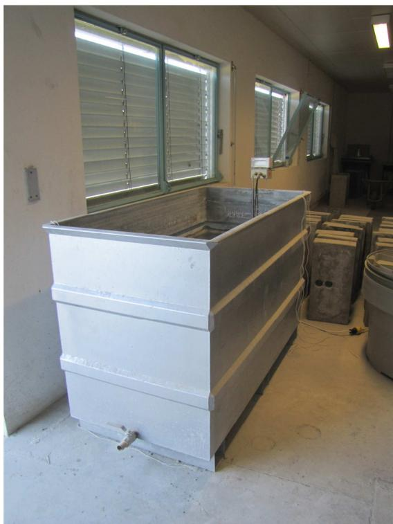
Figura 13 – Tanque de cura
