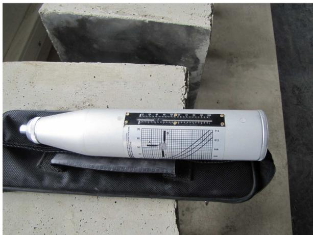
Figura 20 – Esclerómetro
