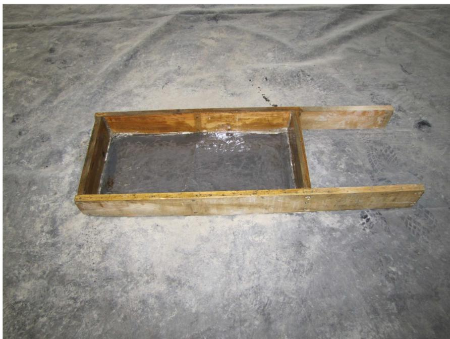
Figura 6 – Cofragem para lajeta de 600 x 300 x 100 mm<sup>3</sup>
