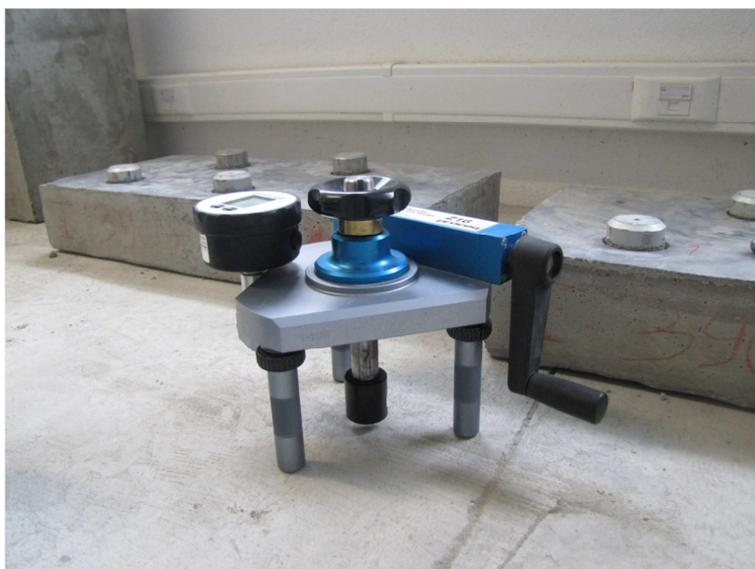
Figura 19 – Ensaio Pull-Off
