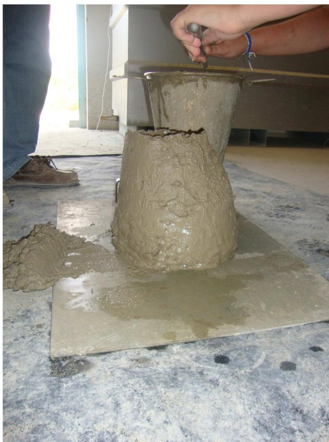
**Figura 5 – Ensaio cone Abrams**
