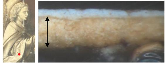
b *Anjo da Anunciação* grisalha, corte estratigráfico amostra branco da manga, preparação com várias camadas espessura (90 µm)
