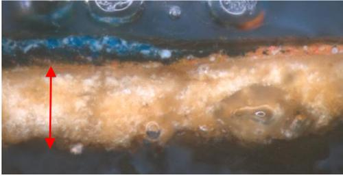
**Figs.2.2.34** *Ecce Homo* Identificação da preparação original com uma espessura (c. de 210  $\mu\text{m}$ ). Corte estratigráfico com localização da preparação junto ao suporte (encolagem) com uma espessura. Amostra analisada por MEV-EDX
