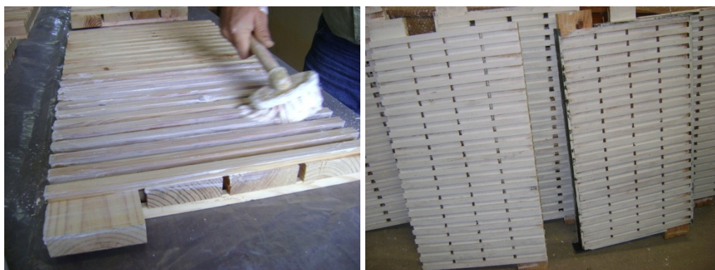
Figura 54. Aplicação de leite cal e aspeto dos painéis após a secagem da caição.
