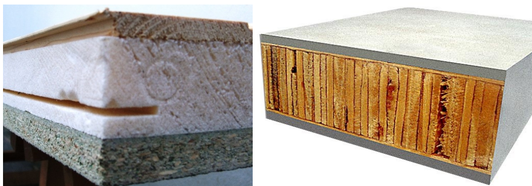
Figura 48. Painel Sanduíche com EPS, madeira maciça e aglomerado de partículas e amostra de ICOWALLPANEL 260 .
