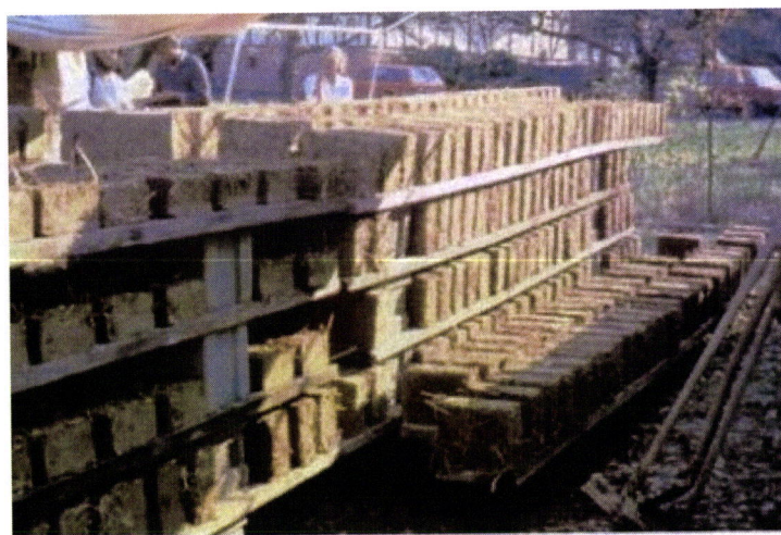
FIG. III.76 - ALEMANHA – Darmstadt – Blocos de terra-palha em processo de secagem. 28
