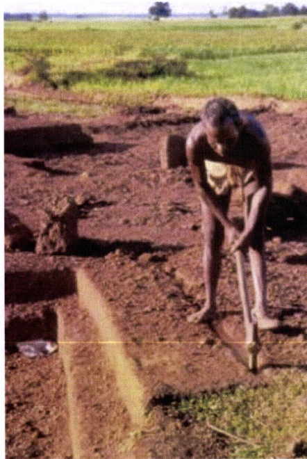
FIG. III.70 - Em cima – BURKINA-FASO – Kari – Processo de extracção dos blocos depois de recortados lateralmente 27
