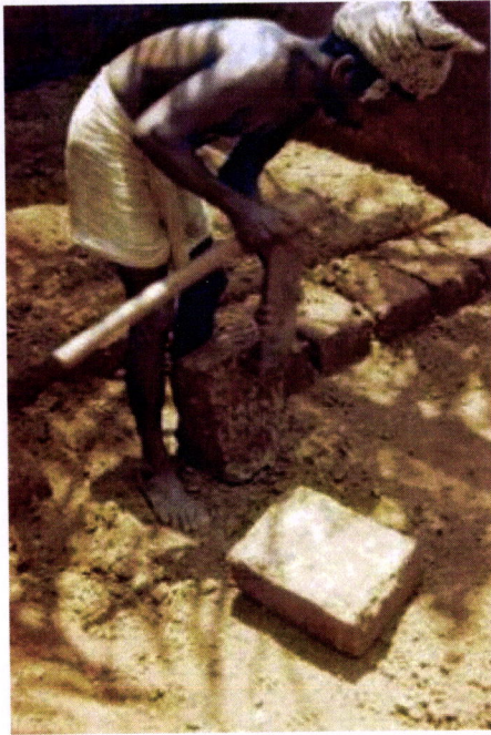
FIG. III.72 - Em cima - BURKINA-FASO - Kari - Vista geral de uma extracção de blocos.
