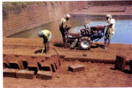
FIG. III.73 - À esquerda - ÍNDIA - Kerala - Blocos na fase de aparelhagem e ajuste do corte.
