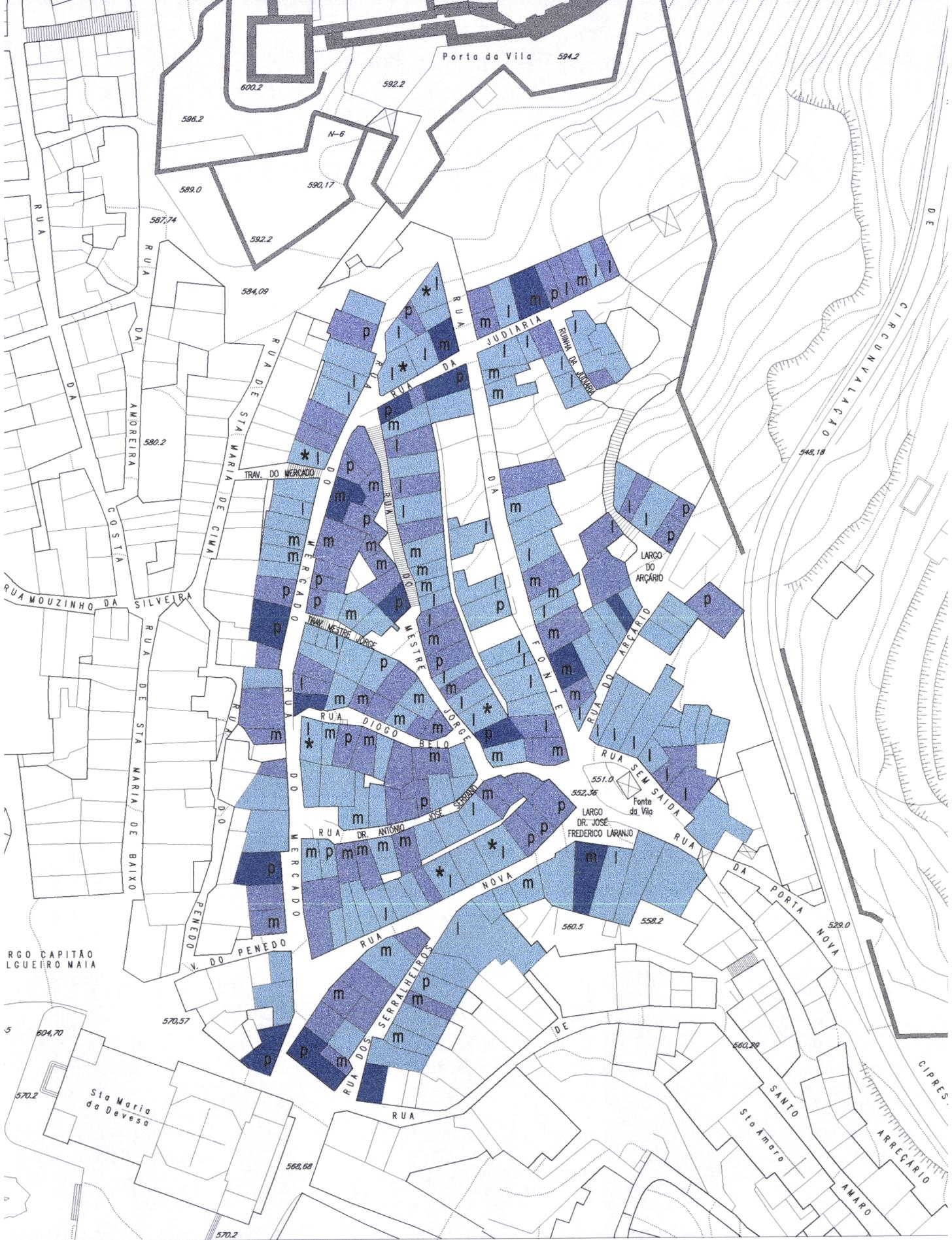
**Fig. 8.1 - PLANTA DO GRAU DE ALTERAÇÃO EXTERIOR E INTERIOR DOS SISTEMAS CONSTRUTIVOS**
