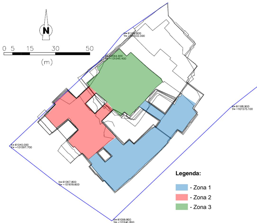
Figura 7.27 – Excerto da planta da pedra com as zonas consideradas no levantamento da fraturação.
