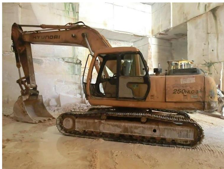
Figura 4.25 – Escavadora de rastos com balde acoplado.
