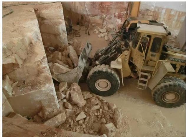
**Figura 5.62** – Utilização da pá carregadora no carregamento dos escombros.
