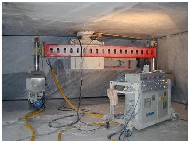
**Figura 5.32** – Posicionamento da lança da roçadora acima do motor. (Fonte: Benetti Macchine).
