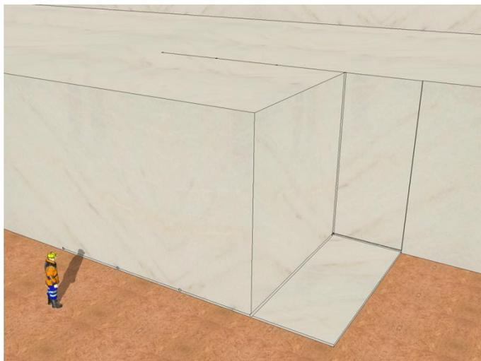
**Figura 6.33** – Representação 3D da bancada após o desmonte da primeira talhada.
