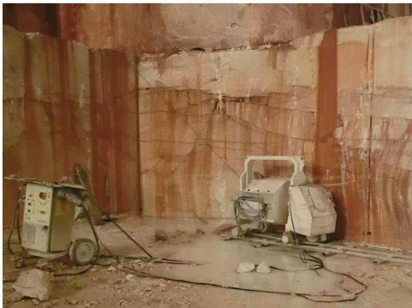
**Figura 4.12** – Conjunto completo de corte: máquina de fio diamantado, carris, central elétrica de comando e fio diamantado.
