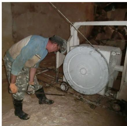
**Figura 5.24** – Alinhamento da direção do carril recorrendo a uma barra de ferro.
