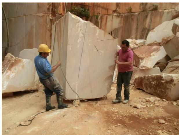
**Figura 5.54** – Envolvimento de um bloco com os cabos de aço.
