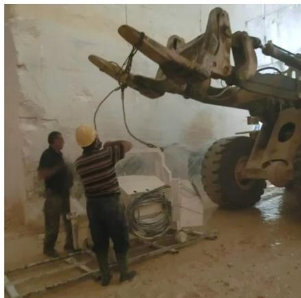
**Figura 5.21** – Colocação da máquina de fio diamantado no carril, com recurso à pá carregadora.
