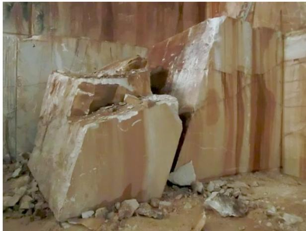
**Figura 7.7** – Parte da bancada desmontada após a ação do *ripper* numa fratura sub-vertical.
