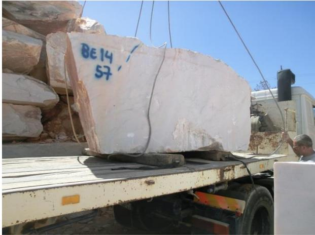
**Figura 5.59** – Carregamento de camião utilizando-se a grua.
