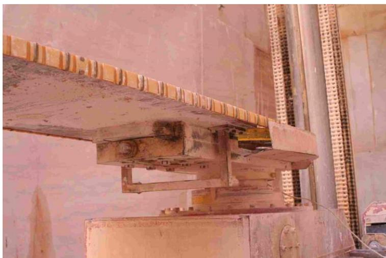
**Figura 4.20** – Pormenor da lança com a cinta diamantada. (Foto: Martins, R.)
