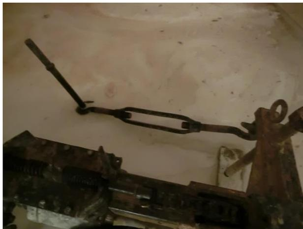
**Figura 5.12** – Pormenor do sistema de fixação da perfuradora.
