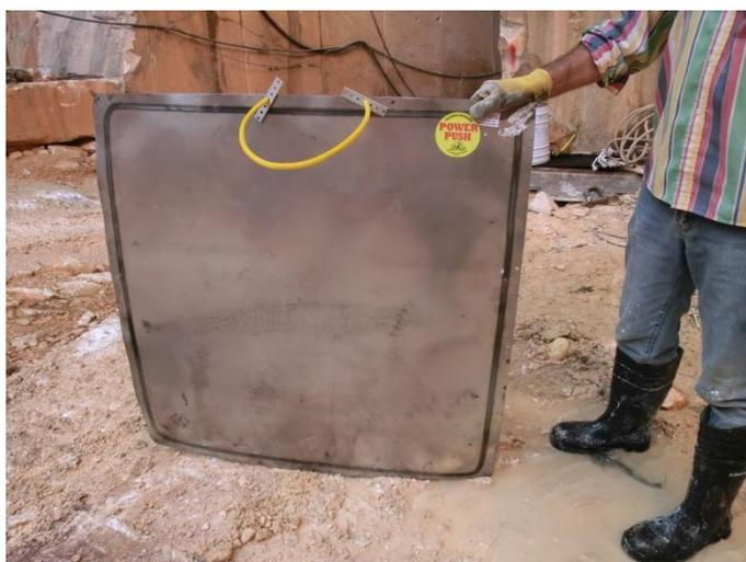
**Figura 4.21** – Colchão hidráulico antes de ser utilizado.
