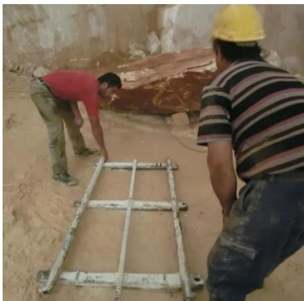
**Figura 5.19** – Colocação do carril no alinhamento da direção de corte.
