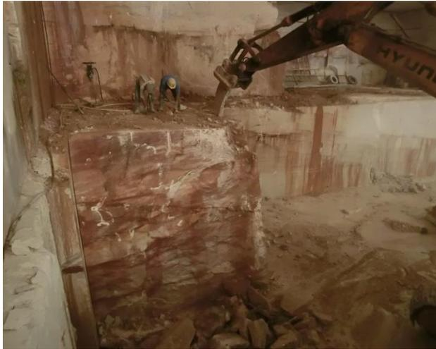
**Figura 5.40** – Atuação do *ripper* numa “pega” junto de uma fratura.
