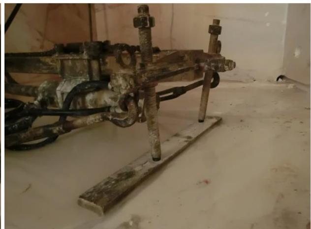
**Figura 5.10** – Tábua de madeira utilizada no nivelamento da perfuradora pneumática.
