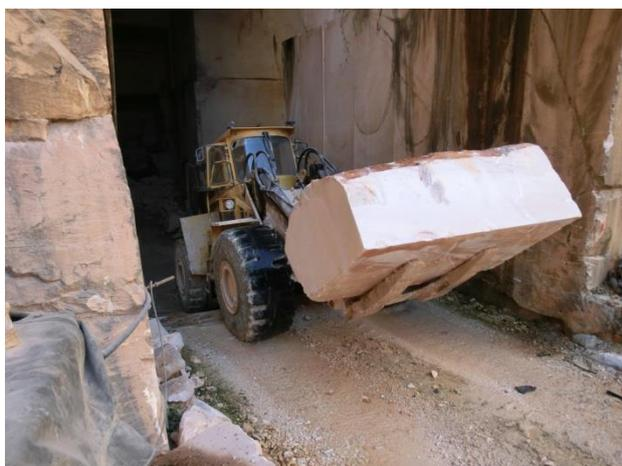
**Figura 5.53** – Transporte pela pá carregadora de um bloco desde o interior da exploração em subterrâneo até uma zona de alcance da grua.
