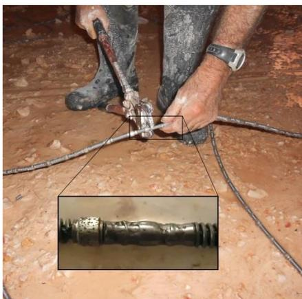
**Figura 5.22** – Prensagem da união metálica.
