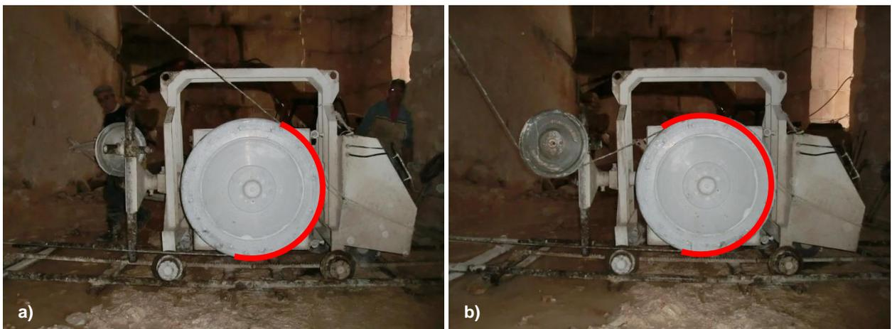
**a)** Sem a poleia direcional montada no suporte da máquina de fio diamantado.
