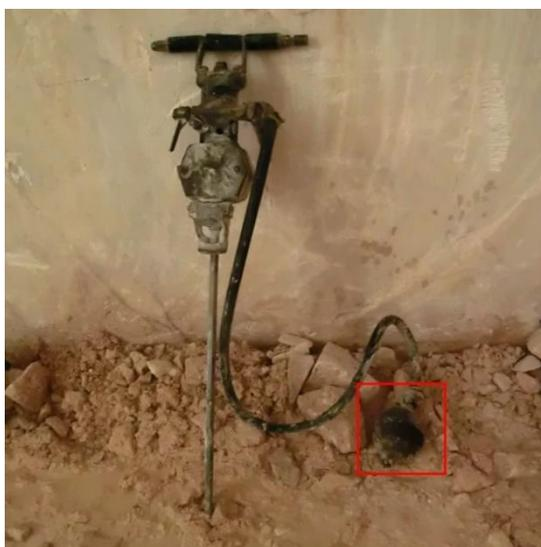
**Figura 4.6** – Martelo pneumático ligeiro com a barrena de 80 cm acoplada. Oleador em destaque.
