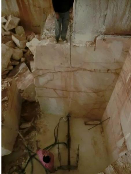
**Figura 5.11** – Ajuste da direção da perfuradora através da observação a partir do topo de bancada.
