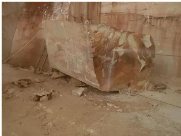
**Figura 5.49** – Esquadrejamento com fio diamantado. De notar a colocação de fragmentos de rocha ao lado do bloco de modo a amortecer a (previsível) queda da fração cortada.
