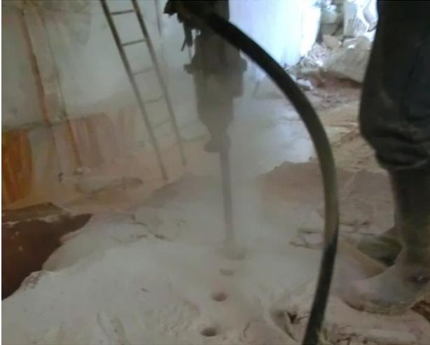
**Figura 5.45** – Realização dos furos da guilhação parcial ao longo de uma fratura (não visível devido ao pó) recorrendo-se ao martelo pneumático ligeiro.
