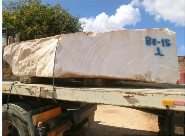
**Figura 5.60** – Bloco colocado sobre barrotes de madeira e envolvido com um cabo de aço.
