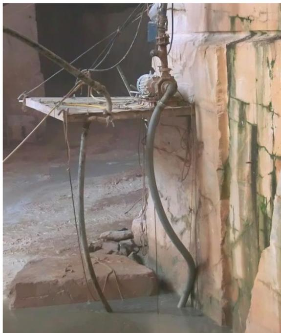
**Figura 4.38** – Plataforma utilizada na colocação das bombas de água acima da bacia de retenção de água.
