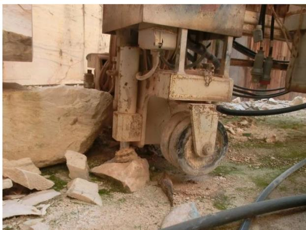
**Figura 5.29** – Pistão hidráulico da roçadora de galeria.
