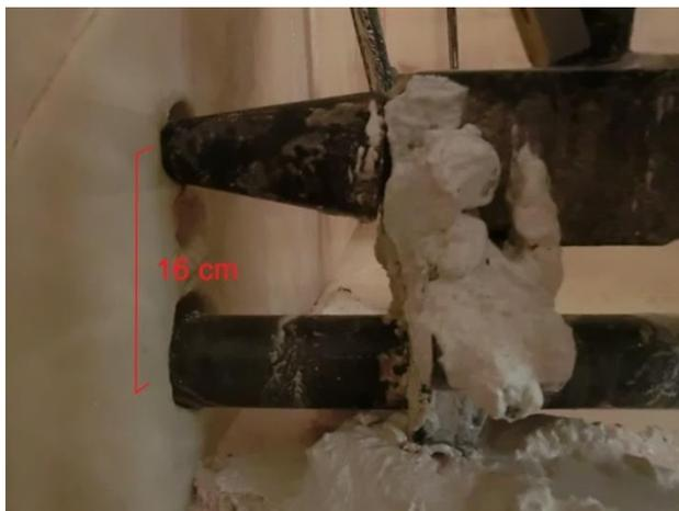
**Figura 5.9** – Distância entre o apoio frontal da perfuradora e o centro do *bit* de perfuração.
