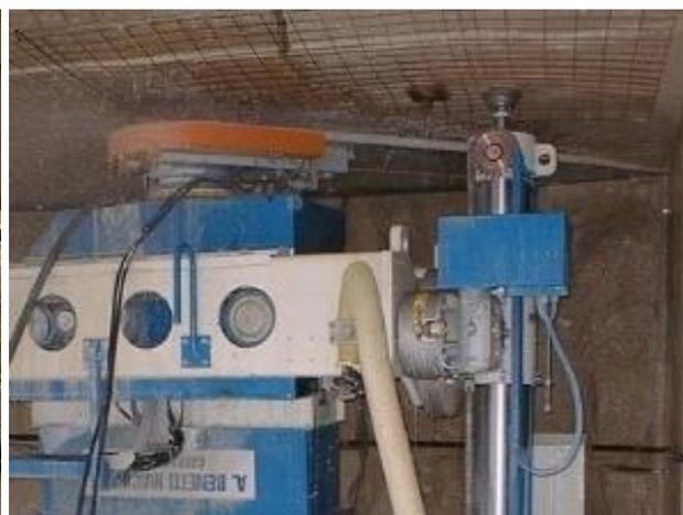
**Figura 5.30** – Fixação ao teto através do extensor telescópico no topo da coluna. (Fonte: Benetti Macchine).
