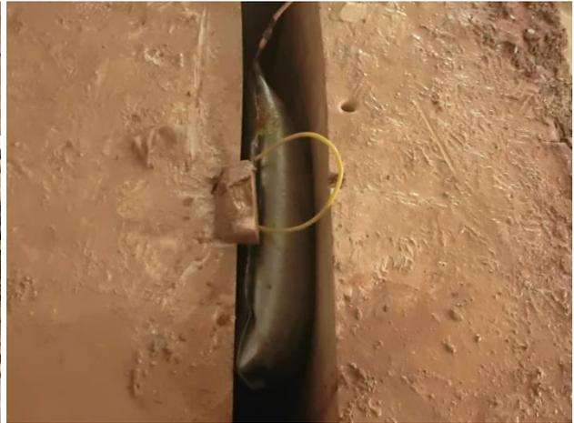
**Figura 4.22** – Compressor hidráulico de alta pressão. **Figura 4.23** – Colchão hidráulico após o processo de enchimento.
