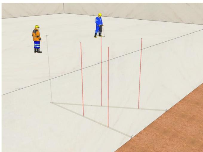
**Figura 6.21** – Representação 3D da execução dos furos verticais das talhadas.
