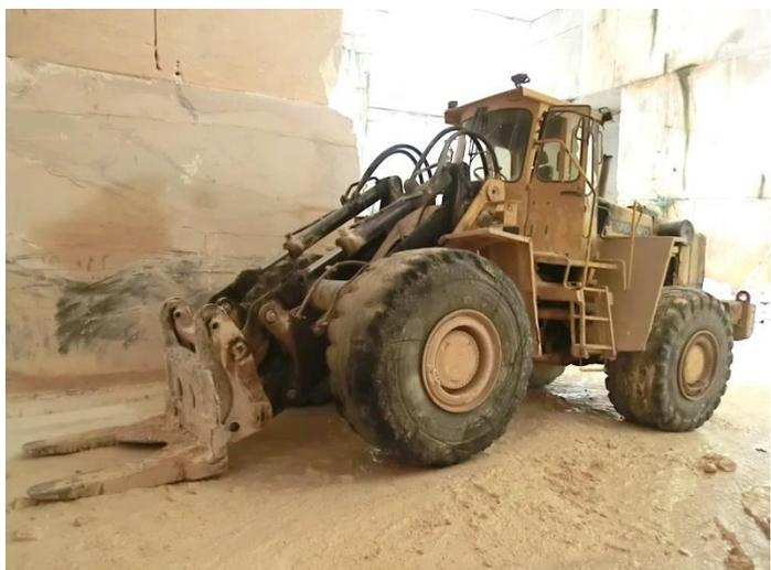
**Figura 4.26** – Pá carregadora com as patolas acopladas.
