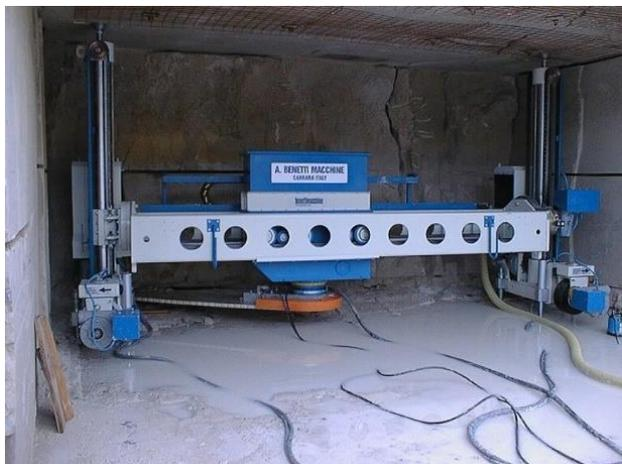
**Figura 5.31** – Posicionamento da lança da roçadora abaixo do motor. (Fonte: Benetti Macchine).
