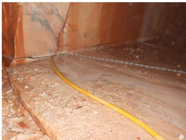
**Figura 5.25** – Aresta partida no local de passagem do fio diamantado. **Figura 5.26** – Mangueira direcionada para o local de corte.
