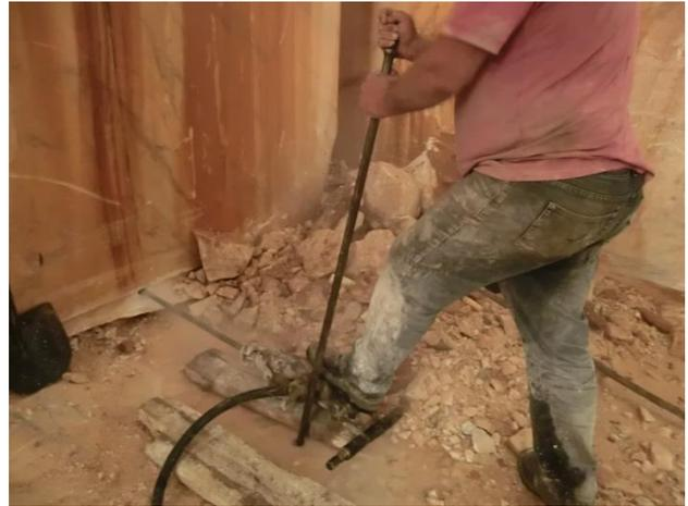
**Figura 5.51** – Perfuração horizontal com martelo pneumático ligeiro. Recurso à barra de ferro como alavanca forçando o avanço deste ao longo do furo.
