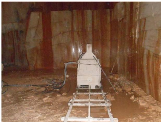
**Figura 7.4** – Posicionamento da máquina de fio diamantado para proceder à realização do corte horizontal.
