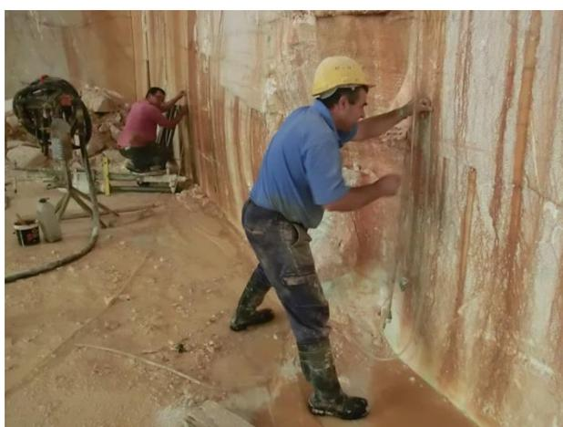
**Figura 5.7** – Realização da marcação do 2º furo horizontal através da utilização da mangueira de nível.
