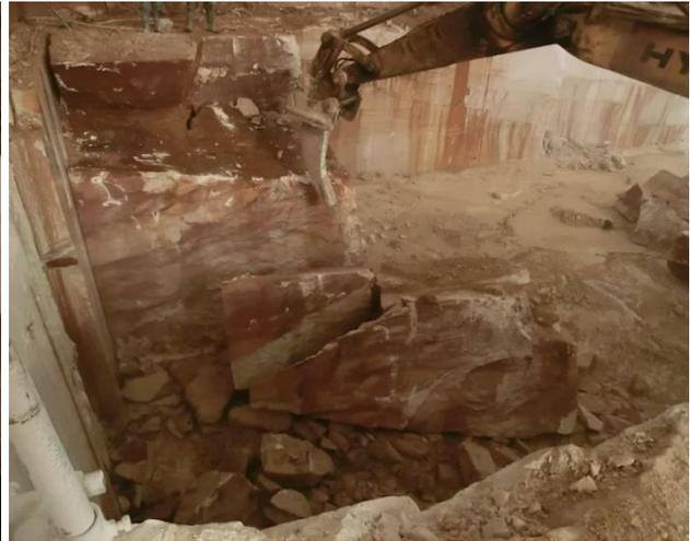
**Figura 5.41** – Massa rochosa tombada sobre a “cama” após ser derrubada.
