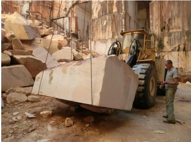
**Figura 5.55** – Envolvimento de um bloco com os cabos de aço diretamente das patolas da pá carregadora.
