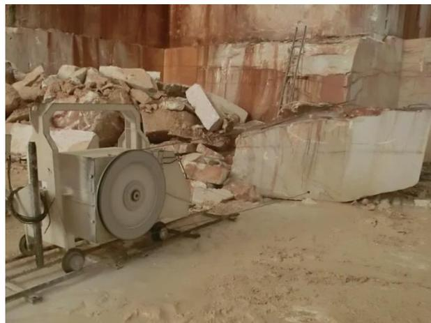
**Figura 5.52** – Realização do corte de esquadrejamento após a execução do furo horizontal com martelo pneumático.
