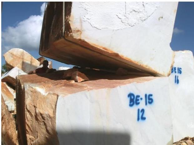
**Figura 5.57** – Colocação de fragmentos rochosos sob o bloco, possibilitando a remoção dos cabos de aço.
