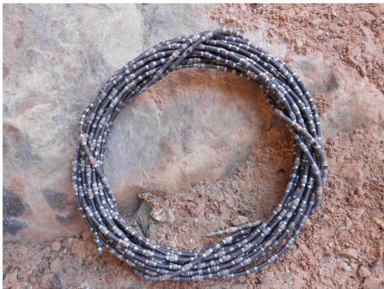
**Figura 4.16** – Fio diamantado.
