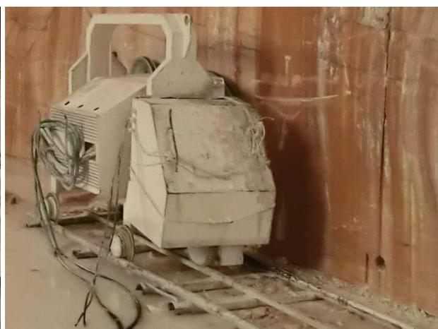
**Figura 4.14** – Pormenor da roda dentada que promove a deslocação da máquina sobre o carril.
