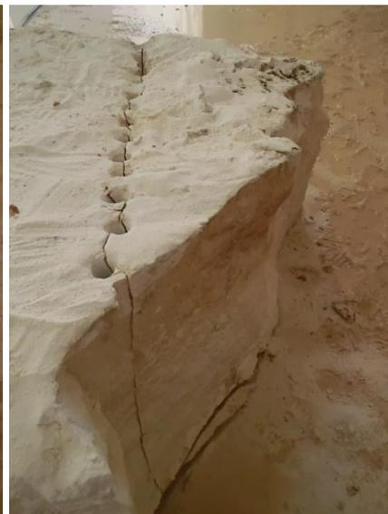
**Figura 5.48** – Abertura da rocha ao longo do plano de fraqueza criado pela guilhação.
