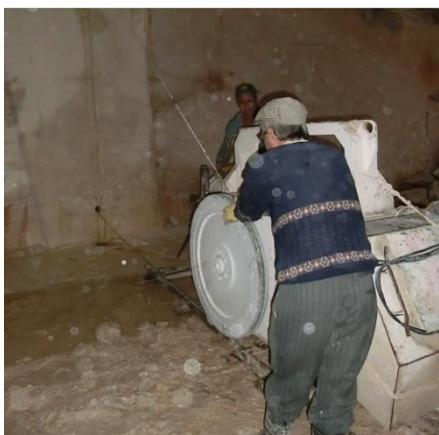
**Figura 5.23** – Verificação do alinhamento do conjunto fio diamantado – poleia motriz – carril.
