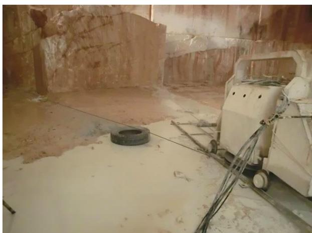
**Figura 4.13** – Execução de um corte horizontal.
