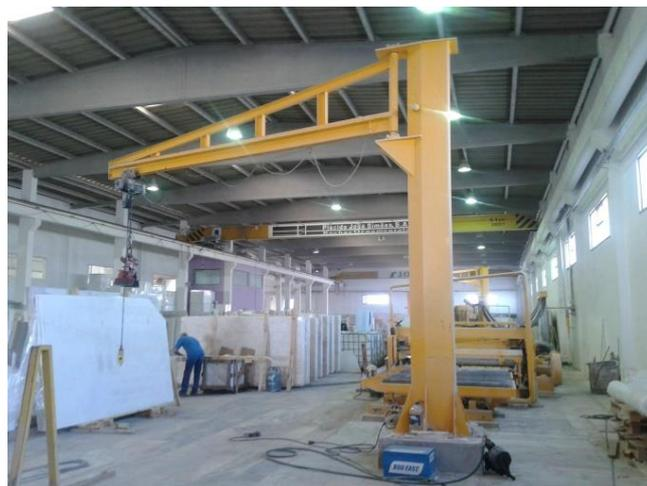
Figura 5.76 – Grua tipo bandeira posicionada a jusante da linha de polimento de chapa.
