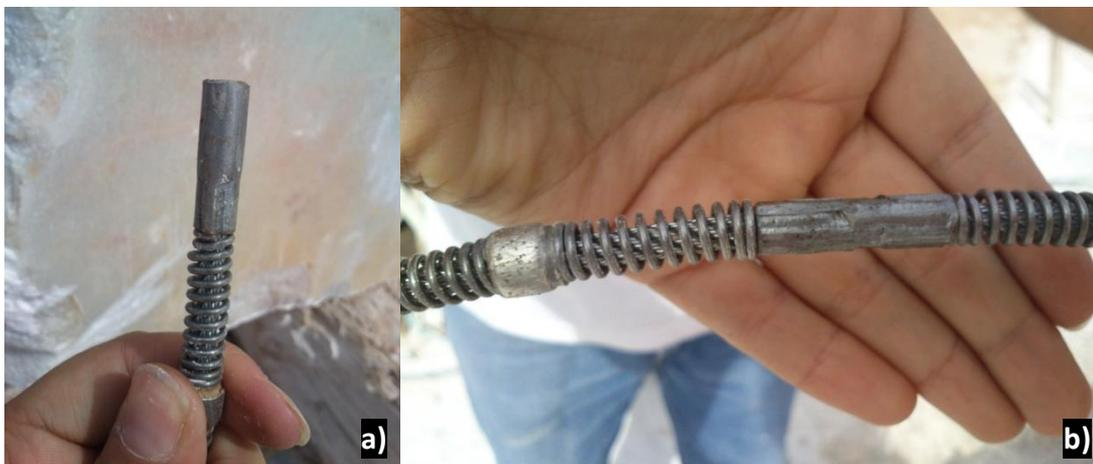
Figura 4.21 – a) Fio diamantado prensado numa das pontas; b) Fio diamantado prensado em ambas as pontas.
