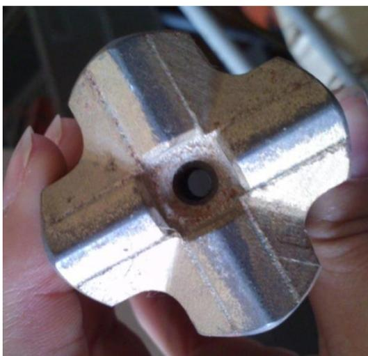
**Figura 4.6 – Frente do bit em cruz, evidenciando-se as pastilhas de carboneto de tungstênio.**
