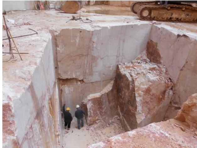
Figura 4.75 – Aspeto do alargamento do abaixamento de piso após retirada a maior parte da massa rochosa.
