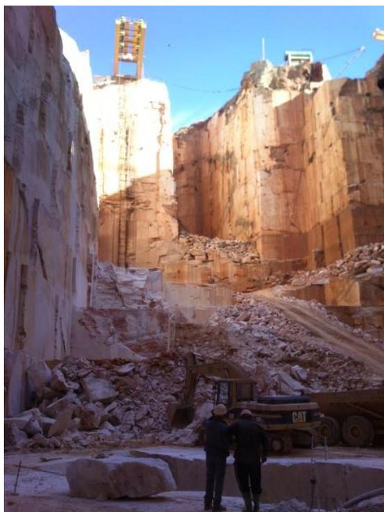
**Figura 4.89 – Limpeza e remoção do escombro.**
