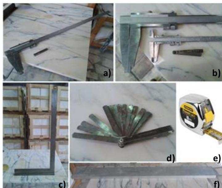
Figura 6.1 – a) Paquímetro 600 mm; b) Paquímetro 600 e 150 mm; c) Esquadro de braços com comprimento  $\geq 100$  mm; d) Conjunto de calços finos; e) Fita métrica; f) Régua metálica de secção retangular.
