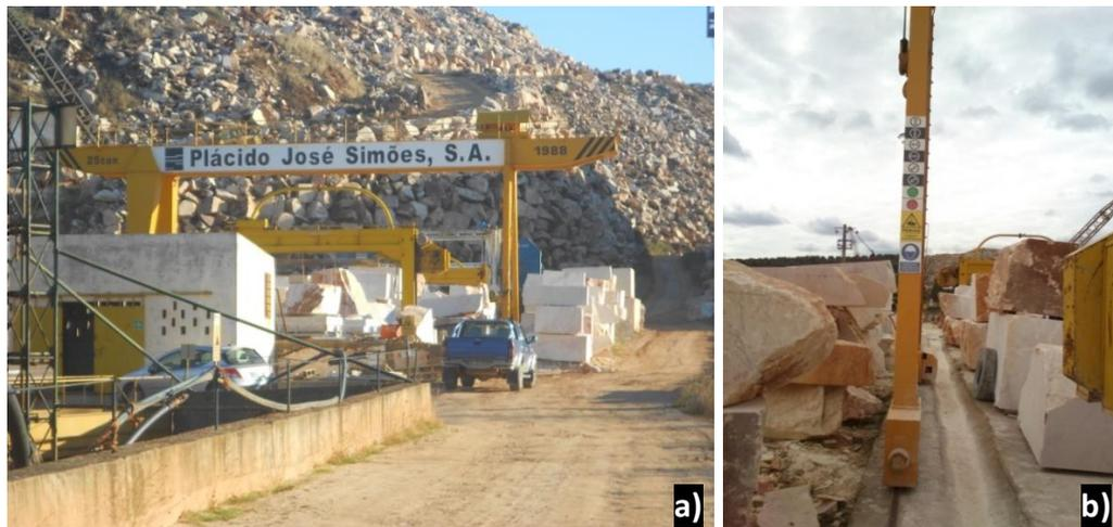
Figura 4.54 – a) Pórtico; b) Pormenor de uma das colunas do pórtico assente no carril.
