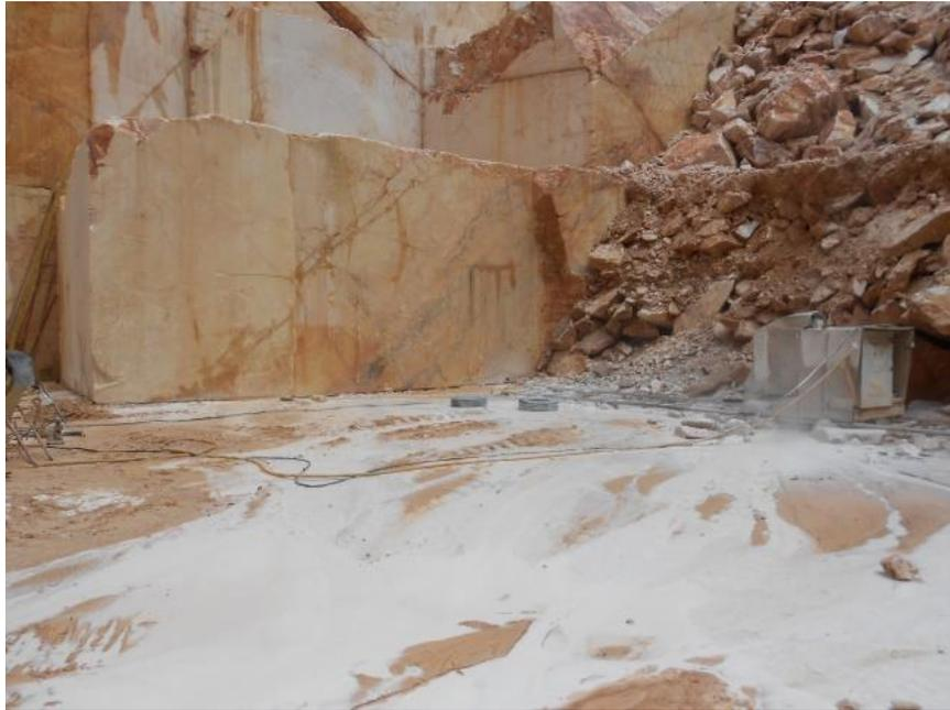
Figura 4.83 – Corte de levante.
