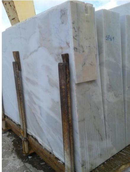
Figura 5.87 - Chapas serradas e pormenor de ladrilho colado no local do partido.
