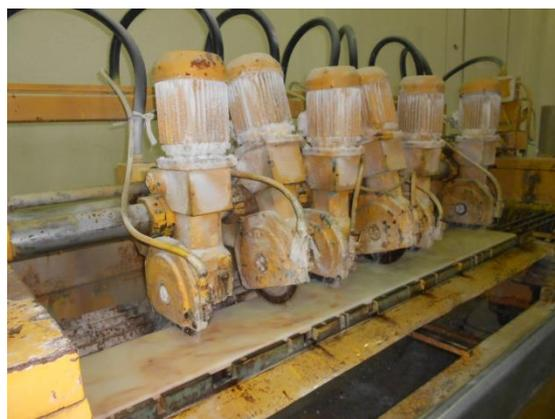
**Figura 5.53 – Plataforma com banda e cabeças de corte na posição de corte.**
