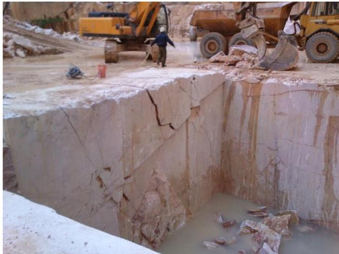
Figura 4.31 – Afastamento da massa rochosa e abertura das fraturas através do colchão hidráulico em enchimento.
