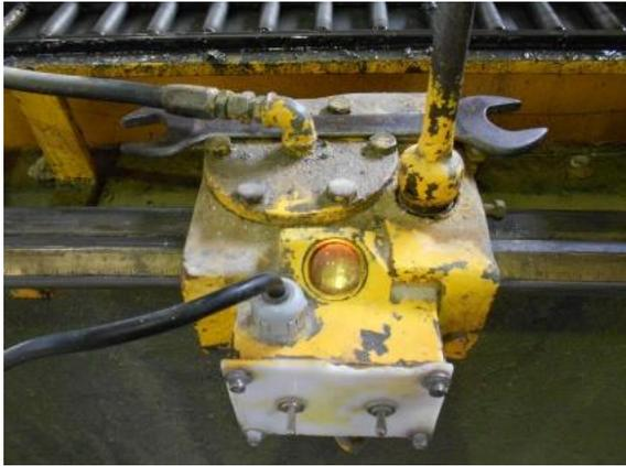
Figura 5.44 – Lupa de observação do valor indicado pela régua.
