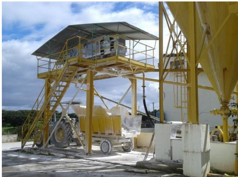
**Figura 5.103 – Filtro prensa e atrelado para recepção das “natas”.**
