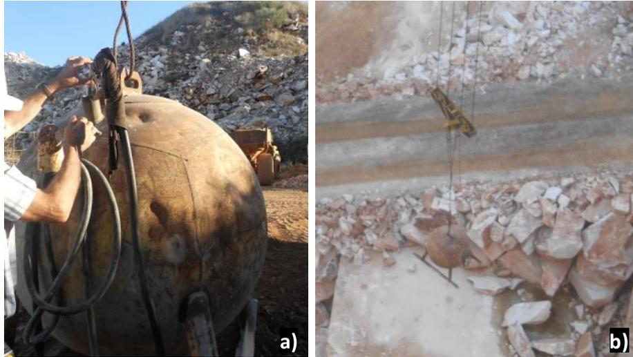
**Figura 4.58 – a) Reservatório; b) Reservatório a ser içado pela grua do interior da pedreira com o auxílio de cabos de aço.**
