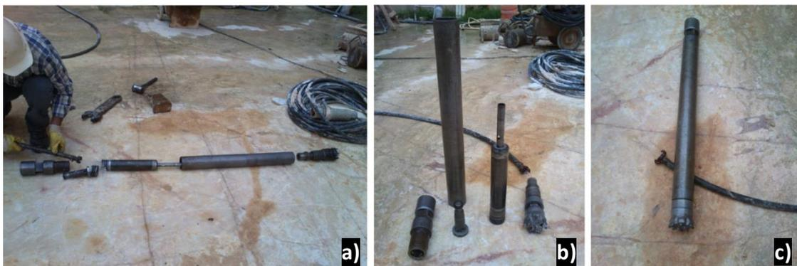
Figura 4.12 a) e b) Componentes do tubo extensor da perfuradora pneumática com o bit de 90 mm; c) Tubo extensor com bit de 90 mm acoplado.
