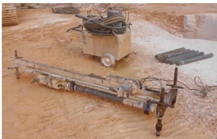
Figura 4.10 – Perfuradora pneumática, central hidráulica e tubos extensores.
