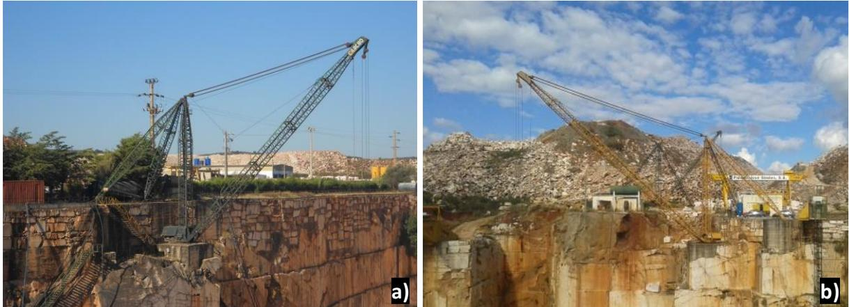
Figura 4.45 - Guas da pedreira Carrascal JS: a) grua adaptada; b) grua de construção tradicional.
