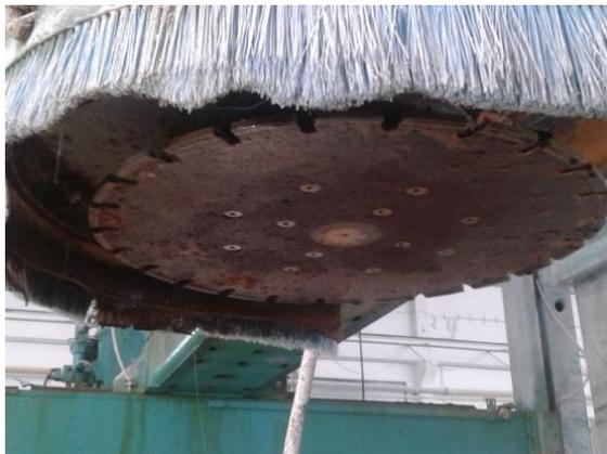
Figura 5.20 – Disco de corte horizontal.
