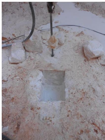
Figura 4.78 – Caixa para posterior introdução de um piston hidráulico.
