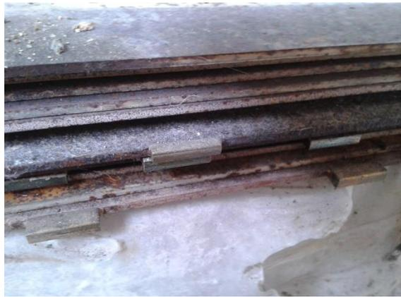
Figura 5.7 – Segmentos diamantados das lâminas de corte.
