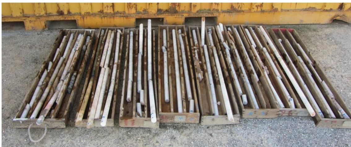
Figura 4.107 – Caixas de amostragem com tarolos resultantes da sondagem efetuada.
