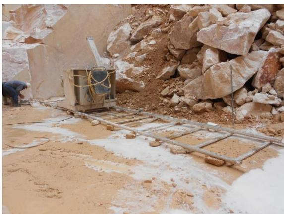
**Figura 4.88 – Montagem da máquina de fio diamantado para realização do corte vertical.**
