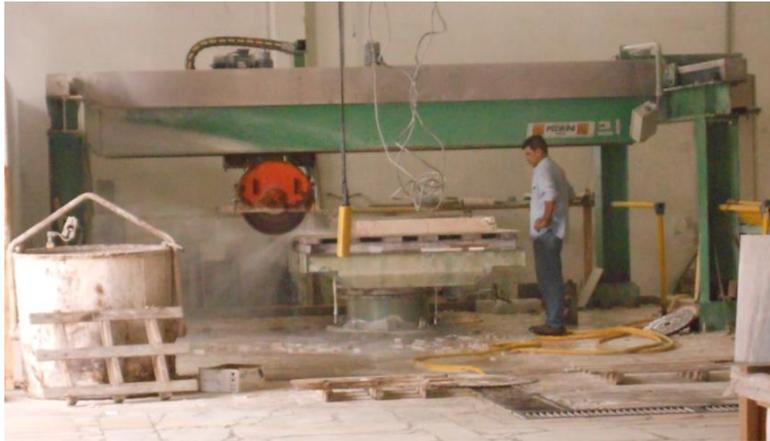
Figura 5.47 – Máquina de corte tipo ponte Pedrini.
