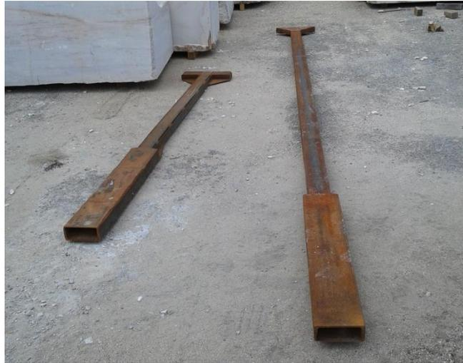
Figura 5.80 – Extensores das patolas dos empilhadores.
