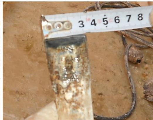
Figura 4.5 – Barrena com ponta em bisel acoplada, utilizada para furos de 30 mm.
