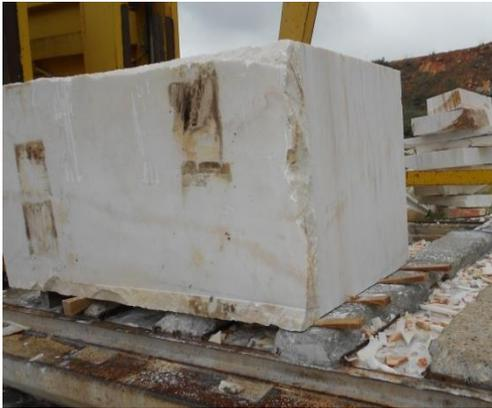
Figura 5.18 – Bloco preparado para o corte.
