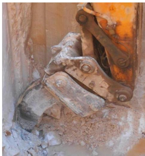
Figura 4.38 - Braço da escavadora de rastos equipada com o ripper.
