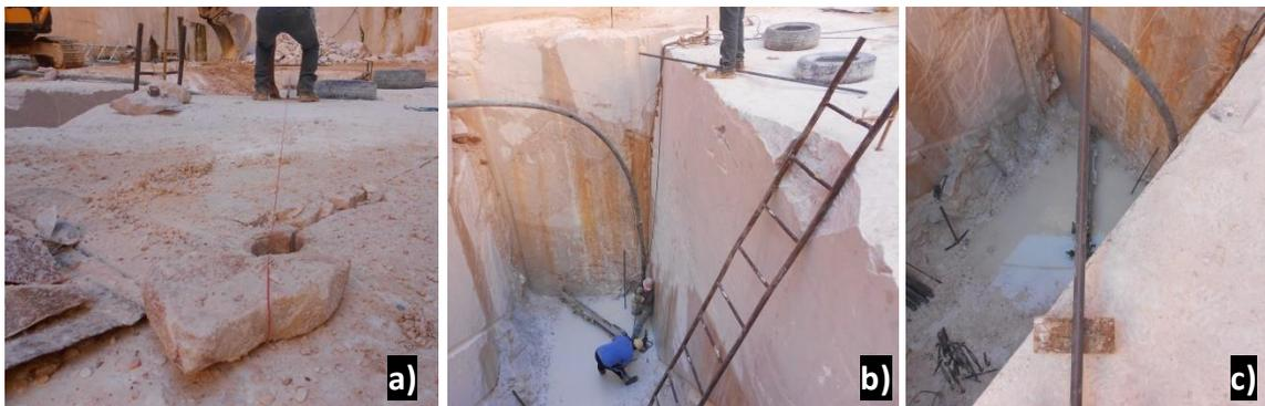
**Figura 4.72 – Técnica do desempenho: a) fio-de-prumo esticado a partir do furo vertical na diagonal da caixa; b) fio-de-prumo com pendulo a indicar o local de perfuração e montagem da perfuradora pneumática; c) alinhamento da perfuradora pneumática com a barrena posicionada na mesma direção do fio-de-prumo.**
