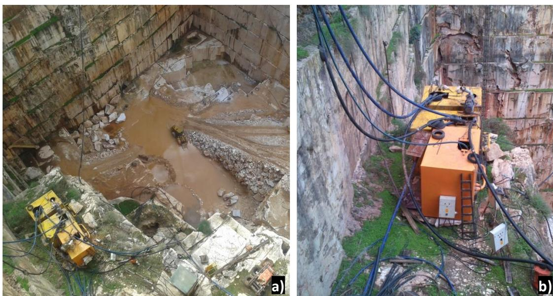
Figura 4.132 – Depósitos situados a 36 metros da superfície: a) tanques de decantação e bacias de retenção; b) tanques de decantação.
