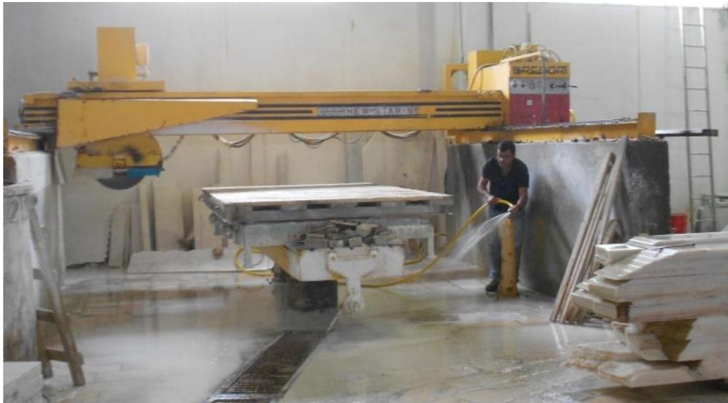
Figura 5.38 – Máquina de corte tipo ponte Gregori - New Star.
