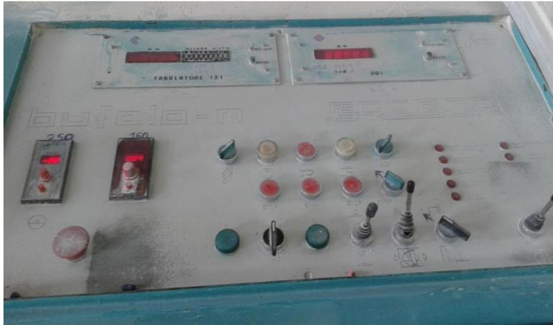
Figura 5.31 – Painel de controlo do talha-blocos Gregori.
