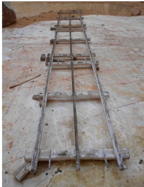
Figura 4.18 – Carris da máquina de fio diamantado.
