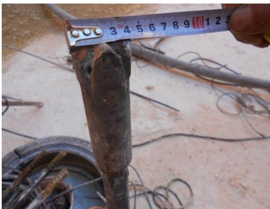
Figura 4.4 – Barrena com ponta em cruz acoplada, utilizada para furos de 40 mm.
