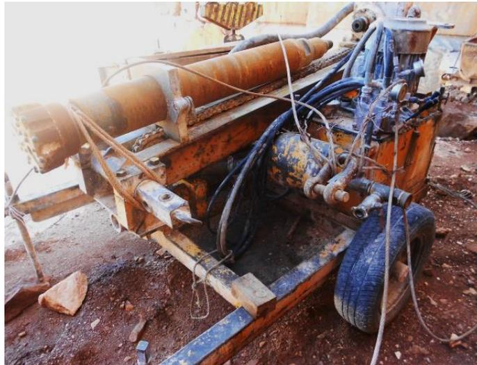
**Figura 4.8 – Perfuradora Jumbo, com destaque do local onde são acoplados os tubos de extensão.**
