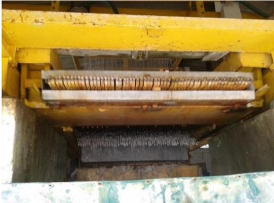
Figura 5.12- Realização do corte de um bloco.
