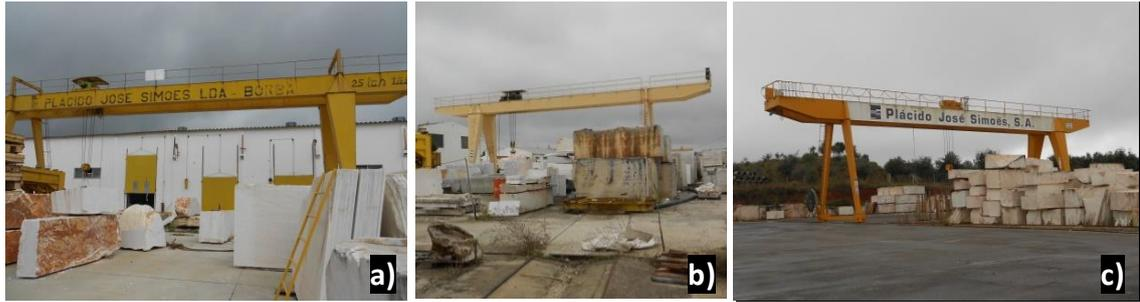
Figura 5.72 – Pórticos da unidade de transformação: a) pórtico do parque de blocos destinados aos talha-blocos; b) pórtico do parque de blocos destinados aos engenhos multilâminas; c) pórtico do parque de blocos principal com blocos destinado a venda ou sem destino definido.
