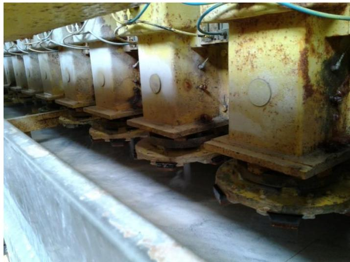
Figura 5.92 – Cabeças de polimento da polidora de ladrilho.
