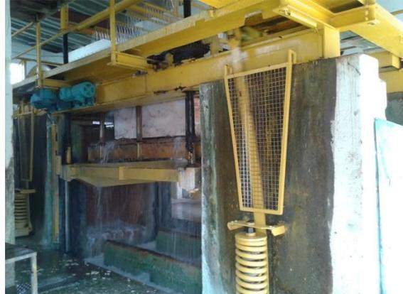
Figura 5.10 – Mola amortecedora do movimento de corte.
