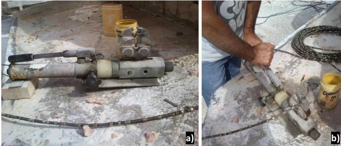
Figura 4.20 – a) Prensador hidráulico (Poeiras) utilizado à superfície; b) Operário a prensar o fio diamantado.
