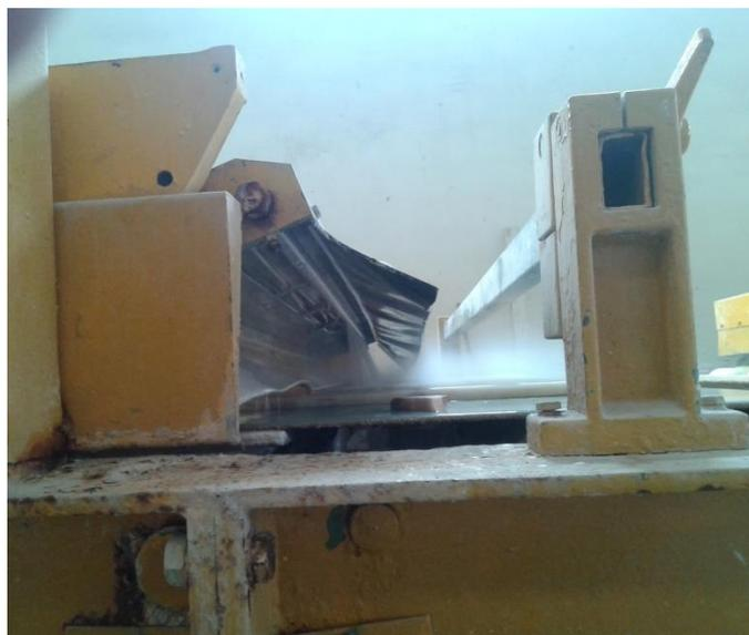
Figura 5.61 – Jato de água do equipamento de limpeza.
