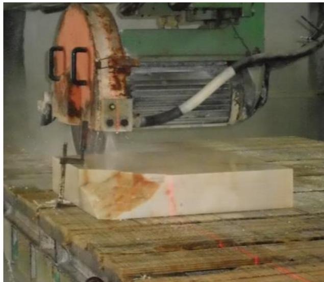
Figura 5.49- Realização do corte segundo a linha projetada pelo laser guia.
