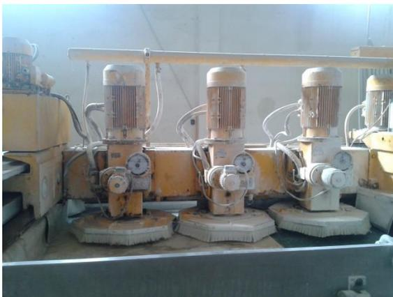
Figura 5.57 – Cabeças diamantadas de retificação de espessura.
