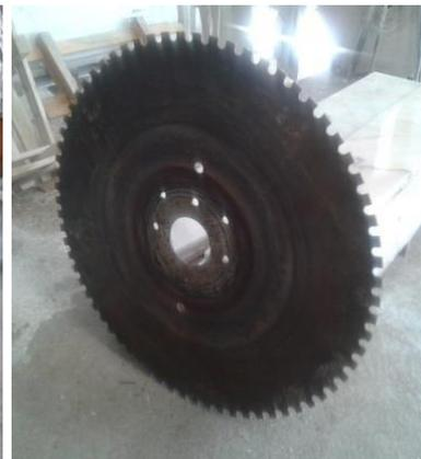
Figura 5.21 – Disco de corte vertical.
