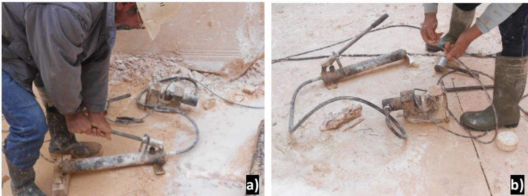
Figura 4.19 a) e b) – Prensador hidráulico (Poeiras) utilizado no interior da pedreira.
