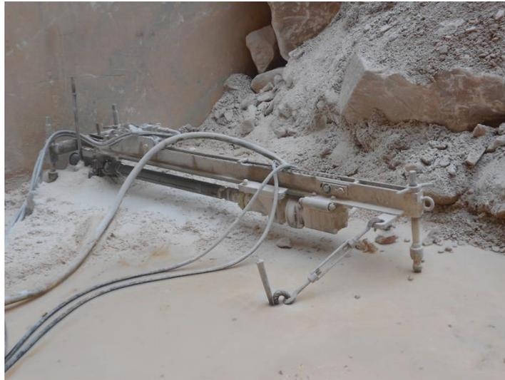
Figura 4.79 – Realização de um dos furos horizontais com a perfuradora pneumática roto-percussiva.
