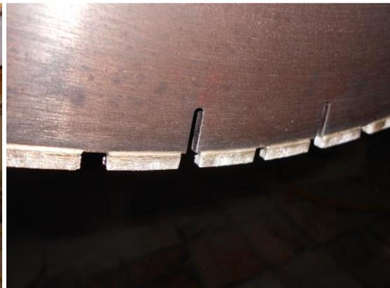
Figura 5.37 – Segmentos diamantados do disco de corte.
