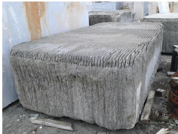
Figura 5.8 – Bloco de cimento destinado a avivar o diamante das lâminas.
