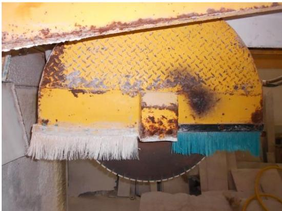
Figura 5.36 - Disco de corte da máquina tipo ponte.
