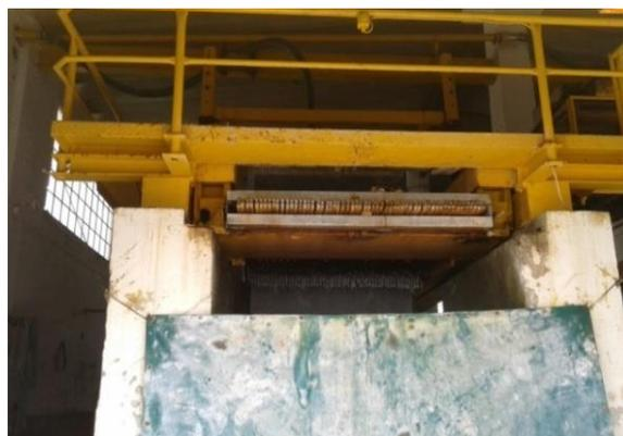
Figura 5.5 – Engenho multilâminas.
