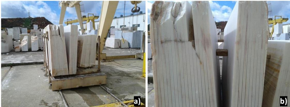
Figura 5.16 – a) Chapas retiradas do engenho. b) Pormenor dos tacos de madeira a separar conjuntos de chapas.
