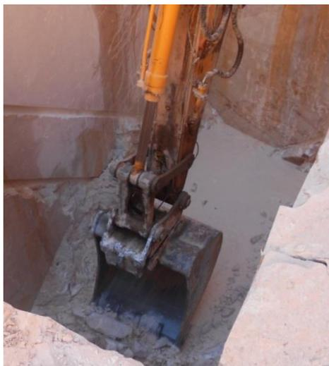
Figura 4.37 - Braço da escavadora de rastos equipada com o balde.
