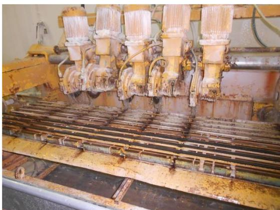
**Figura 5.52 – Plataforma e cabeças de corte na posição inicial.**
