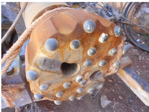
Figura 4.9 – Bit de 220 mm com botões de carboneto de tungstênio.
