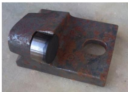
Figura 4.15 – Elemento da correia com pastilha de carboneto de tungstênio.
