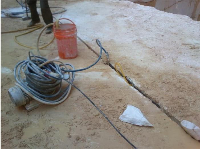
Figura 4.29 – Centralina e colchão colocado no corte.
