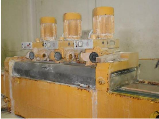
Figura 5.64 – Três das seis cabeças diamantadas.
