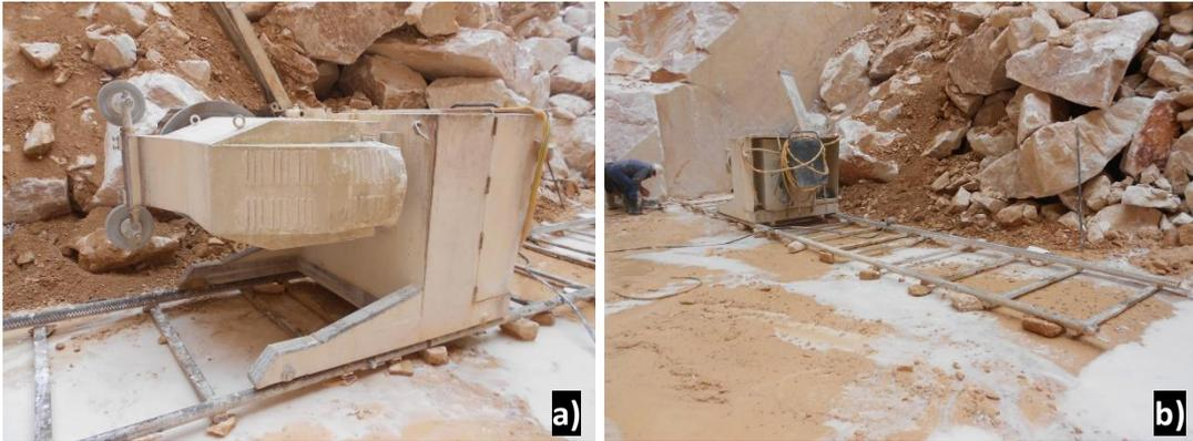
Figura 4.17 a) e b) – Máquina de fio diamantado de 40 cv.
