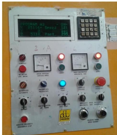
Figura 5.29 – Painel de controle do talha-blocos Pedrini.
