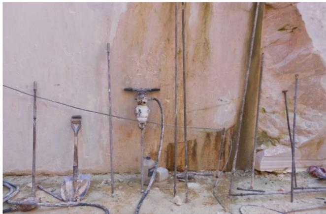
Figura 4.3 – Martelo pneumático ligeiro e conjunto de barrenas de diferentes dimensões.
