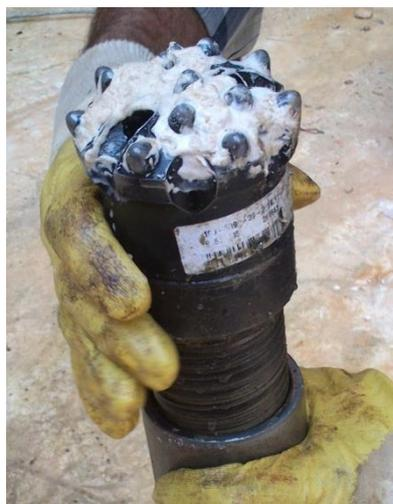
Figura 4.13 – Bit de 90 mm.
