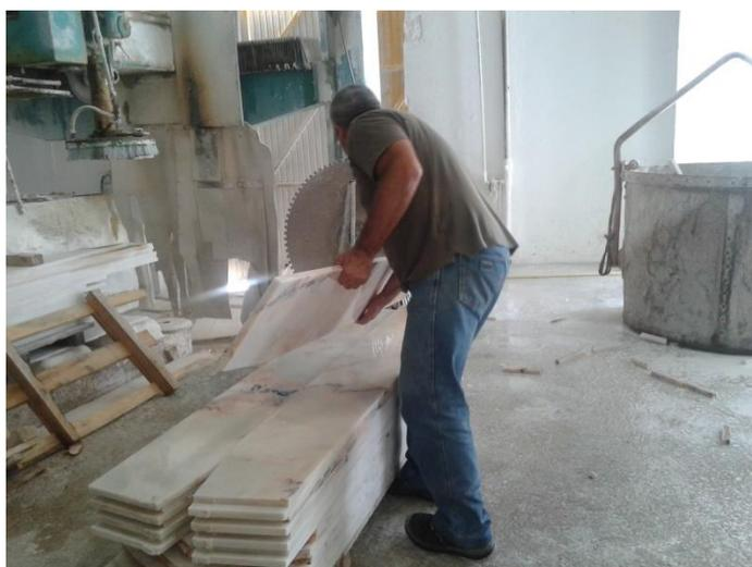
**Figura 5.27 – Colocação da banda no lote de bandas.**
