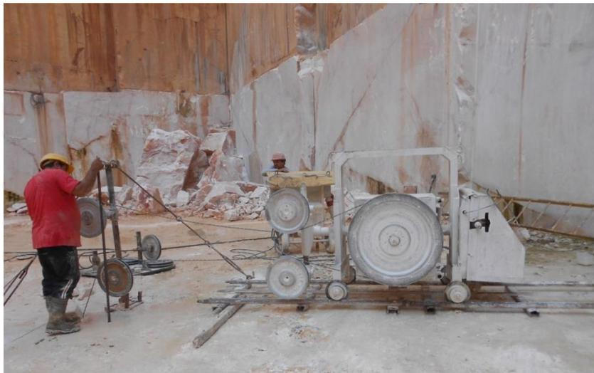
Figura 4.16 – Máquina de fio diamantado de 20 cv.
