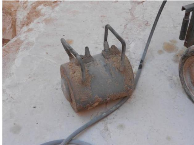
**Figura 4.32 – Piston hidráulico.**
