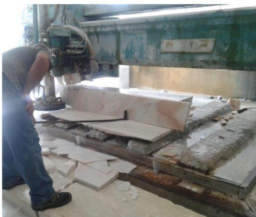
**Figura 5.25 – Operário sustem a banda com ferro auxiliar.**
