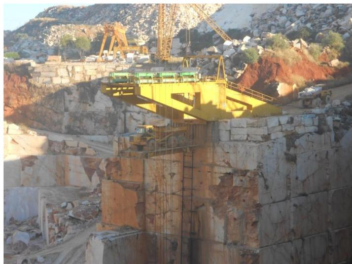
Figura 4.41 – Elevador de máquinas com um dumper a descer para a cavidade enquanto outro se dirige para a escombreira.
