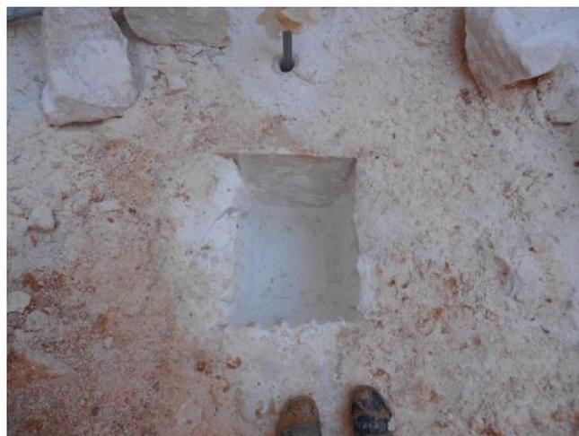
**Figura 4.33 – Caixa para introdução de um piston hidráulico.**
