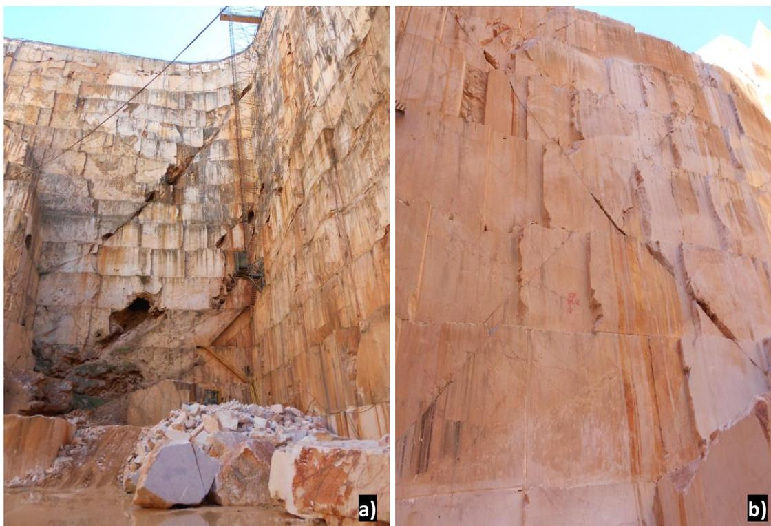
Figura 3.14 – Falha normal que afeta a pedra Carrasca JS. – a) Talude SE; b) Talude NW.
