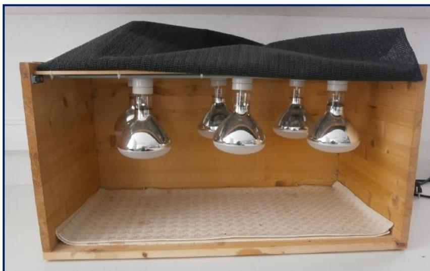
**Figura 3.23: Câmara de radiação ultra-violeta (UV) presente no Laboratório de Biogeoquímica Ambiental da Universidade de Évora.**
