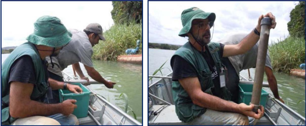
Figura 3.18: Utilização de um *corer* de varas *Kajak* para a amostragem de coluna de materiais sedimentares.
