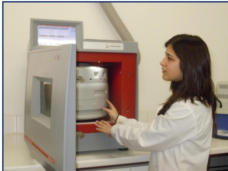
**Figura 3.21: Digestor microondas de alta pressão do Laboratório de Biogeoquímica Ambiental da Universidade de Évora.**
