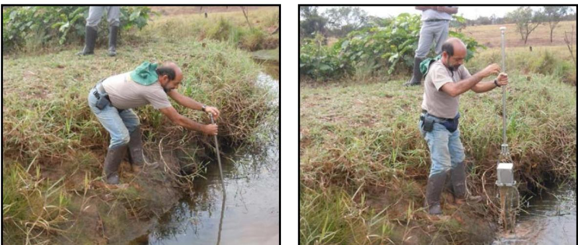
Figura 3.17: Utilização de uma draga manual do tipo *Shipeck* (com vara) na amostragem de sedimentos.
