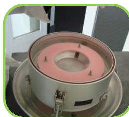
Figura 5: Filtro XL colocado numa das campânulas que constitui o colector
