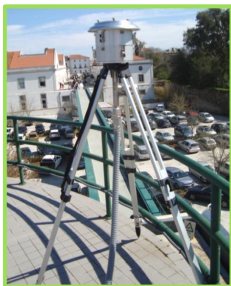
Figura 4 Colector de partículas, Chemvol Sampler localizado na plataforma meteorológica situada na Escola de Ciências e Tecnologia da Universidade de Évora, a 17m do solo
