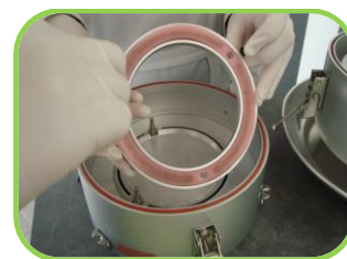
Figura 6: Filtro M colocado numa das campânulas que constitui o colector
