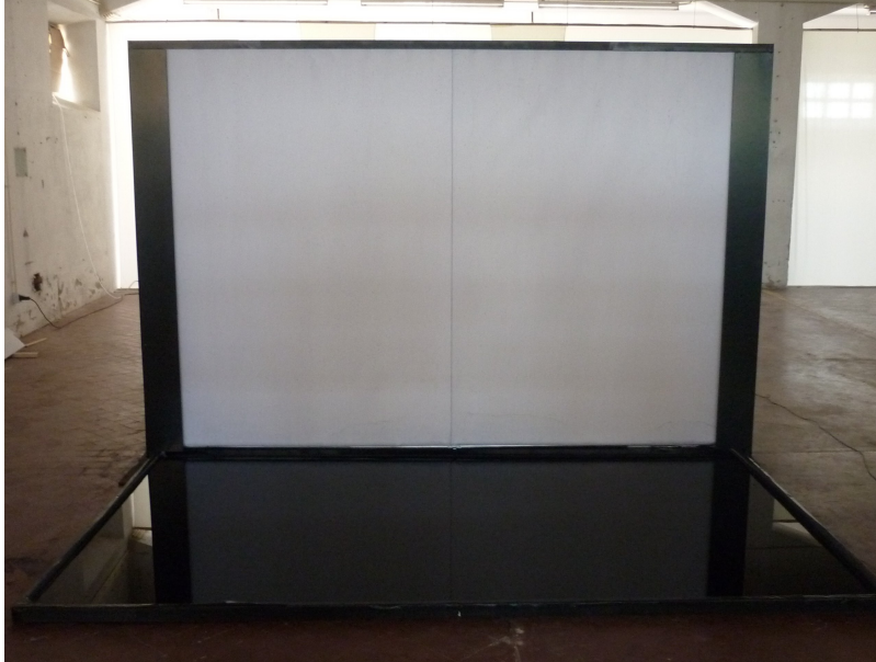
Fig.2 - Estrutura metálica e tanque em pvc impermeabilizado. O tanque contém água colorida com corante alimentar.
