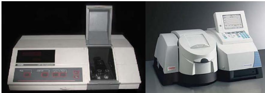
**Figura 4** - Espectrofotómetro de UV/Vis, respetivamente de feixe simples e de feixe duplo.
