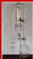
Fig.2 – Destilação com o aparelho Clevenger
