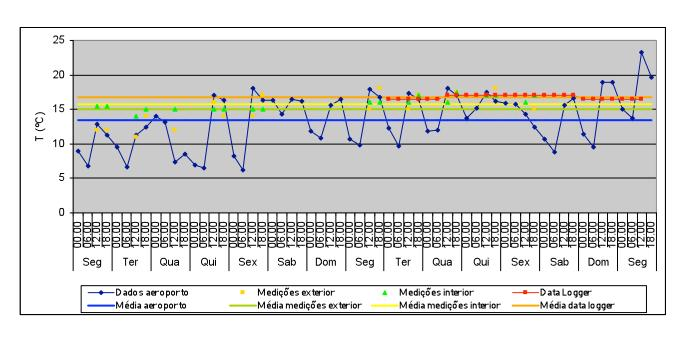
T média no exterior: 13,5°C Valor máximo: 23,2°C Valor mínimo: 6,2°C T média no exterior (medições): 15,1°C Valor máximo: 18°C Valor mínimo: 11°C T média no interior (medições): 15,8°C Valor máximo: 17,5°C Valor mínimo: 14°C
