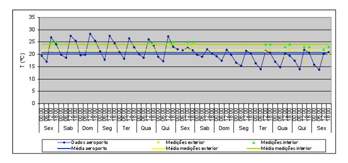
T média no exterior: 20,6°C Valor máximo: 28,3°C Valor mínimo: 13,7°C T média no exterior (medições): 21,8°C Valor máximo: 25°C
