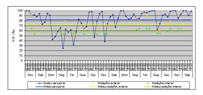
H.R. média no exterior: 81,8% Valor máximo: 100% Valor mínimo: 25% H.R. média no exterior (medições): 71,7% Valor máximo: 90% Valor mínimo: 46% H.R. média no interior (medições):57,8% Valor máximo: 65% Valor mínimo: 51%
