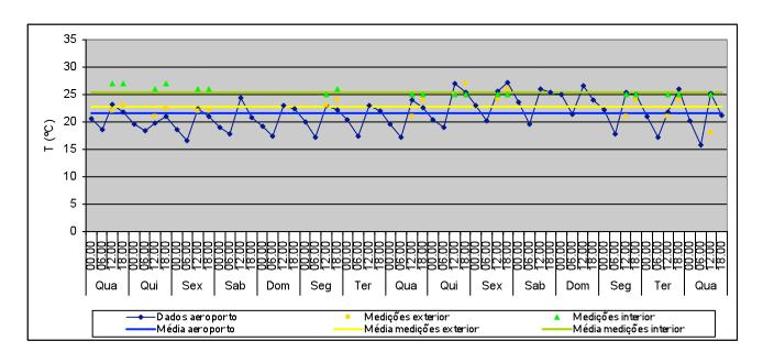
T média no exterior: 21,6°C Valor máximo: 27,2°C Valor mínimo: 15,8°C T média no exterior (medições): 22,9°C Valor máximo: 27°C
