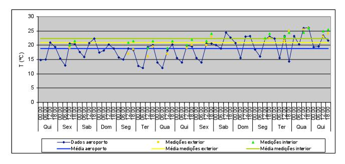
T média no exterior: 18,8°C Valor máximo: 24,5°C Valor mínimo: 12,1°C T média no exterior (medições): 21°C Valor máximo: 26°C
