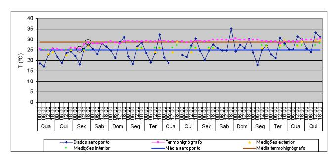
T média no exterior: 24,9°C Valor máximo: 35,2°C Valor mínimo: 17,1°C T média no interior (termohigrógrafo): 28,6°C Valor máximo: 30,5°C Valor mínimo: 25°C Variação máxima diária: 3,5°C
