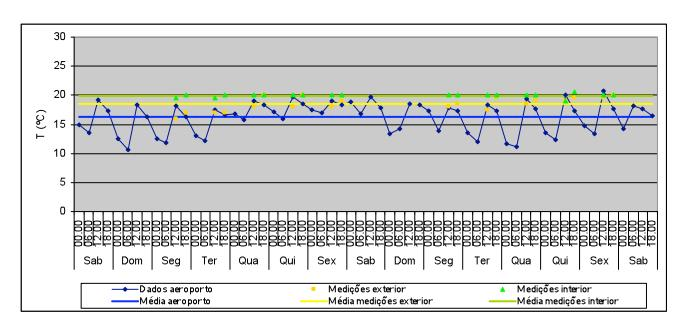
T média no exterior: 16,3°C Valor máximo: 20,7°C Valor mínimo: 10,6°C T média no exterior (medições): 18,5°C Valor máximo: 20°C
