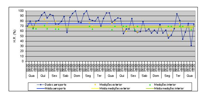
H.R. média no exterior: 74,7% Valor máximo: 100% Valor mínimo: 31% H.R. média no exterior (medições): 69,4% Valor máximo: 83% Valor mínimo: 52% H.R. média no interior (medições): 67,2% Valor máximo: 71%
