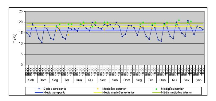
T média no exterior: 16,3°C Valor máximo: 20,7°C Valor mínimo: 10,6°C T média no exterior (medições): 18°C Valor máximo: 19,5°C Valor mínimo: 14°C
