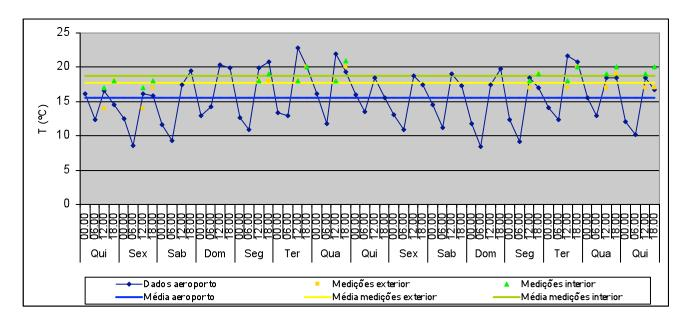
T média no exterior: 15,5°C Valor máximo: 22,8°C Valor mínimo: 8,6°C T média no exterior (medições): 17,7°C
