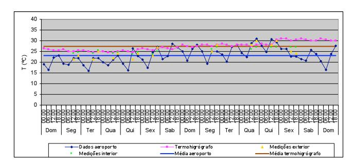
T média no exterior: 23,1°C Valor máximo: 30,9°C Valor mínimo: 16°C T média no interior (termohigrógrafo): 27,4°C Valor máximo: 31°C Valor mínimo: 24,5°C Variação máxima diária: 2,5°C
