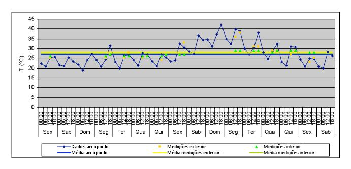
T média no exterior: 27°C Valor máximo: 42,1°C Valor mínimo: 19°C T média no exterior (medições): 28,1°C Valor máximo: 38°C
