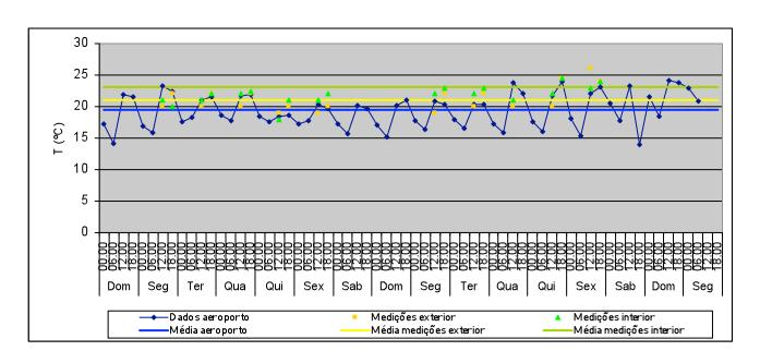
T média no exterior: 19,4°C Valor máximo: 24,2°C Valor mínimo: 13,9°C T média no exterior (medições): 21,1°C Valor máximo: 26°C
