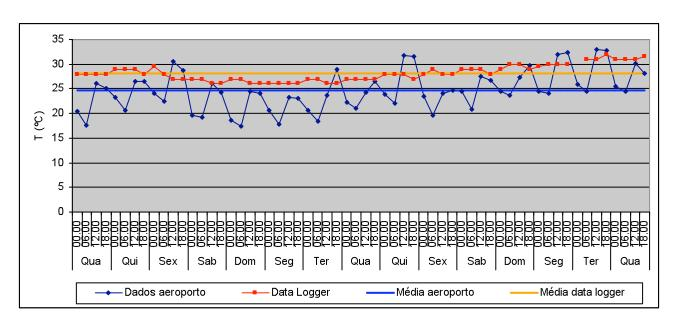
T média no exterior: 24,7°C Valor máximo: 32,9°C Valor mínimo: 17,3°C T média no interior (data logger): 28,2°C Valor máximo: 32°C Valor mínimo: 26°C Variação máxima diária: 2°C
