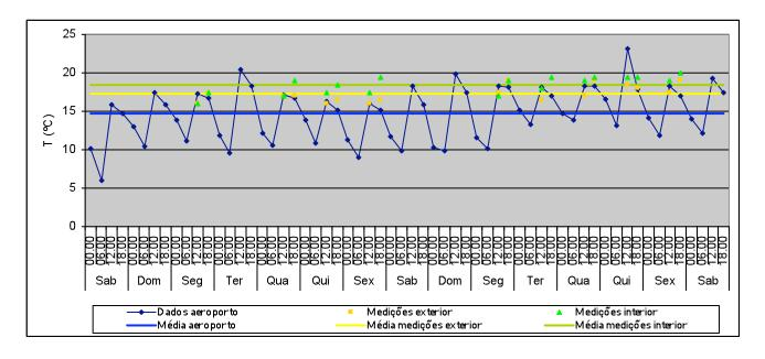
T média no exterior: 14,7°C Valor máximo: 23,1°C Valor mínimo: 6°C T média no exterior (medições): 17,3°°C Valor máximo: 19°C°C
