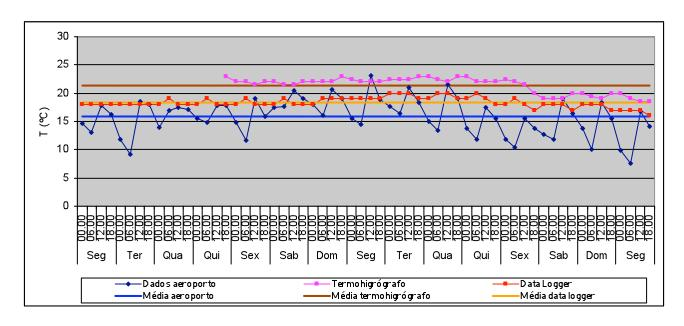
T média no exterior: 15,9°C Valor máximo: 23,1°C Valor mínimo: 7,6°C T média no interior (data logger): 18,4°C Valor máximo: 20°C Valor mínimo: 16°C Variação máxima diária: 2°C
