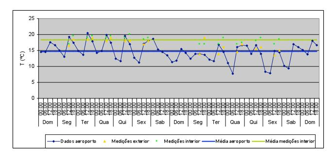
T média no exterior: 14,7°C Valor máximo: 20,5°C Valor mínimo: 7,8°C T média no interior (medições): 18,4°C Valor máximo: 20°C Valor mínimo: 17°C Variação máxima diária: 2,5°C
