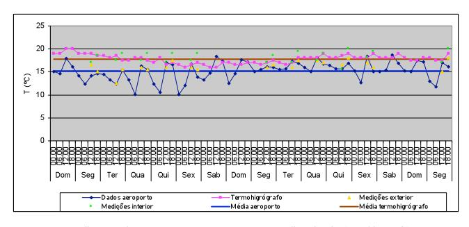
T média no exterior: 15,2°C Valor máximo: 18,7°C Valor mínimo: 10,1°C T média no interior (termohigrógrafo): 17,8°C Valor máximo: 20°C Valor mínimo: 16°C Variação máxima diária: 1,5°C
