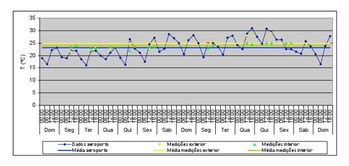
T média no exterior: 23,1°C Valor máximo: 30,9°C Valor mínimo: 16°C T média no exterior (medições): 24,9°C Valor máximo: 29°C
