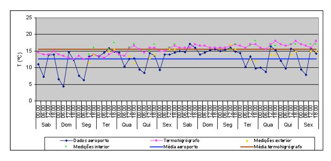
T média no exterior: 12,7°C Valor máximo: 17,1°C Valor mínimo: 4,4°C T média no interior (termohigrógrafo): 15,5°C Valor máximo: 18°C Valor mínimo: 12,5°C Variação máxima diária: 2,5°C
