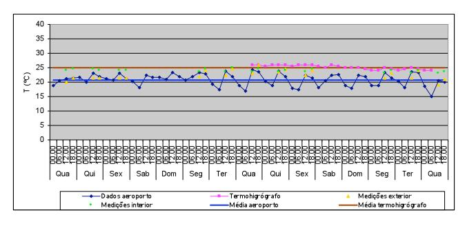
T média no exterior: 20,8°C Valor máximo: 24,3°C Valor mínimo: 15,1°C T média no interior (termohigrógrafo): 25,1°C Valor máximo: 26°C Valor mínimo: 24°C Variação máxima diária: 1°C
