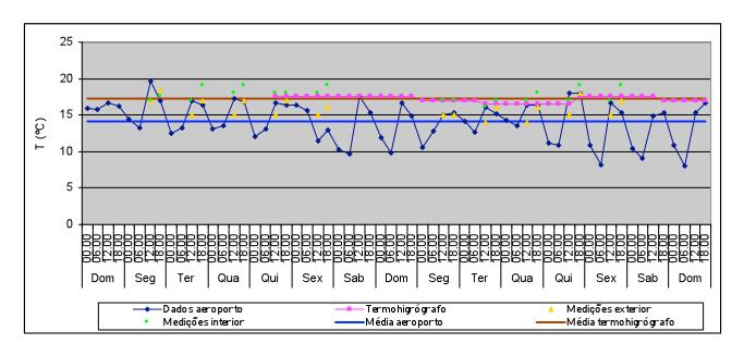
T média no exterior: 14,2°C Valor máximo: 19,7°C Valor mínimo: 8°C T média no interior (termo-higrógrafo): 17,2°C Valor máximo: 17,5°C Valor mínimo: 16,5°C Variação máxima diária: 1°C
