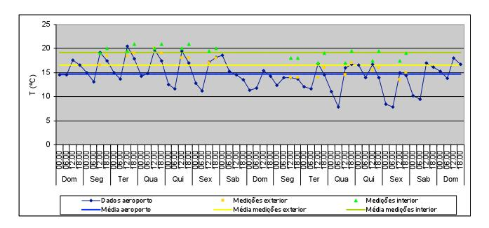
T média no exterior: 14,7°C Valor máximo: 20,5°C Valor mínimo: 7,8°C T média no exterior (medições): 16,6°C Valor máximo: 19°C
