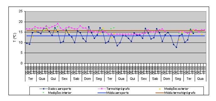
T média no exterior: 13,2°C Valor máximo: 17,5°C Valor mínimo: 7,7°C T média no interior (termohigrógrafo): 15,7°C Valor máximo: 19°C Valor mínimo: 14°C Variação máxima diária: 2°C
