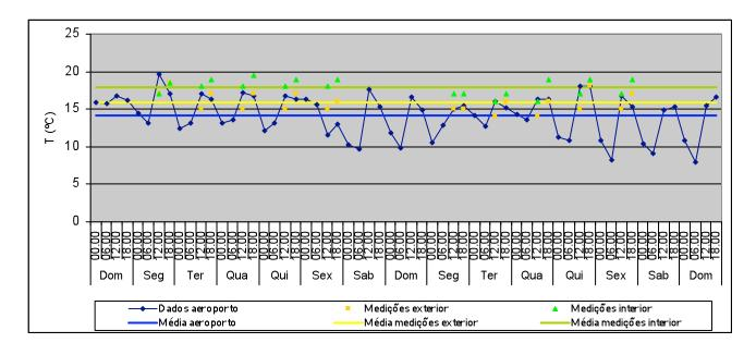
T média no exterior: 14,2°C Valor máximo: 19,7°C Valor mínimo: 8°C T média no exterior (medições): 15,9°C Valor máximo: 18,5°C Valor mínimo: 14°C T média no interior (medições): 17,9°C Valor máximo: 19,5°C Valor mínimo: 15,5°C Variação máxima diária: 3,5°C
