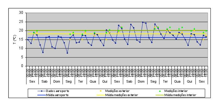
T média no exterior: 16,2°C Valor máximo: 24,7°C Valor mínimo: 7,3°C T média no exterior (medições): 18,3°C Valor máximo: 22°C
