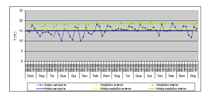
T média no exterior: 15,2°C Valor máximo: 18,7°C Valor mínimo: 10,1°C T média no exterior (medições): 16,2°C Valor máximo: 18°C
