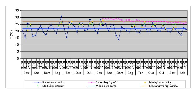
T média no exterior: 21,9°C Valor máximo: 30,8°C Valor mínimo: 13,9°C T média no interior (termohigrógrafo): 27,3°C Valor máximo: 29°C Valor mínimo: 25,5°C Variação máxima diária: 2°C
