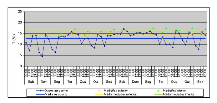
T média no exterior: 12,7°C Valor máximo: 17,1°C Valor mínimo: 4,4°C T média no exterior (medições): 14,3°C Valor máximo: 17°C
