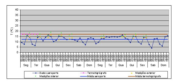
T média no exterior: 12,2°C Valor máximo: 16,5°C Valor mínimo: 4,2°C T média no interior (termohigrógrafo): 17°C Valor máximo: 17°C Valor mínimo: 17°C Variação máxima diária: 0°C
