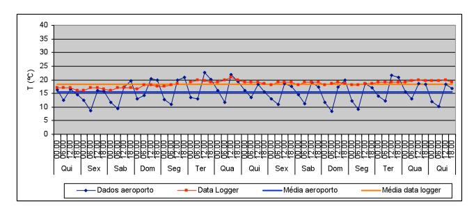
T média no exterior: 15,5°C Valor máximo: 22,8°C Valor mínimo: 8,5°C T média no interior (data logger): 18,4°C Valor máximo: 21°C Valor mínimo: 16°C Variação máxima diária: 2°C
