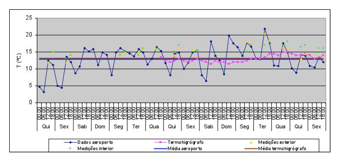
T média no exterior: 12,8°C Valor máximo: 21,8°C Valor mínimo: 3,2°C T média no interior (termohigrógrafo): 13,2°C Valor máximo: 15°C Valor mínimo: 11,5°C Variação máxima diária: 1,5°C
