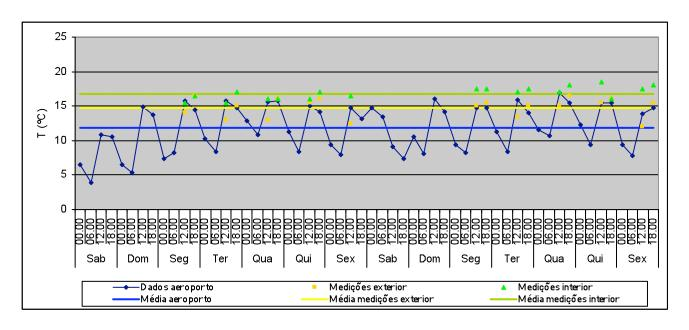
T média no exterior: 11,8°C Valor máximo: 16,9°C Valor mínimo: 3,9°C T média no exterior (medições): 14,8°C Valor máximo: 16,5°C
