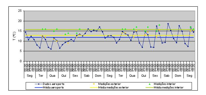
T média no exterior: 11,8°C Valor máximo: 18,6°C Valor mínimo: 6°C T média no exterior (medições): 12,9°C Valor máximo: 16°C
