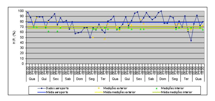
H.R. média no exterior: 78,4% Valor máximo: 100% Valor mínimo: 44% H.R. média no exterior (medições): 71,1% Valor máximo: 87% Valor mínimo: 47% H.R. média no interior (medições): 67'
