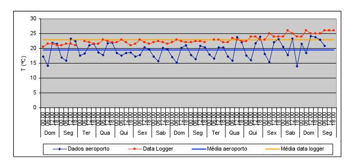
T média no exterior: 19,4°C Valor máximo: 24,2°C Valor mínimo: 13,9°C T média no interior (data logger): 22,9°C Valor máximo: 26°C Valor mínimo: 20,5°C Variação máxima diária: 2°C
