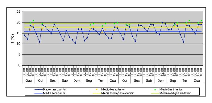
T média no exterior: 15,9°C Valor máximo: 20°C Valor mínimo: 10,4°C T média no exterior (medições): 17,8°C Valor máximo: 19,5°C
