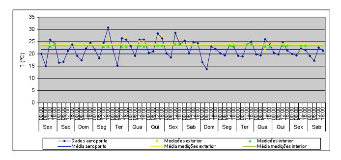
T média no exterior: 21,9°C Valor máximo: 30,8°C Valor mínimo: 13,9°C T média no exterior (medições): 24,1°C Valor máximo: 27°C
