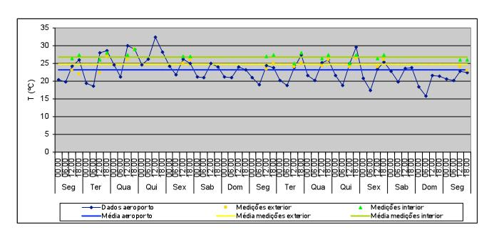
T média no exterior: 23,2°C Valor máximo: 32,4°C Valor mínimo: 15,9°C T média no exterior (medições): 24,8°C Valor máximo: 29°C
