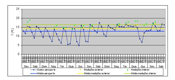
T média no exterior: 12,8°C Valor máximo: 17,5°C Valor mínimo: 4,9°C T média no exterior (medições): 14,2°C Valor máximo: 18°C
