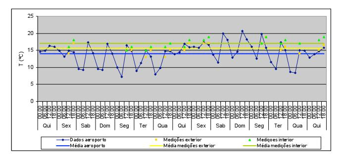
T média no exterior: 14°C Valor máximo: 20,7°C Valor mínimo: 7,2°C T média no exterior (medições): 15,6°C Valor máximo: 19°C
