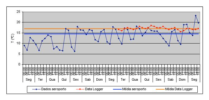
T média no exterior: 14,5°C Valor máximo: 23,2°C Valor mínimo: 6,2°C T média no interior (data logger): 17°C Valor máximo: 18,5°C Valor mínimo: 15,5°C Variação máxima diária: 1,5°C
