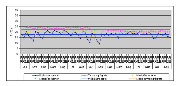
T média no exterior: 17,8°C Valor máximo: 21,4°C Valor mínimo: 9,4°C T média no interior (termohigrógrafo): 22,1°C Valor máximo: 24,5°C Valor mínimo: 20°C Variação máxima diária: 1°C
