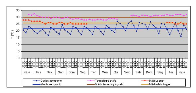
T média no exterior: 21,6°C Valor máximo: 27,2°C Valor mínimo: 15,8°C T média no interior (data logger): 25,8°C Valor máximo: 28°C Valor mínimo: 25°C Variação máxima diária: 2°C
