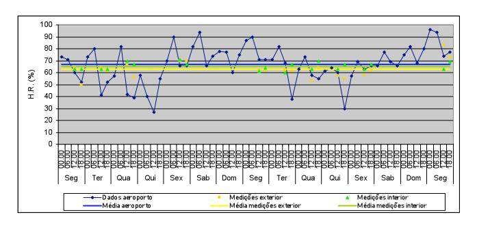
H.R. média no exterior: 67% Valor máximo: 96% Valor mínimo: 27% H.R. média no exterior (medições): 62,7% Valor máximo: 83% Valor mínimo: 50% H.R. média no interior (medições): 65,2% Valor máximo: 71%
