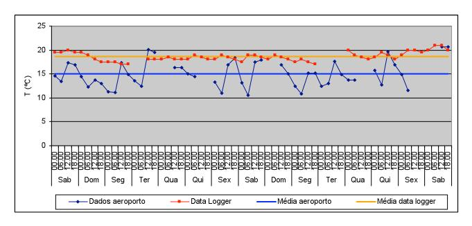
T média no exterior: 15°C Valor máximo: 20,1°C Valor mínimo: 10,6°C T média no interior (data logger): 18,6°C Valor máximo: 21°C Valor mínimo: 17°C Variação máxima diária: 2°C
