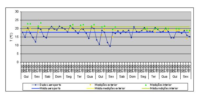
T média no exterior: 17,8°C Valor máximo: 21,7°C Valor mínimo: 9,4°C T média no exterior (medições): 19,1°C Valor máximo: 22°C
