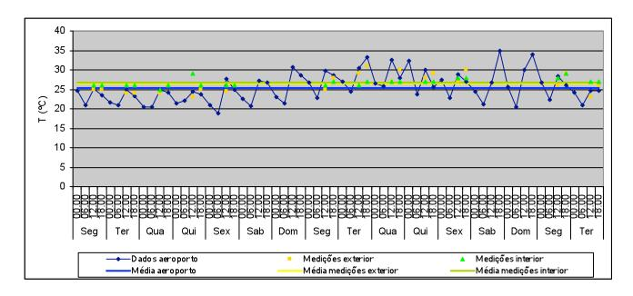
T média no exterior: 25,4°C Valor máximo: 34,8°C Valor mínimo: 18,8°C T média no exterior (medições): 26,4°C Valor máximo: 31°C
