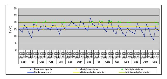
T média no exterior: 15,9°C Valor máximo: 23,1°C Valor mínimo: 7,6°C T média no exterior (medições): 17,3°C Valor máximo: 20°C
