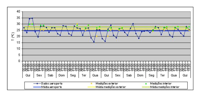
T média no exterior: 24,5°C Valor máximo: 34,7°C Valor mínimo: 15,6°C T média no exterior (medições): 26°C Valor máximo: 30°C
