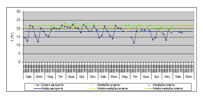
T média no exterior: 18,3°C Valor máximo: 22,5°C Valor mínimo: 11,5°C T média no exterior (medições): 19,1°C Valor máximo: 23°C
