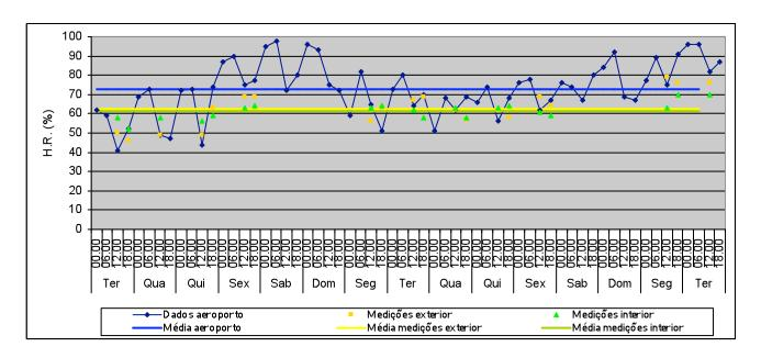
H.R. média no exterior: 72,8% Valor máximo: 98% Valor mínimo: 41% H.R. média no exterior (medições): 62,7% Valor máximo: 79% Valor mínimo: 46% H.R. média no interior (medições): 61,4% Valor máximo: 70%
