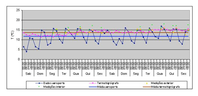
T média no exterior: 11,8°C Valor máximo: 16,9°C Valor mínimo: 3,9°C T média no interior (termohigrógrafo): 13,7°C Valor máximo: 15,5°C Valor mínimo: 11,5°C Variação máxima diária: 1,5°C
