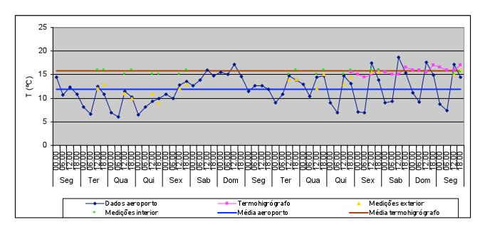
T média no exterior: 11,9°C Valor máximo: 18,6°C Valor mínimo: 6°C T média no interior (termohigrógrafo): 15,8°C Valor máximo: 17°C Valor mínimo: 14,5°C Variação máxima diária: 1,5°C
