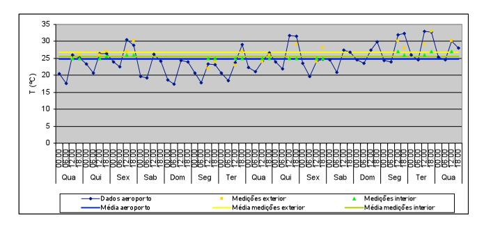
T média no exterior: 24,7°C Valor máximo: 32,9°C Valor mínimo: 17,3°C T média no exterior (medições): 26,8°C Valor máximo: 33°C
