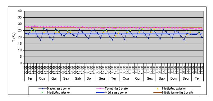
T média no exterior: 22,5°C Valor máximo: 27,1°C Valor mínimo: 17,8°C T média no interior (termohigrógrafo): 27,3°C Valor máximo: 28,5°C Valor mínimo: 26°C Variação máxima diária: 1°C
