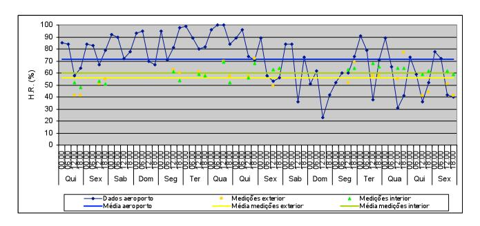
H.R. média no exterior: 71,5% Valor máximo: 100% Valor mínimo: 23% H.R. média no exterior (medições): 56% Valor máximo: 77% Valor mínimo: 41% H.R. média no interior (medições): 59,9% Valor máximo: 69% Valor mínimo: 48% Variação máxima diária: 17%
