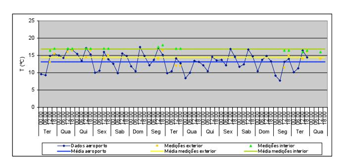
T média no exterior: 13,2°C Valor máximo: 17,5°C Valor mínimo: 7,7°C T média no exterior (medições): 14,5°C
