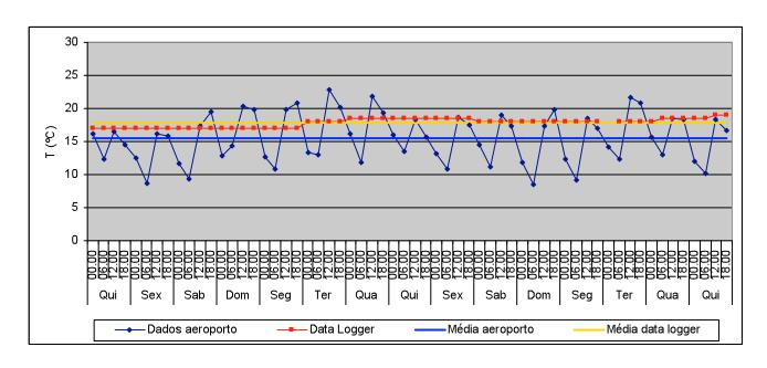
T média no exterior: 15,5°C Valor máximo: 22,8°C Valor mínimo: 8,5°C T média no interior (data logger): 17,8°C Valor máximo: 19°C Valor mínimo: 17°C Variação máxima diária: 1°C
