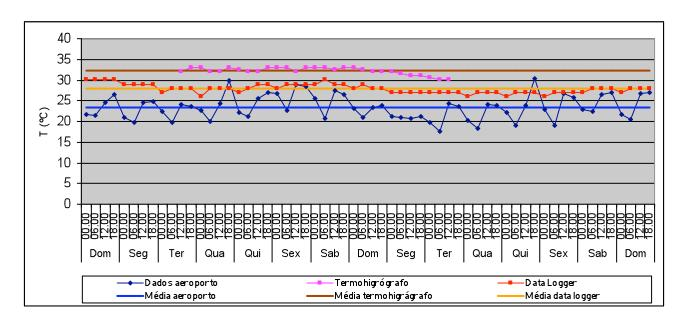
T média no exterior: 23,4°C Valor máximo: 30,4°C Valor mínimo: 17,6°C T média no interior (data logger): 27,9°C Valor máximo: 30°C Valor mínimo: 26°C Variação máxima diária: 2°C
