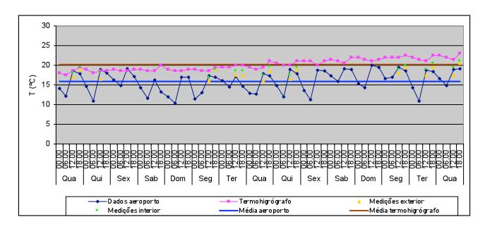
T média no exterior: 15,9°C Valor máximo: 20°C Valor mínimo: 10,4°C T média no interior (termohigrógrafo): 20,1°C Valor máximo: 23°C Valor mínimo: 17,5°C Variação máxima diária: 2°C
