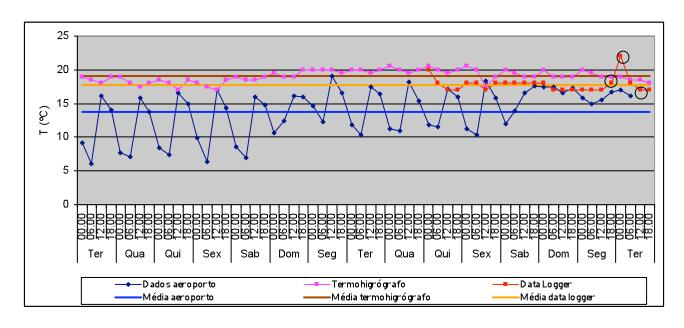
T média no exterior: 13,8°C Valor máximo: 19,1°C Valor mínimo: 6,1°C T média no interior (data logger): 17,8°C Valor máximo: 22°C Valor mínimo: 17°C Variação máxima diária: 5°C
