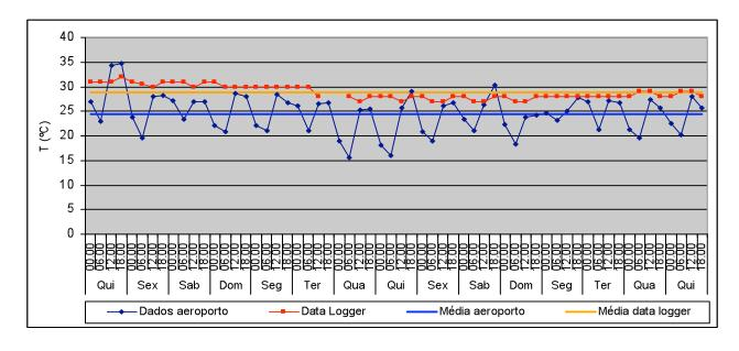
T média no exterior: 24,5°C Valor máximo: 34,7°C Valor mínimo: 15,6°C T média no interior (data logger): 28,9°C Valor máximo: 32°C Valor mínimo: 27°C Variação máxima diária: 1°C
