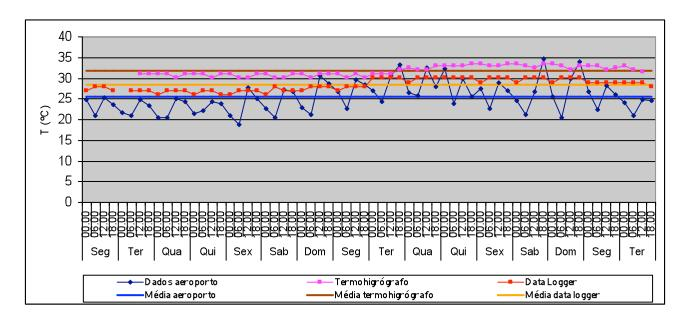
T média no exterior: 25,5°C Valor máximo: 34,8°C Valor mínimo: 18,8°C T média no interior (data logger): 28,4°C Valor máximo: 30°C Valor mínimo: 26°C Variação máxima diária: 2°C
