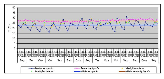
T média no exterior: 22,9°C Valor máximo: 31,3°C Valor mínimo: 16,1°C T média no interior (termohigrógrafo): 27,1°C Valor máximo: 29°C Valor mínimo: 25,5°C Variação máxima diária: 1°C
