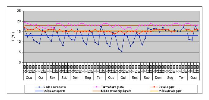
T média no exterior: 13,1°C Valor máximo: 17,8°C Valor mínimo: 5,4°C T média no interior (data logger): 15,4°C Valor máximo: 17°C Valor mínimo: 14°C Variação máxima diária: 2°C
