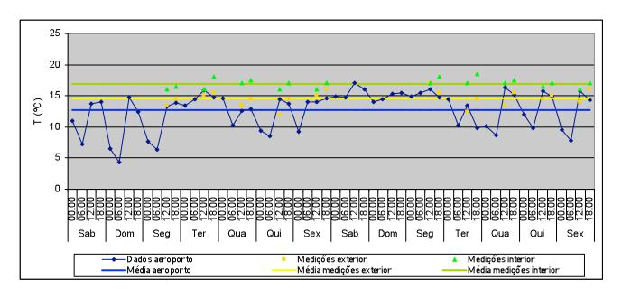
T média no exterior: 12,7°C Valor máximo: 17,1°C Valor mínimo: 4,4°C T média no exterior (medições): 14,6°C Valor máximo: 17°C
