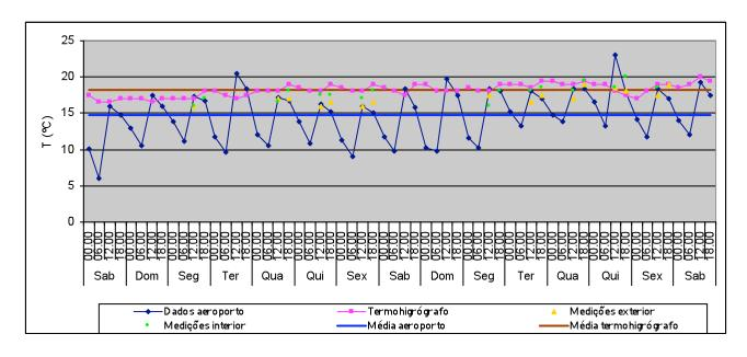
T média no exterior: 14,7°C Valor máximo: 23,1°C Valor mínimo: 6°C T média no interior (termohigrógrafo): 18,2°C Valor máximo: 20°C Valor mínimo: 16,5°C Variação máxima diária: 2°C
