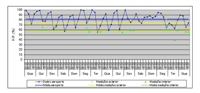
H.R. média no exterior: 81,9% Valor máximo: 100% Valor mínimo: 57% H.R. média no exterior (medições): 74% Valor máximo: 95% Valor mínimo: 62% H.R. média no interior (medições): 59,1° Valor máximo: 71% Valor mínimo: 39% Variação máxima diária: 20%
