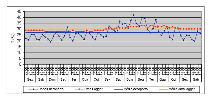
T média no exterior: 27,1°C Valor máximo: 42,1°C Valor mínimo: 19°C T média no interior (data logger): 30°C Valor máximo: 33°C Valor mínimo: 28°C Variação máxima diária: 2°C
