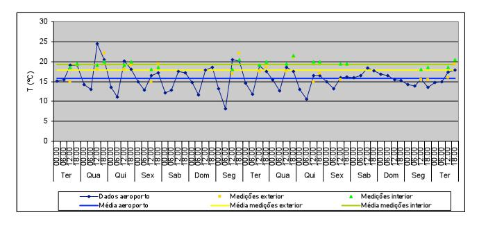
T média no exterior: 15,8°C Valor máximo: 24,4°C Valor mínimo: 8,1°C T média no exterior (medições): 17,8°C Valor máximo: 22°C
