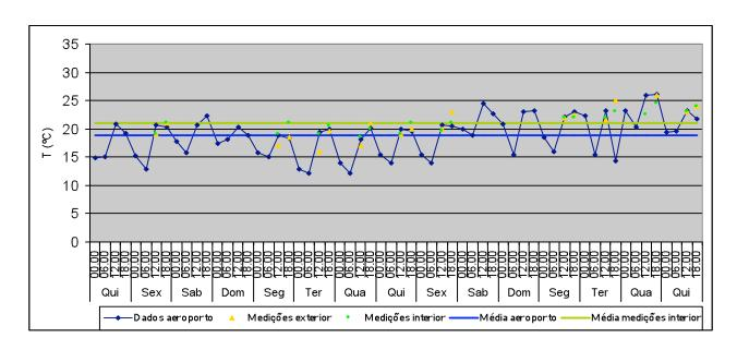
T média no exterior: 18,8°C Valor máximo: 26,2°C Valor mínimo: 12,1°C T média no interior (medições): 21°C Valor máximo: 24,5°C Valor mínimo: 18,5°C Variação máxima diária: 3°C
