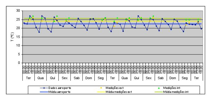
T média no exterior: 22,5°C Valor máximo: 27 Valor mínimo: 17,8°C T média no exterior (medições): 24,1°C Valor máximo: 26
