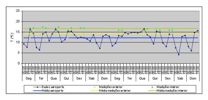
T média no exterior: 12,2°C Valor máximo: 16,5°C Valor mínimo: 42°C T média no exterior (medições): 14,1°C Valor máximo: 16°C
