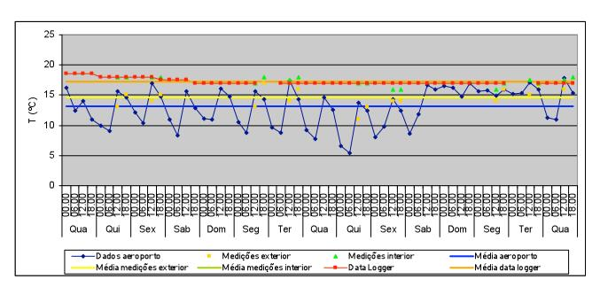
T média no exterior: 13,1°C Valor máximo: 17,8°C Valor mínimo: 5,4°C T média no exterior (medições): 14,6°C Valor máximo: 17°C Valor mínimo: 11°C T média no interior (medições): 17,3°C Valor máximo: 18°C
