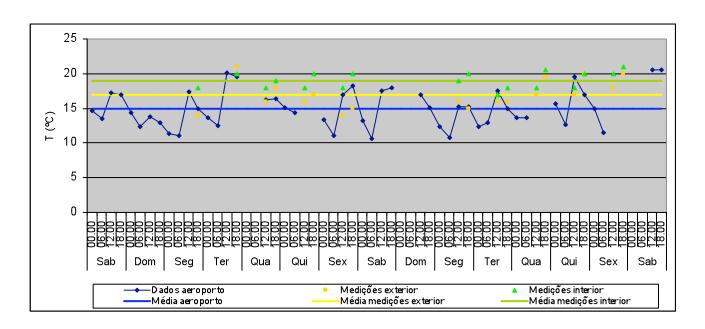
T média no exterior: 15°C Valor máximo: 20,6°C Valor mínimo: 10,6°C T média no exterior (medições): 17°C Valor máximo: 21°C Valor mínimo: 14°C T média no interior (medições): 19°C Valor máximo: 21°C Valor mínimo: 17°C Variação máxima diária: 3°C
