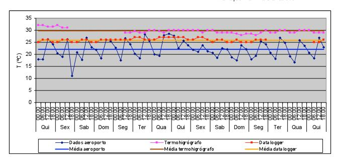
T média no exterior: 22,1°C Valor máximo: 28,6°C Valor mínimo: 11,1°C T média no interior (data logger): 25,9°C Valor máximo: 27°C Valor mínimo: 25°C Variação máxima diária: 1°C
