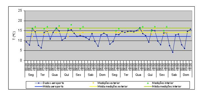
T média no exterior: 12,2°C Valor máximo: 16,5°C Valor mínimo: 4,2°C T média no exterior (medições): 14,1°C Valor máximo: 16,5°C Valor mínimo: 12°C T média no interior (medições): 16,4°C Valor máximo: 18°C Valor mínimo: 15°C
