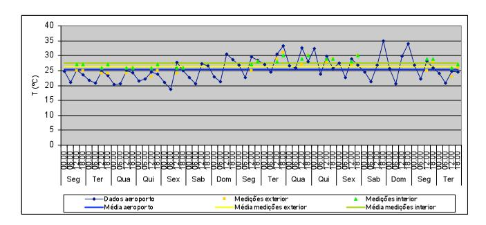
T média no exterior: 25,4°C Valor máximo: 34,8°C Valor mínimo:18,8°C T média no exterior (medições): 26,3°C Valor máximo: 31°C Valor mínimo:23°C T média no interior (medições): 27,6°C Valor máximo: 30°C Valor mínimo:26°C Variação máxima diária: 2°C
