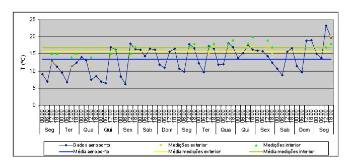
T média no exterior: 13,5°C Valor máximo: 23,2°C Valor mínimo: 6,2°C T média no exterior (medições): 15,6°C Valor máximo: 20°C
