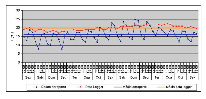
T média no exterior: 16,2°C Valor máximo: 24,7°C Valor mínimo: 7,3°C T média no interior (data logger): 19,9°C Valor máximo: 24°C Valor mínimo: 17°C Variação máxima diária: 2°C
