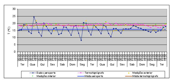
T média no exterior: 15,8°C Valor máximo: 24,4°C Valor mínimo: 8,1°C T média no interior (termohigrógrafo): 18,7°C Valor máximo: 20°C Valor mínimo: 17°C Variação máxima diária: 2°C
