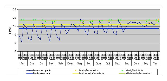
T média no exterior: 13,8°C Valor máximo: 19,1°C Valor mínimo: 6,1°C T média no exterior (medições): 16°C Valor máximo: 19°C
