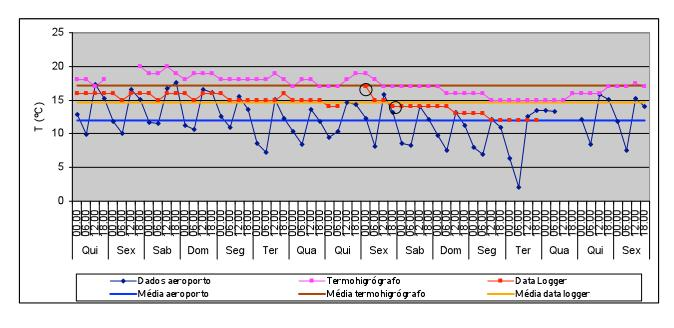
T média no exterior: 12°C Valor máximo: 17,6°C Valor mínimo: 2,1°C T média no interior (data logger): 14,6°C Valor máximo: 17°C Valor mínimo: 12°C Variação máxima diária: 3°C
