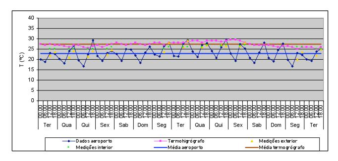
T média no exterior: 22,9°C Valor máximo: 29,3°C Valor mínimo: 16,7°C T média no interior (termohigrógrafo): 27,3°C Valor máximo: 29,5°C Valor mínimo: 25°C Variação máxima diária: 1,5°C
