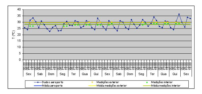
T média no exterior: 28,3°C Valor máximo: 36,3°C Valor mínimo: 22,7°C T média no exterior (medições): 29,5°C
