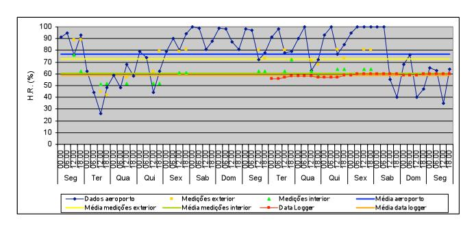
H.R. média no exterior: 77% Valor máximo: 100% Valor mínimo: 26% H.R. média no exterior (medições): 72,7% Valor máximo: 89% Valor mínimo: 42% H.R. média no interior (medições): 60,7% Valor máximo: 76% Valor mínimo: 51%
