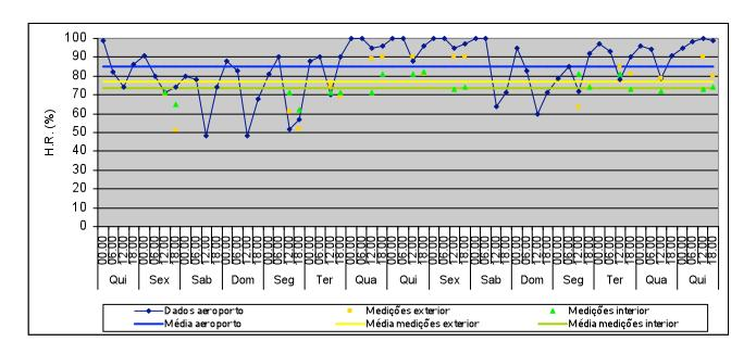
H.R. média no exterior: 84,9% Valor máximo: 100% Valor mínimo: 48% H.R. média no exterior (medições): 76,8% Valor máximo: 90% Valor mínimo: 51% H.R. média no interior (medições): 73,8% Valor máximo: 82% Valor mínimo: 62% Variação máxima diária: 10%
