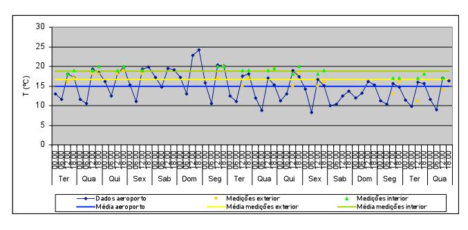
T média no exterior: 14,9°C Valor máximo: 24,2°C Valor mínimo: 8,2°C T média no exterior (medições): 16,7°C Valor máximo: 19,5°C
