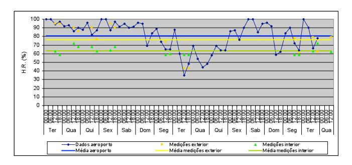
H.R. média no exterior: 81,1% Valor máximo: 100% Valor mínimo: 35% H.R. média no exterior (medições): 76,2% Valor máximo: 95% Valor mínimo: 43% H.R. média no interior (medições): 63,49 Valor máximo: 72% Valor mínimo: 59%
