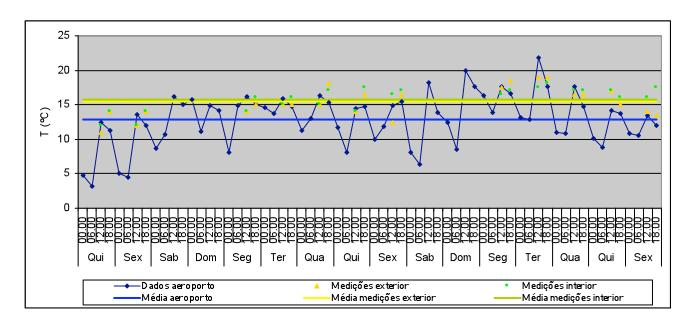
T média no exterior: 12,9°C Valor máximo: 21,8°C Valor mínimo: 3,2°C T média no exterior (medições): 15,4°C Valor máximo: 19°C
