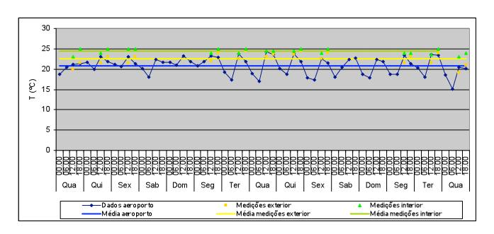
T média no exterior: 20,8°C Valor máximo: 24,5°C Valor mínimo: 15,1°C T média no exterior (medições): 22,5°C
