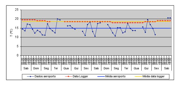
T média no exterior: 15°C T média no interior (data logger): 18,6°C Valor máximo: 20,6°C Valor máximo: 19,5°C Valor mínimo: 10,6°C Valor mínimo: 18°C
