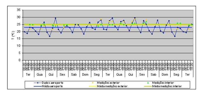
T média no exterior: 22,9°C Valor máximo: 29,3°C Valor mínimo: 16,7°C T média no exterior (medições): 24,8°C
