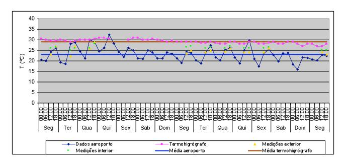
T média no exterior: 23,1°C Valor máximo: 32,4°C Valor mínimo: 15,9°C T média no interior (termohigrógrafo): 29,1°C Valor máximo: 31°C Valor mínimo: 27°C Variação máxima diária: 2°C
