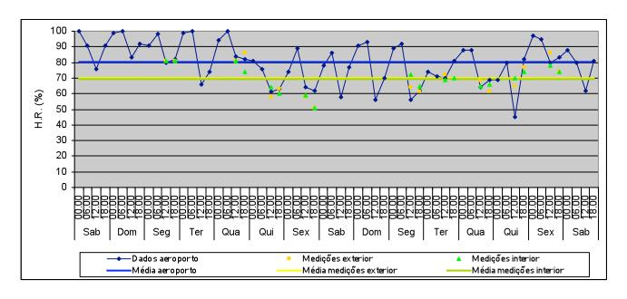
H.R. média no exterior: 80,1% H.R. média no exterior (medições): 69,8% H.R. média no interior (medições): 69,6% Valor máximo: 100% Valor máximo: 86% Valor máximo: 80% Valor mínimo: 45% Valor mínimo: 51% Valor mínimo: 51% Variação máxima diária: 8%
