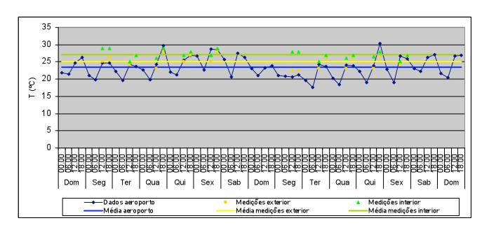
T média no exterior: 23,4°C Valor máximo: 30,4°C Valor mínimo:17,6°C T média no exterior (medições): 25,1°C Valor máximo: 28°C Valor mínimo:22,5°C T média no interior (medições): 27,2°C Valor máximo: 29°C Valor mínimo:25°C Variação máxima diária: 3°C
