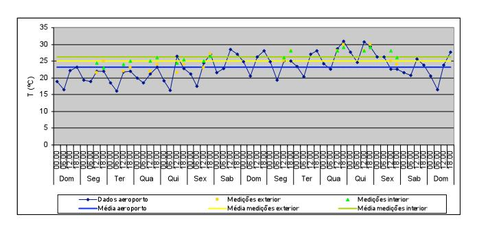
T média no exterior: 23,1°C Valor máximo: 30,9°C Valor mínimo: 16°C T média no exterior (medições): 25,1°C Valor máximo: 30°C Valor mínimo: 21,5°C T média no interior (medições): 26,2°C Valor máximo: 29°C Valor mínimo: 23°C Variação máxima diária: 2°C
