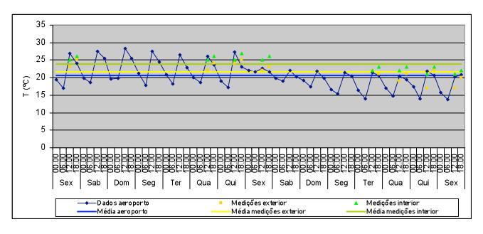
T média no exterior: 20,6°C Valor máximo: 28,3°C Valor mínimo: 13,7°C T média no exterior (medições): 21,7°C Valor máximo: 25°C
