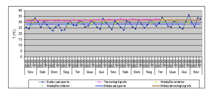
T média no exterior: 28,3°C Valor máximo: 36,3°C Valor mínimo: 22,7°C T média no interior (termohigrógrafo): 31,8°C Valor máximo: 33°C Valor mínimo: 31°C Variação máxima diária: 1°C
