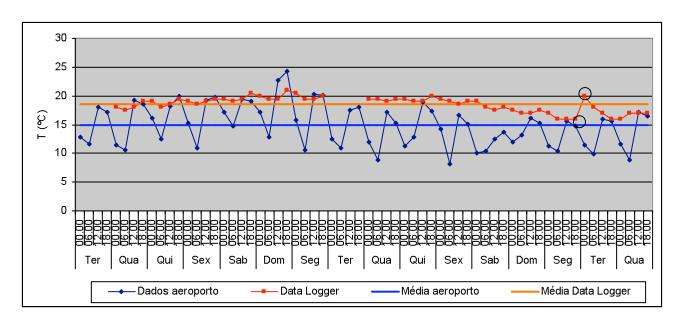
T média no exterior: 14,9°C Valor máximo: 24,2°C Valor mínimo: 8,2°C T média no interior (data logger): 18,5°C Valor máximo: 21°C Valor mínimo: 16°C Variação máxima diária: 4°C
