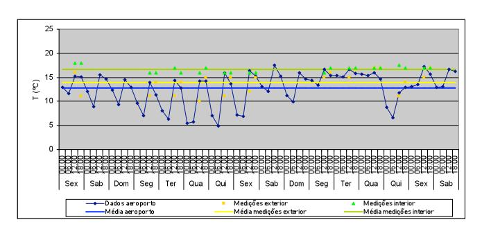
T média no exterior: 12,8°C Valor máximo: 17,5°C Valor mínimo: 4,9°C T média no exterior (medições): 14°C Valor máximo: 17°C
