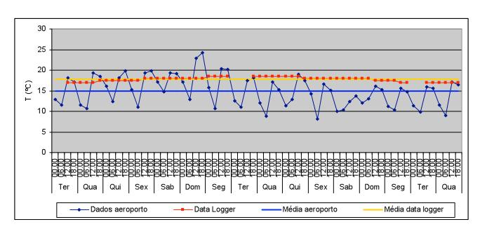
T média no exterior: 14,9°C Valor máximo: 24,2°C Valor mínimo: 8,2°C T média no interior (data logger): 17,8°C Valor máximo: 18,5°C Valor mínimo: 17°C Variação máxima diária: 0,5°C
