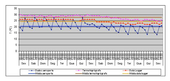
T média no exterior: 20,6°C Valor máximo: 28,3°C Valor mínimo: 13,7°C T média no interior (data logger): 24,5°C Valor máximo: 26°C Valor mínimo: 22°C Variação máxima diária: 2°C
