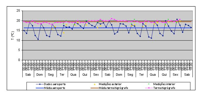
T média no exterior: 16,3°C Valor máximo: 20,7°C Valor mínimo: 10,6°C T média no interior (termohigrógrafo): 19,5°C Valor máximo: 21°C Valor mínimo: 18,5°C Variação máxima diária: 1°C
