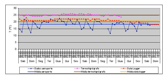
T média no exterior: 18,3°C Valor máximo: 22,4°C Valor mínimo: 11,5°C T média no interior (data logger): 20,8°C Valor máximo: 23°C Valor mínimo: 18°C Variação máxima diária: 2°C
