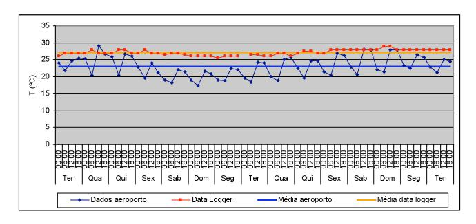
T média no exterior: 23°C Valor máximo: 29,1°C Valor mínimo: 17,3°C T média no interior (data logger): 27,2°C Valor máximo: 29°C Valor mínimo: 25,5°C Variação máxima diária: 1,5°C
