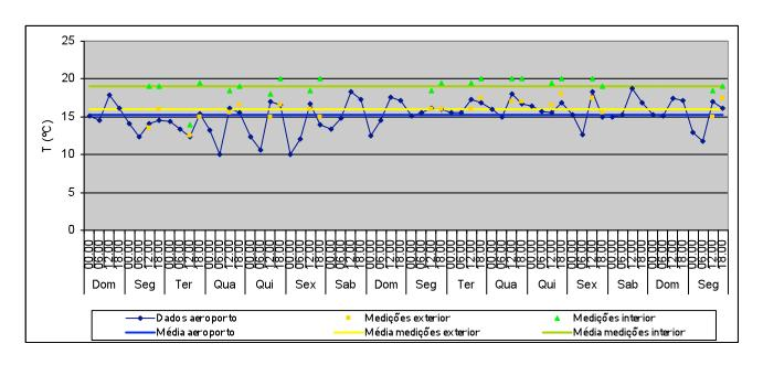
T média no exterior: 15,2°C Valor máximo: 18,7°C Valor mínimo: 10,1°C T média no exterior (medições): 16°C Valor máximo: 18°C Valor mínimo: 12,5°C T média no interior (medições): 19°C Valor máximo: 20°C Valor mínimo: 14°C Variação máxima diária: 5,5°C
