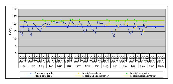
T média no exterior: 18,3°C Valor máximo: 21,9°C Valor mínimo: 11,5°C T média no exterior (medições): 19,3°C Valor máximo: 23°C
