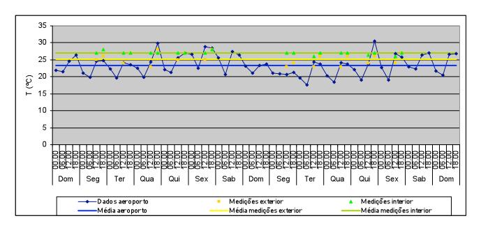
T média no exterior: 23,4°C Valor máximo: 30,4°C Valor mínimo: 17,6°C T média no exterior (medições): 25,2°C Valor máximo: 28°C
