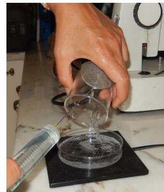
Figura 20 - Deposição do líquido do filtro na placa de Petri, e uso de uma seringa com soro para empurrar todas as substâncias aderentes ao filtro.
