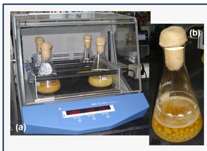
Figura 3.1. Produção de culturas líquidas de micélios isolados de A. ponderosa : incubação a 28°C em agitação orbital, a 150 rpm (a) e aspeto da cultura crescida ao fim de 15 dias de incubação (b).
