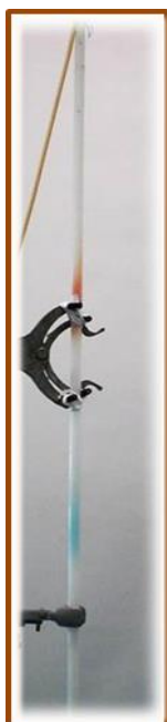
Figura 5.5. Sistema cromatográfico utilizado para separação dos extratos de PPS por SEC.
