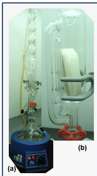
Figura 3.2. Representação da montagem do extrator Soxhlet para a extração dos compostos lipofílicos (a), pormenor do cartucho contendo a amostra liofilizada de corpos de frutificação e micélios de A. ponderosa (b).
