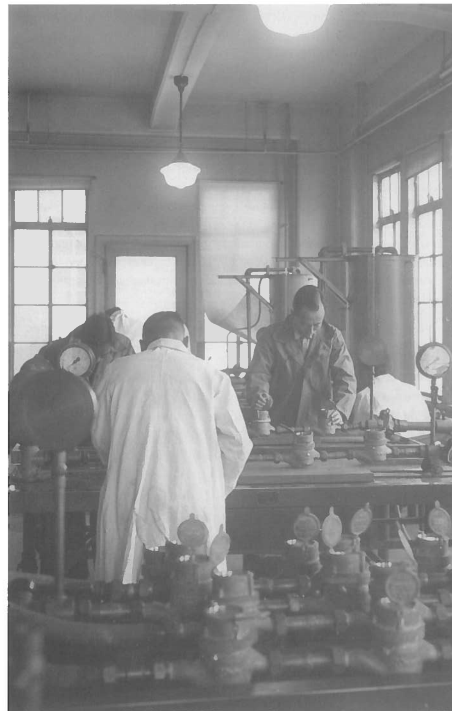
Fig. 2 – Laboratório de aferição de contadores de água (Europa), foto IPQ-Museu/Arquivo
