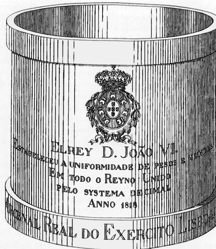
Medida da colecção de padrões de capacidade do sistema métrico decimal, com nomenclatura portuguesa. Esta medida, com a capacidade de 1 litro, tem no lado oposto ao representado a seguinte inscrição:
