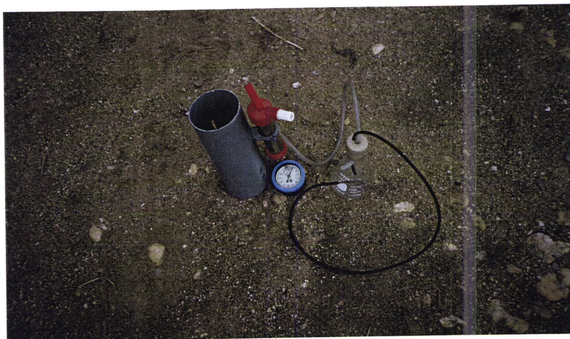
Figura 3.6 Bomba de vácuo e copo de Erlenmeyer, material necessário, respectivamente, para a colocação das cápsulas cerâmicas porosas à carga e para a recolha da amostra de solução do solo.
