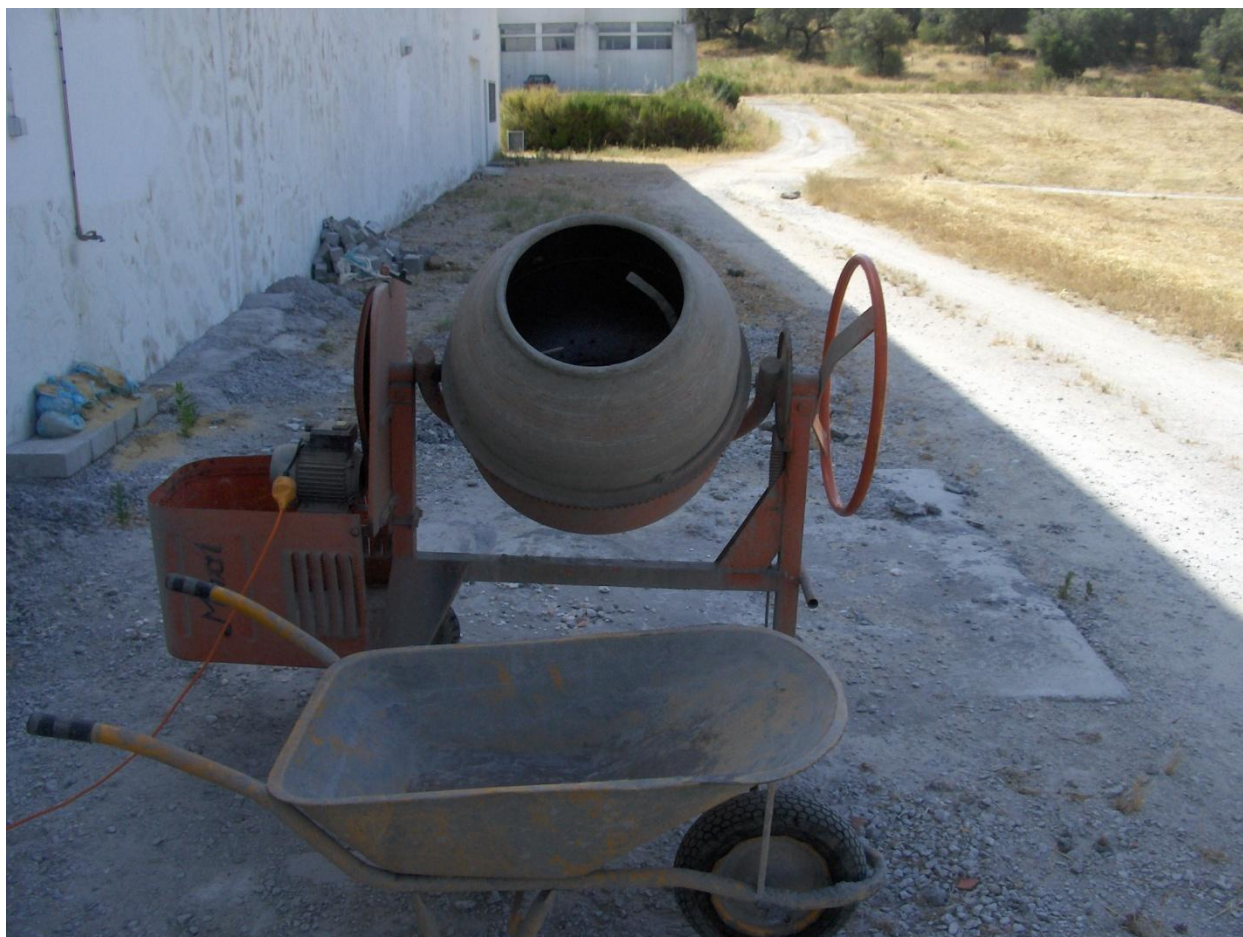
Figura 3.14 – Betoneira e carro de mão
