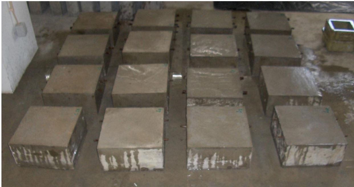
Figura 3.20 – Manutenção da superfície do betão húmida
