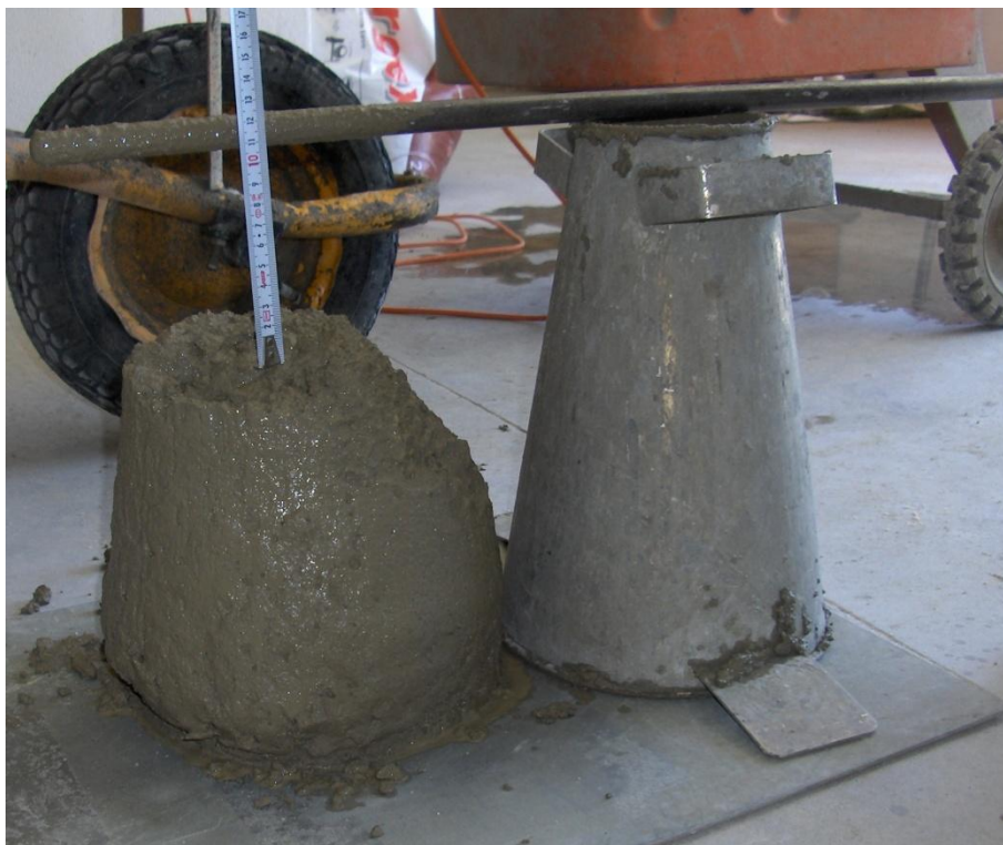
Figura 3.16 – Ensaio de abaixamento pelo Cone de Abrams
