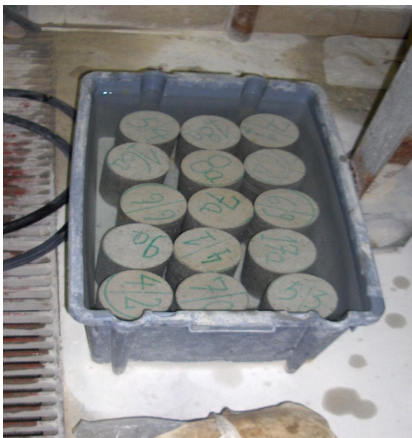
Figura 3.28 – Carotes submersas em água até ensaio
