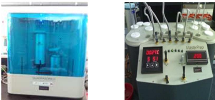
**Figura 15. Aparelho automatizado de análise volumétrica, Quadrasorb da Quantachrome Instruments e unidade de degaseificação Master Prep.**
