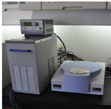
**Figura 20. Analisador Térmico Simultâneo (STA) da marca Perkin-Elmer, modelo STA 6000.**
