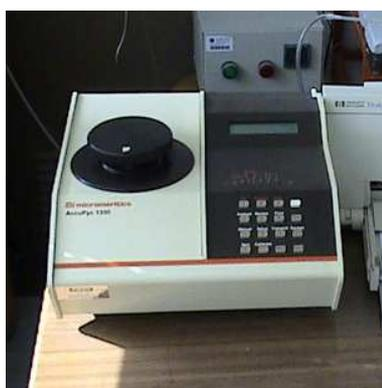
**Figura 16. Picnómetro de hélio da Micromeritics, modelo Accupyc 1330.**
