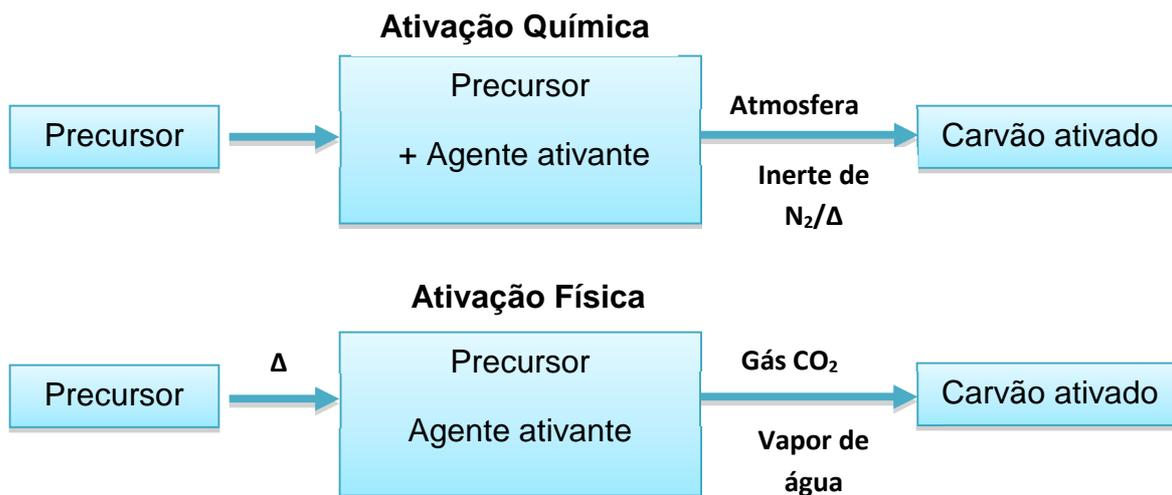
**Figura 5. Esquema geral dos processos de ativação física e química [11].**
