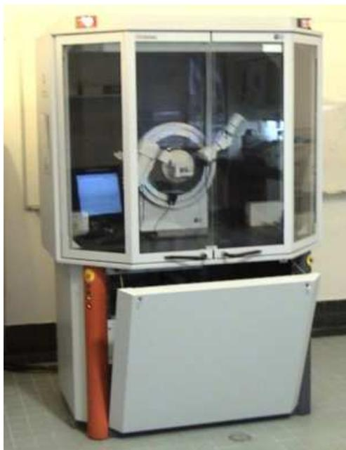
**Figura 19. Difractómetro de raios-X marca Bruker modelo AXS D8 Advance.**
