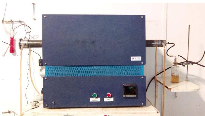
**Figura 12. Forno tubular utilizado na preparação dos carvões ativados.**
