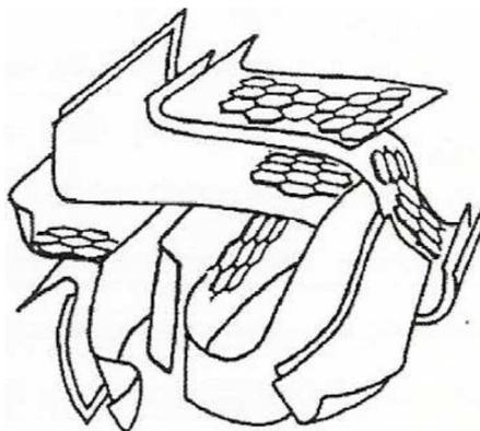
**Figura 6. Representação esquemática da microestrutura de um carvão ativado [25].**
