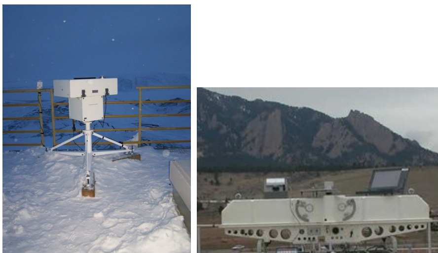
Figura 3.4- Espectrómetros para monitorização do ozono estratosférico: Brewer (à esquerda) e Dobson (à direita). [30] [31]
