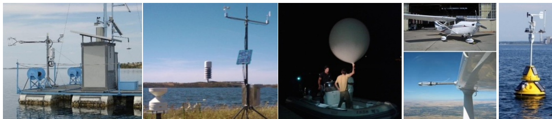
Figura 3.1- Instrumentação de detecção in situ: em plataforma flutuante, terra, balão a partir de barco, avião e em boia. [35] [32] [33]
