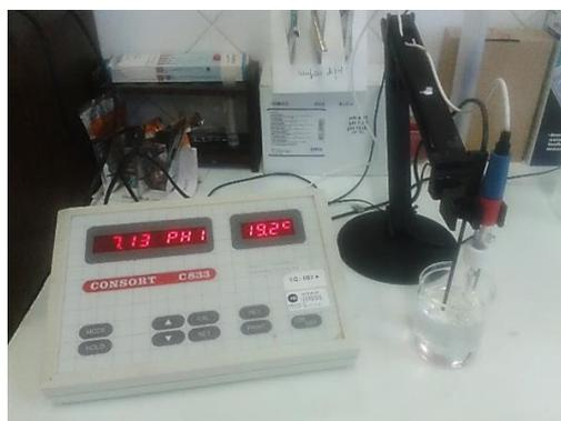
Figura 41 – Medidor de pH “CONSORT C833” utilizado para avaliar a evolução do pH das soluções alcalinas de imersão dos agregados.
