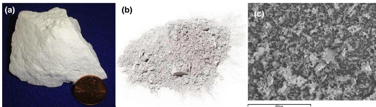
Figura 4 – Caulino: (a) Fragmento; Metacaulino: (b) amostra em pó, (c) partículas observadas ao Microscópio Eletrónico de Varrimento (1000x).
