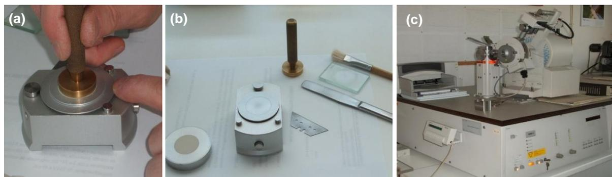
Figura 43 – Procedimento de análise mineralógica por DRX dos agregados e betões em estudo: a) Enchimento e compactação da amostra no porta-amostras; b) amostra pronta para introdução no difractómetro e material
