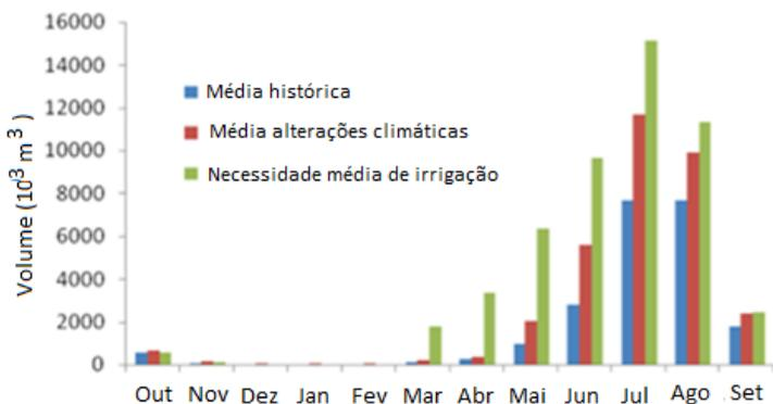
**Figura 6.20-** Ciclo de importação de água no reservatório de Odivelas, em cenário de alterações climáticas.
