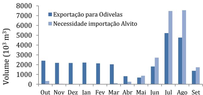
**Figura 6.18-** Ciclo anual de descarga do reservatório de Alvito.
