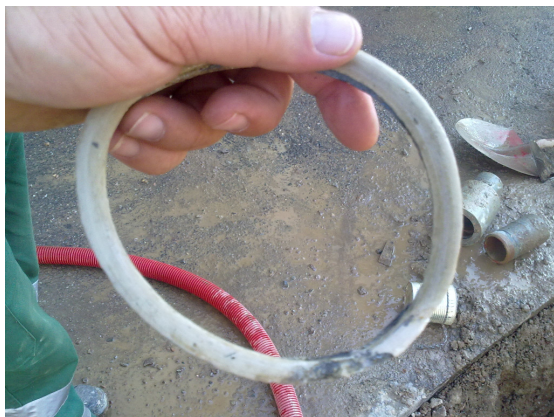
Figura 19 - Pormenor de desgaste do anel de borracha
