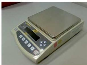
A **balança** é um instrumento que mede a **massa** de um corpo. A unidade para massa é o **kg**. Assim o correcto é dizer que as balanças medem as massas dos corpos e objectos e não o seu peso. A balança electrónica que vais usar é de grande precisão porque o seu mecanismo possui elevada sensibilidade de leitura e indicação.
