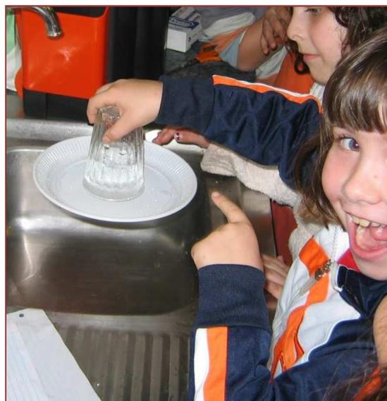
**Figura 3.6** - Na imagem, os alunos divertem-se a verificar que a pressão exercida pelo ar no prato impede a água de cair.
