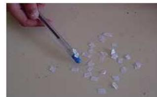
Ao ser friccionado no pano, o pente (esferográfica) fica carregado de electricidade estática e atrai os pedacitos de papel.
