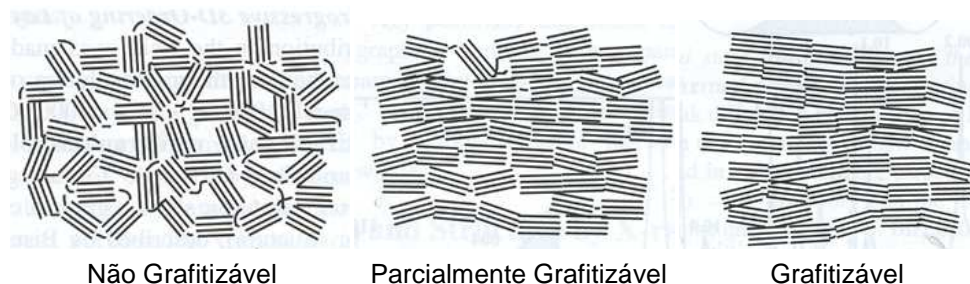
Figura 1.1. Representação esquemática do modelo de Franklin para carvões não grafitizáveis, parcialmente grafitizáveis e grafitizáveis.
