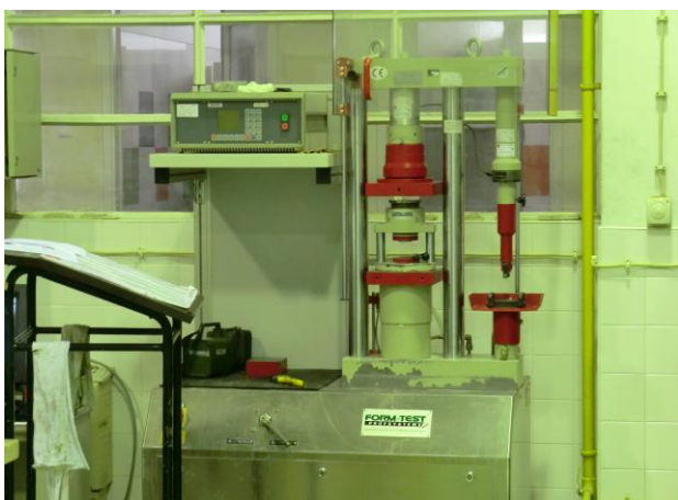
Fig. 34. Máquina ensaio à resistência à flexão e compressão
