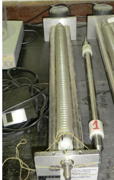
Fig. 18: Suporte com dilatômetro e defletômetro
