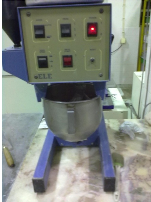
Figura 18 - Misturador do ensaio da Retracção Autogénea
