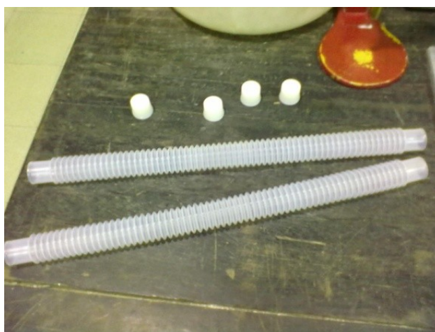
Figura 16 - Moldes (tubo ondulado de polietileno) e tampas
