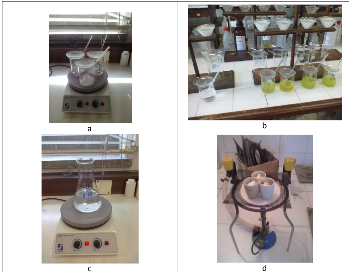
Figura 25 - Determinação Resíduo Insolúvel (a- Solução a aquecer na placa eléctrica, b- Filtragem da amostra, c- Aquecimento do HCl, d – calcinação dos cadinhos)
