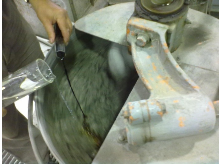
Figura 37 - Adição do Adjuvante no Betão
