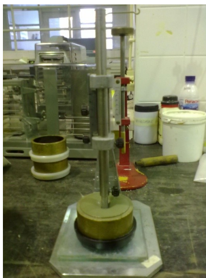
Figura 12 - Determinação da Consistência Normal - Aparelho de VICAT manual com molde cheio
