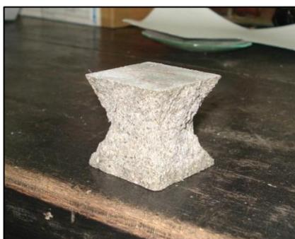
**Figura 4.29 – Forma do provete após o ensaio de compressão**
