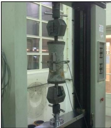
**Figura 3.40 – Provette com os transdutores colocados e fixos à prensa de tracção**
