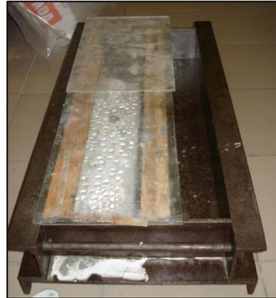
Figura 3.25 – Colocação de um vidro para evitar perdas de água por evaporação
