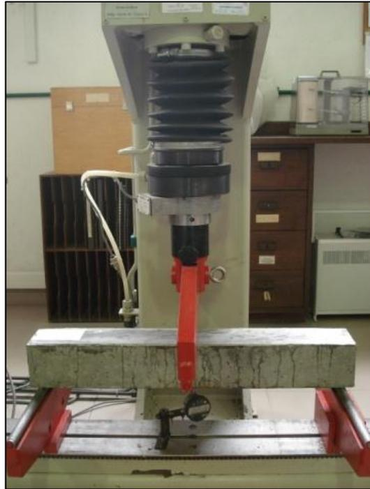
**Figura 3.30 – Ensaio de flexão às vigas 100x100x700**
