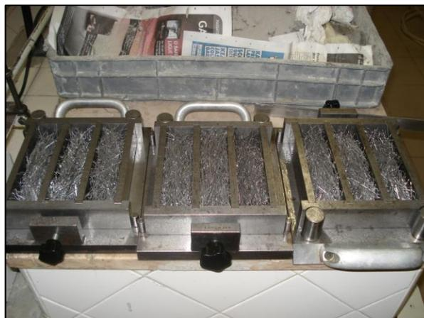
Figura 3.4 – Colocação das fibras nos moles 40x40x160
