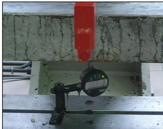
**Figura 3.31 – Colocação de um deflectómetro digital a meio vão da face inferior da viga**
