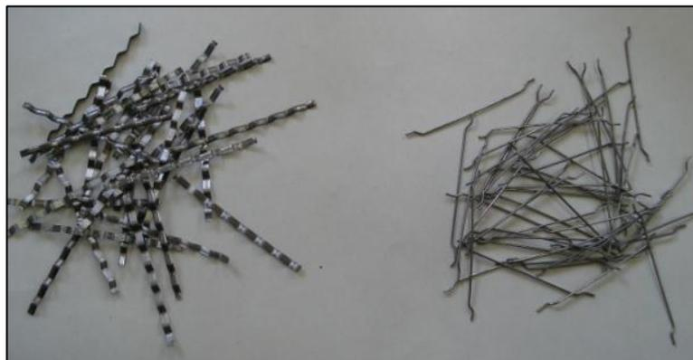
Figura 2.3 – Fibras metálicas utilizadas: à esquerda Fibra 2, à direita Fibra 1
