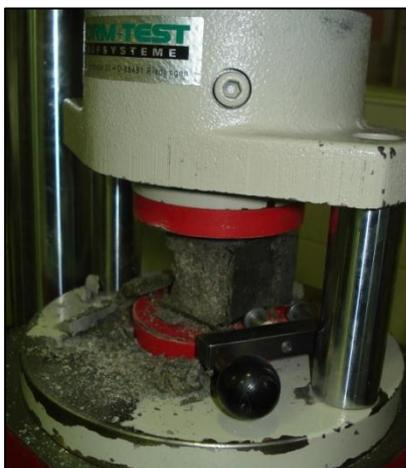
Figura 3.19 – Ensaio de compressão aos prismas
