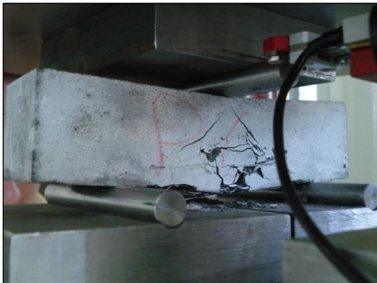
Figura 4.2 – Rotura total do provete
