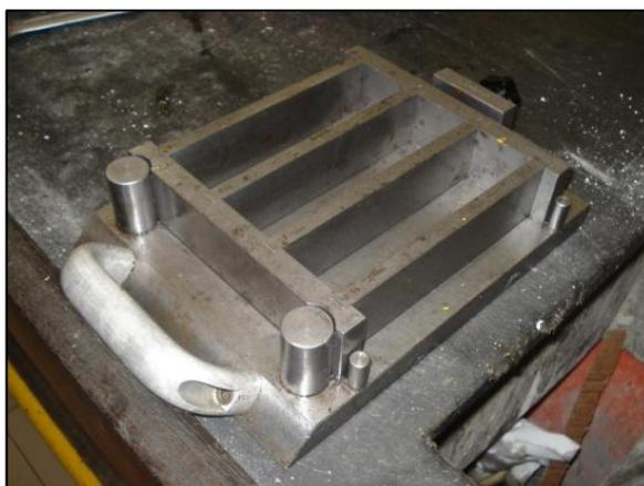
Figura 3.2 – Molde utilizado no ensaio de flexão a prismas
