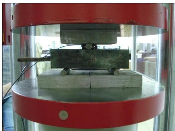
Figura 3.16 – Ensaio de Flexão a um provete prismático 40x40x160
