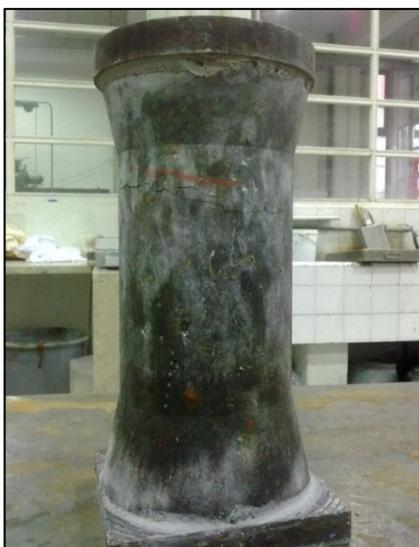
Figura 4.68 – Exemplo de um provete após o ensaio de tracção
