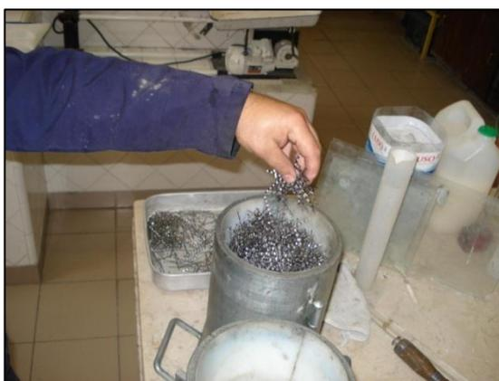
**Figura 3.35 – Colocação aleatória das fibras no molde**
