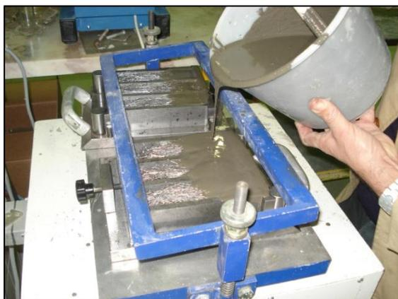
**Figura 3.10 – Colocação da argamassa nos moldes prismáticos**
