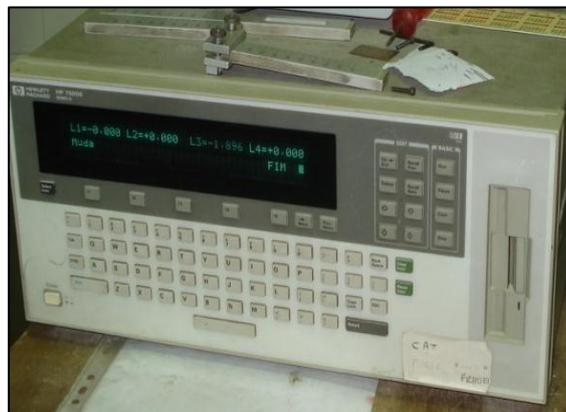
**Figura 3.41 – Máquina de registo e armazenamento de dados**
