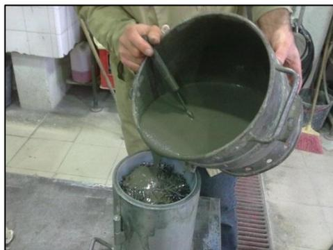
Figura 3.36 – Colocação da argamassa no molde cilíndrico
