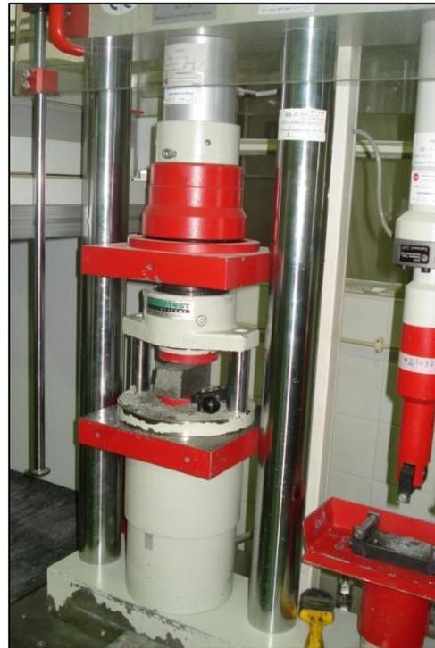
Figura 3.18 – Prensa de compressão de 200kN e flexão de 10kN
