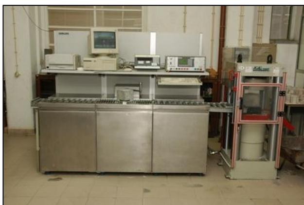
Figura 3.32 – Prensa de compressão de 1500 kN
