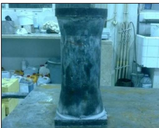
Figura 3.38 – Provete cilíndrico com os discos colocados
