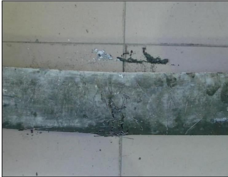
Figura 4.49 – Viga fracturada após o segundo carregamento
