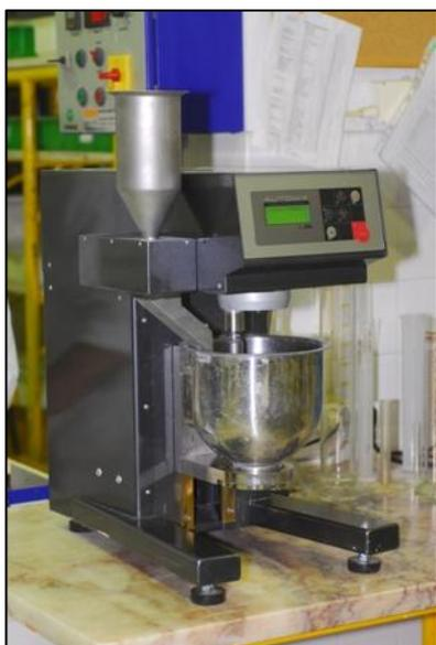
Figura 3.5 – Misturador automático
