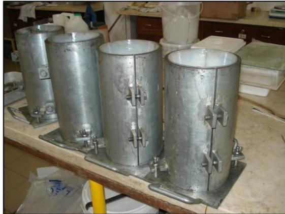
Figura 3.33 – Moldes para a produção dos provetes cilíndricos
