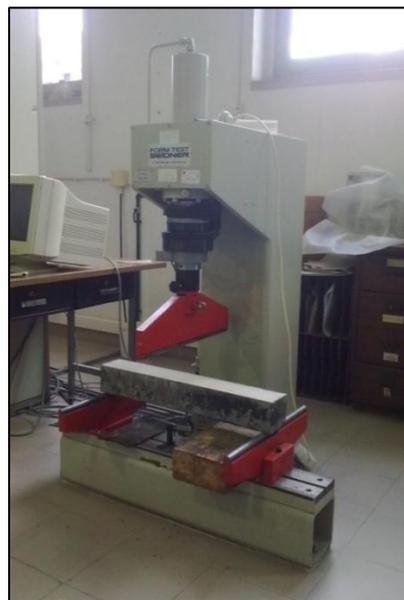
Figura 3.28 – Prensa de flexão de 100kN
