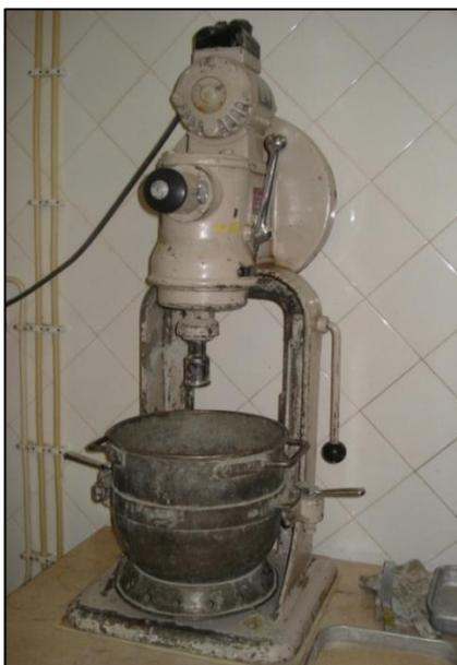
**Figura 3.23 – Misturador manual para argamassas**
