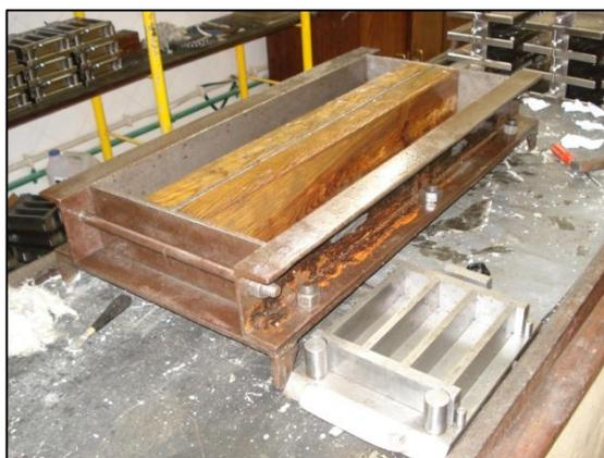
Figura 3.21 – Comparação entre o mole utilizado para produzir as vigas e o molde para produzir os prismas
