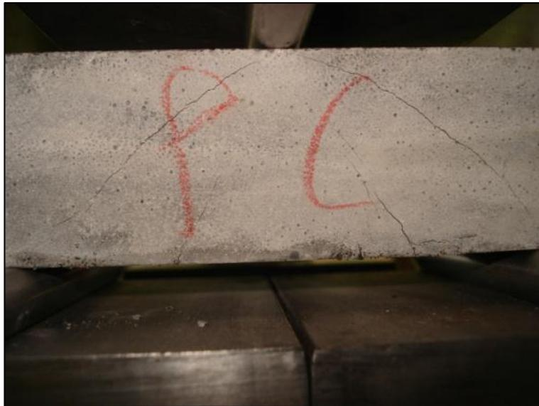
Figura 4.1 – Fissuração do provete
