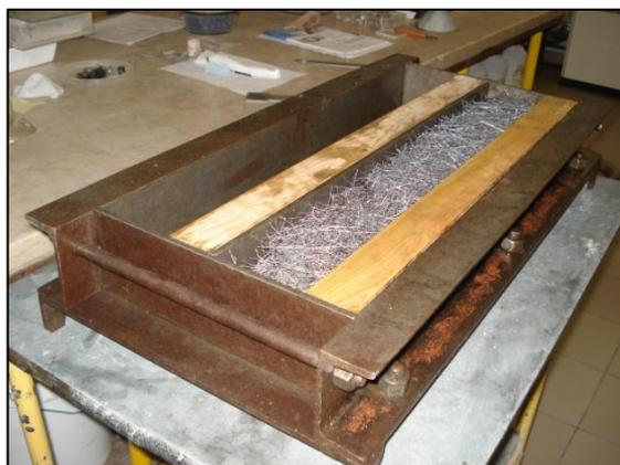
Figura 3.22 – Colocação das fibras nos moles 100x100x700
