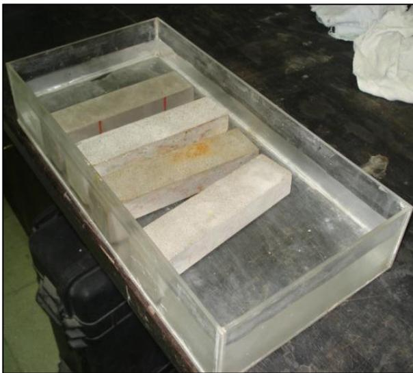
Figura 3.13 – Provetes desmoldados imersos em água
