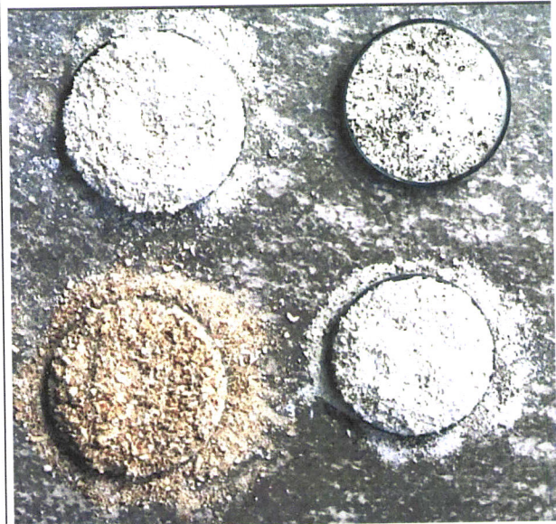
II. 49 – NTPR: Testes com extinção de cal, com óleo, dos mesmos materiais da il. 48.
