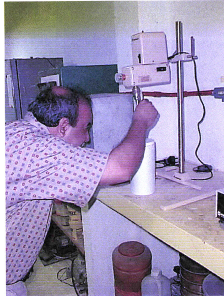
Il. 67 - Realização de ensaio de determinação do tempo de extinção.
