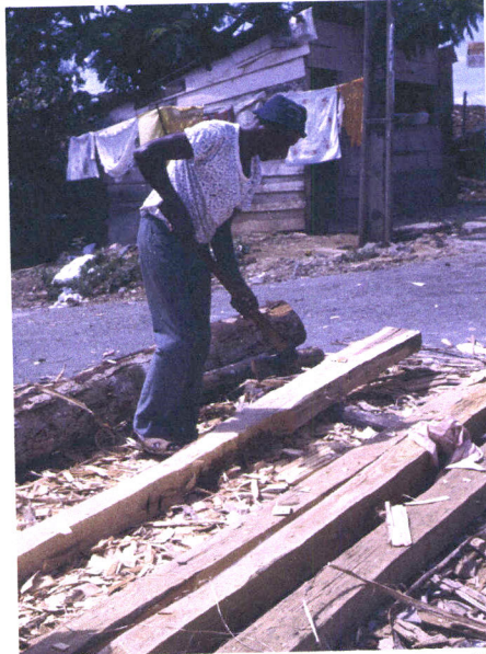
Il. 72 – Salvador (Bahia, Brasil): Operário trabalhando madeira a machado (no Brasil, madeira lavrada).
