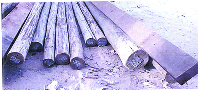
II. 79 – Madeira agrafada para evitar fendilhamento (Século XX).
