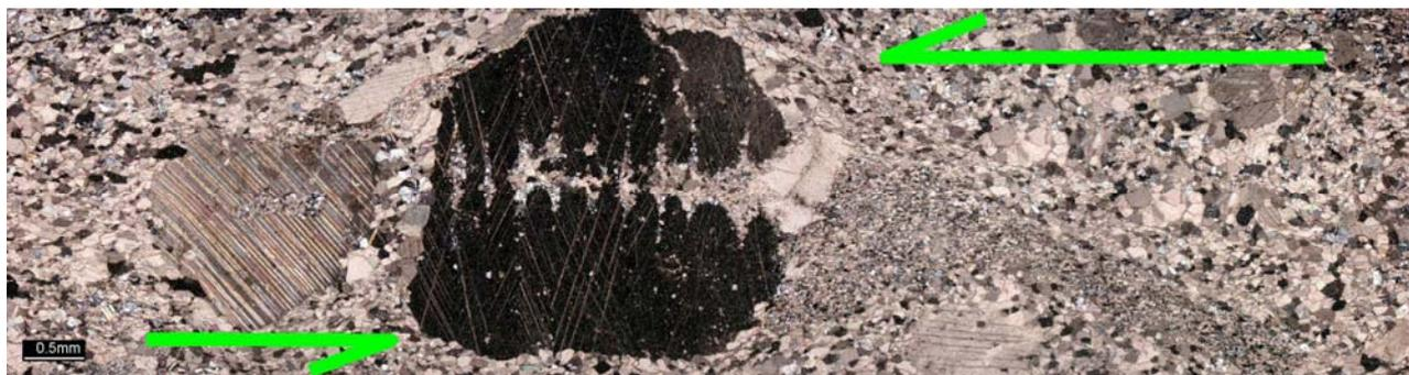
Fig. 4.32 – Outra montagem em computador de 4 microfotografias de outra lâmina onde um fragmento de crinóide funciona como um corpo rígido que sujeito a um campo de tensões tangencial desenvolve sombras de pressão indicando critérios de cisalhamento esquerdo.
