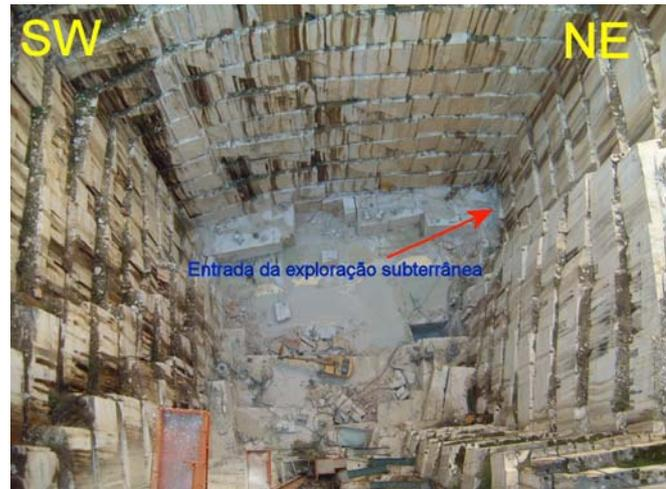
Fig. 5.31 – À esquerda: Fotografia da pedreira FMP, vista da zona de alargamento na direcção da frente Nordeste, mostrando local da futura exploração subterrânea. Retirada de: Gama *et al.*, (2000). Em cima: Fotografia do fundo da pedreira FMP após o início da exploração subterrânea.
