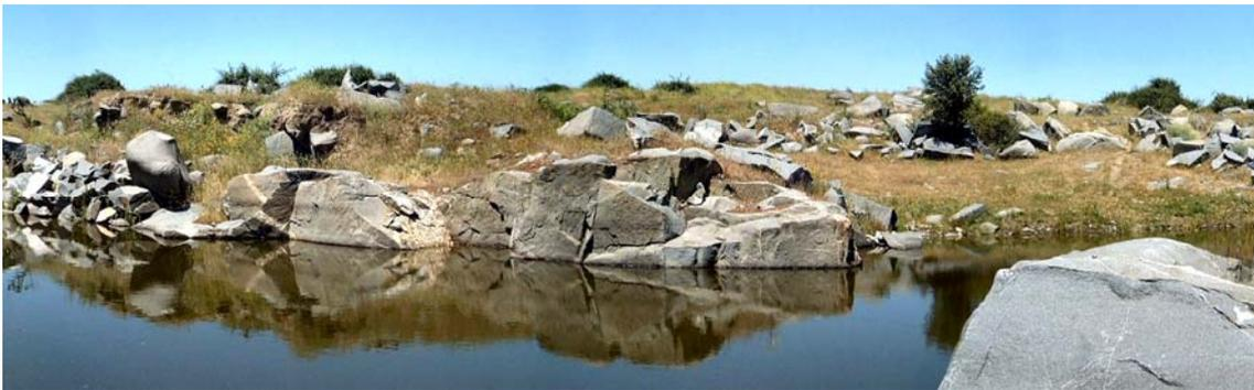
Fig. 6.7 – Vista geral da pedreira abandonada em gabro – dioritos no Monte das Furadas (consultar Fig. 6.3 para localização). A profusão de diaclases com reduzido espaçamento, presença de encraves e filões aplíticos tornou insustentável a exploração destas rochas.
