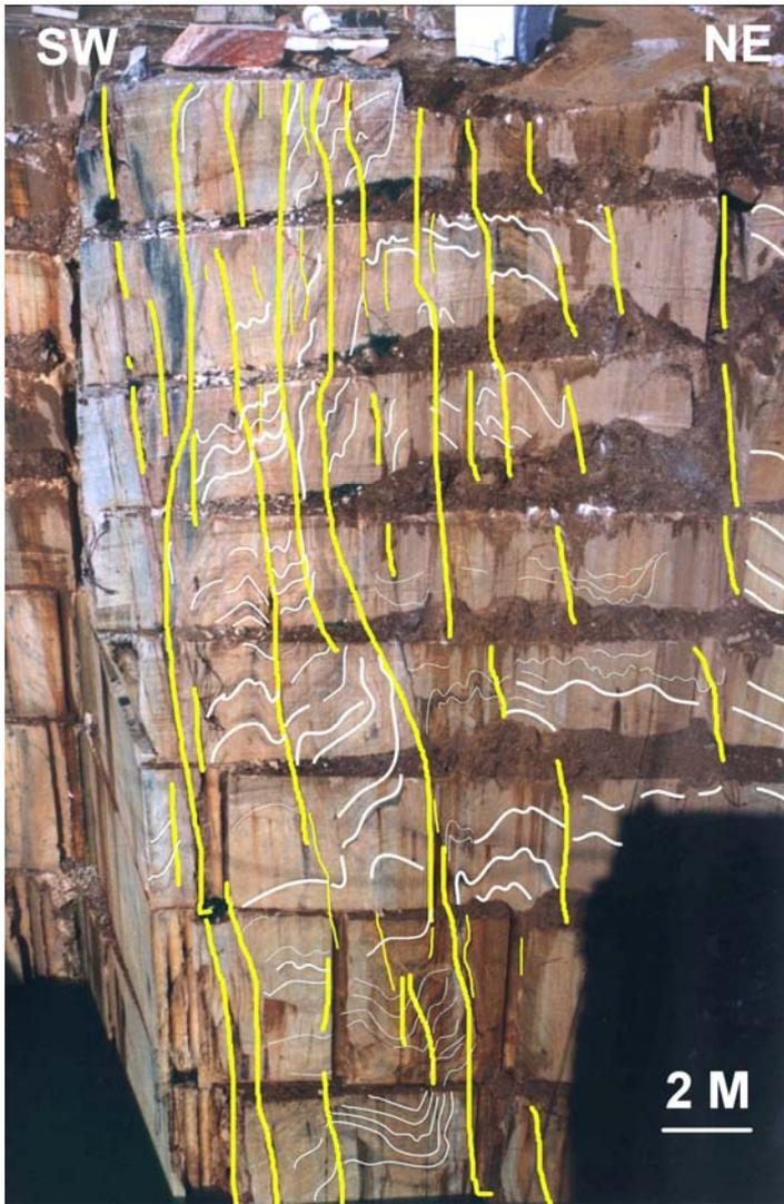
Fig. 5.23 – Esquema interpretativo das estruturas observadas na pedra Alexandre Maximiliano, a Norte da pedra Marmetal – Fonte da Moura. A compartimentação dos mármore pelos acidentes longitudinais está aqui bem marcada e, ainda que existam muitos planos, a parte central da foto da frente da pedra, junto às litologias mais escuras, deve ser considerada uma única banda de cisalhamento.
