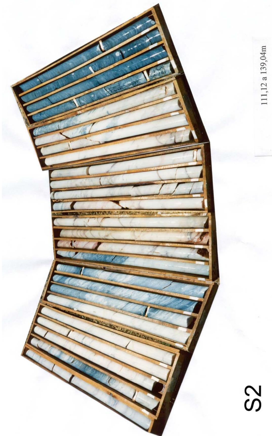
Fig. 5.12 – Exemplo dos testemunhos de sondagens colocados nas caixas de arquivo. No caso está representada a Sondagem SP2 entre os 111.12 e 139.04 metros.
