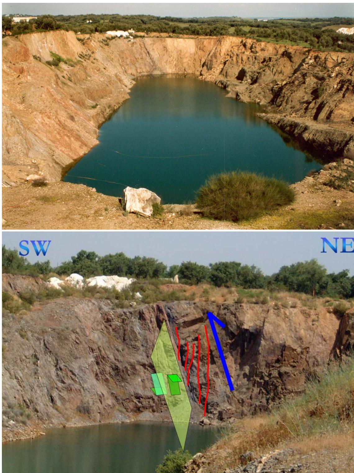
Fig. 4.66 – Em cima, vista geral para NNW da antiga mina de Miguel Vacas (Monte dos Vieiros). Em baixo, o filão cuprífero principal que foi explorado estava associado a um corredor de deformação transpressivo esquerdo situado a NE do anticlinal de Estremoz (ver Mapa em Anexo).
