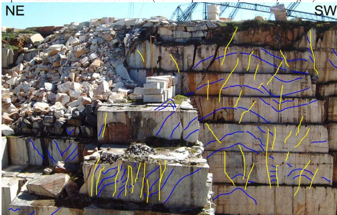
Fig. 4.51 (A, B e C) (Página seguinte) – Pedreira “Batanete” – Olival Grande, flanco SW do anticlinal de Estremoz. Estilo de dobramento característico da segunda fase. Dobras abertas com raio de curvatura bem definido a que se associa estiramento dos flancos. Em baixo pormenor da caixa a verde na figura do meio.
