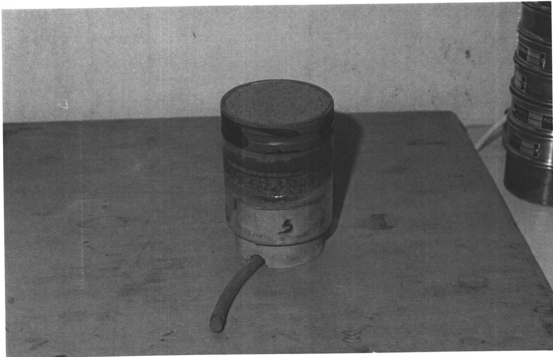
Figura 3.1 - Caixa de destacamento com solo sobre uma camada de areão.
