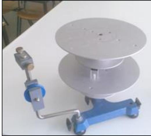
Figura 72 – Dispositivo existente no laboratório de Física para estudos de cinemática e dinâmica da rotação
