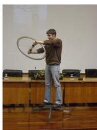
Na imagem podem observar o Tiago em plena demonstração experimental, utilizando o sistema construído, no âmbito da unidade curricular de Introdução à Engenharia. Procure explicar em que consiste a experiência. Mostre a sua utilidade na abordagem da conservação do momento angular.
