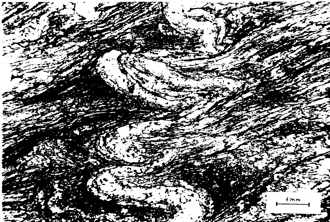
Foto 18 - Microfoto de uma amostra dos níveis pelíticos da Unidade do Moinho do Carneiro, colhida próximo do local da barragem de Alqueva. A clivagem principal, que em afloramento se apresenta como uma clivagem xistenta (ver foto anterior), corresponde a uma crenulação forte que deforma veios de quartzo e uma clivagem anterior, conservada em "microlithons".
