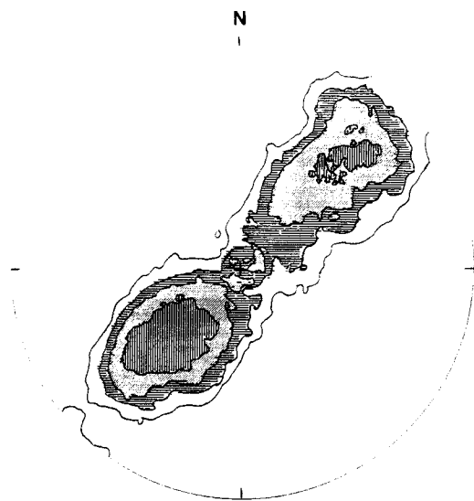
Fig. 23 - Diagrama de densidades dos pólos da clivagem S2 no Domínio de Estremoz-Barrancos, com base em 1042 medições. Máxima concentração em torno do polo do plano N44W;36NE. As linhas de contorno correspondem a concentrações de 1, 2, 3, e 5%.
