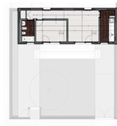
FOGO AMPLIADO T2 área bruta 74,64 m 2 área útil 59,83 m 2
