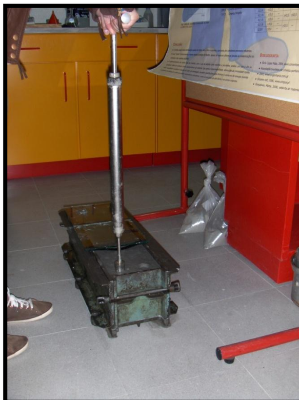
Figura 6.14 - Realização de um ensaio de penetração com o aparelho utilizado para o efeito
