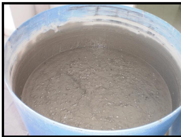
Figura 7.1 – Amassadura do BAC base com Glenium
