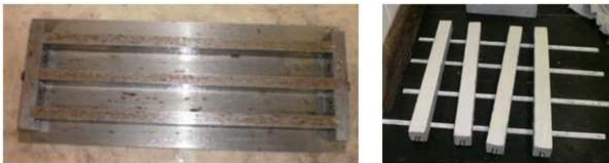
Figura 6.9 - Molde e provetes 2,5x2,5x28,5 cm de retração total livre
