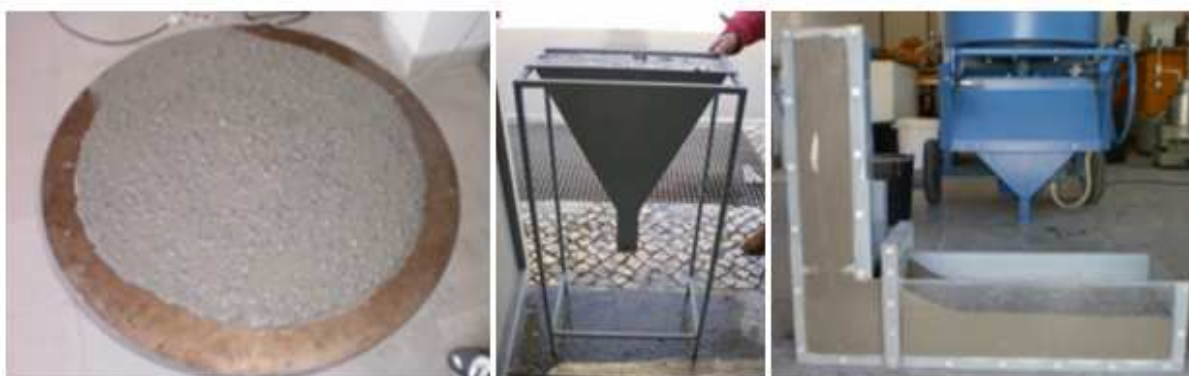
Figura 6.2- Ensaio de Espalhamento (esquerda), Escoamento no "Funil V" (meio) e "Caixa L" (direita)
