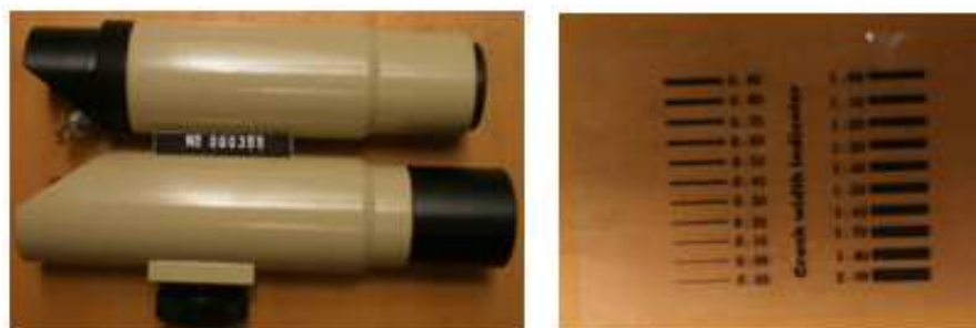
Figura 6.13- Microscópio eletrónico e folha de acetato graduada para medição da espessura de fissuras
