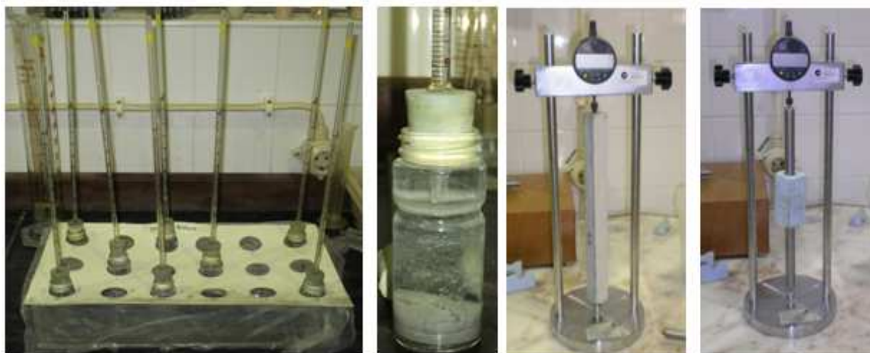
Figura 6.8- Retração química (esquerda), leituras de retração total (meio), medidor de comprimento dotado de um defletómetro com uma barra comparadora(direita)
