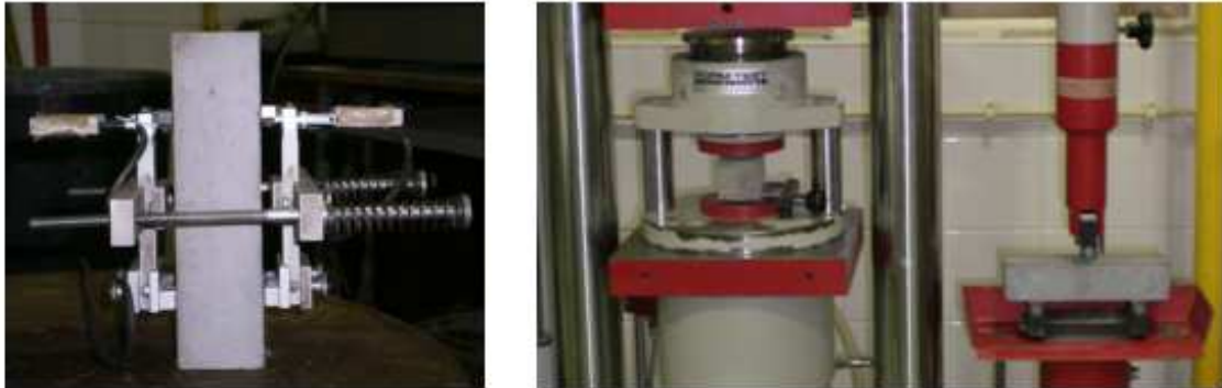
Figura 6.7 - Ensaio do E_0 (esquerda), compressão (meio) e tração (direita)
