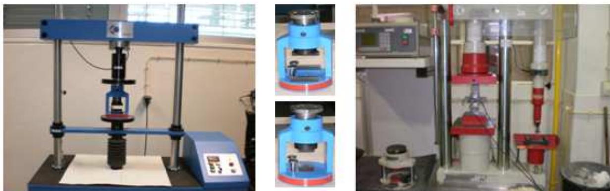
Figura 6.6- Máquina universal (esquerda), adaptações para o ensaio de flexão e compressão (meio), máquina de flexão, compressão e E_o (direita)
