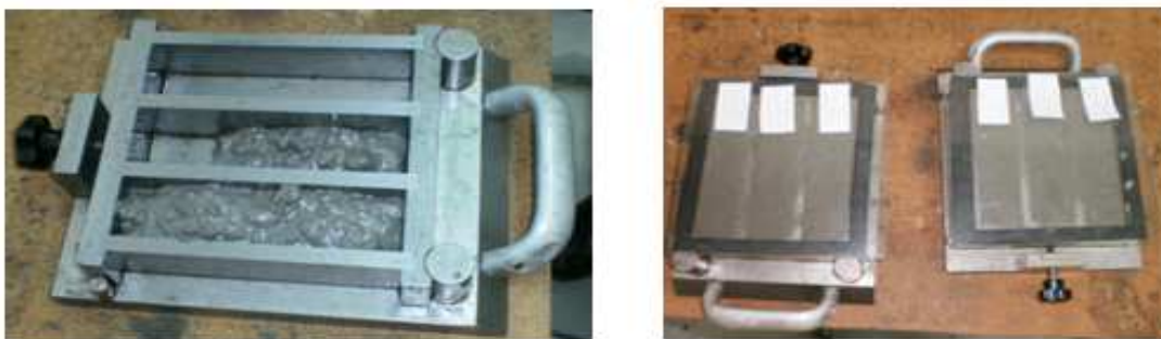
Figura 6.5- Moldagem e conservação de provetes 4x4x16 cm, para ensaios de flexão, compressão e E_o
