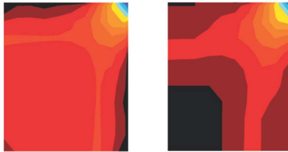
Figura 2.16 - Área de fissuração (preto) em lajes de espessura de 2m (esquerda) e 3m (direita), adotado de [66]
