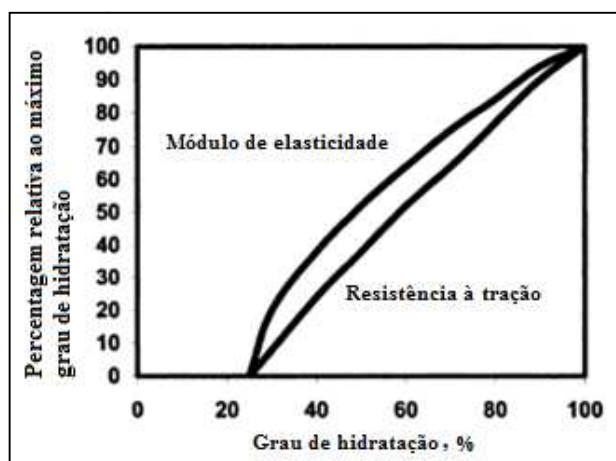
Figura 2.15 - Representação esquemática do desenvolvimento relativo do módulo de elasticidade e resistência à tração, adotado de [73]
