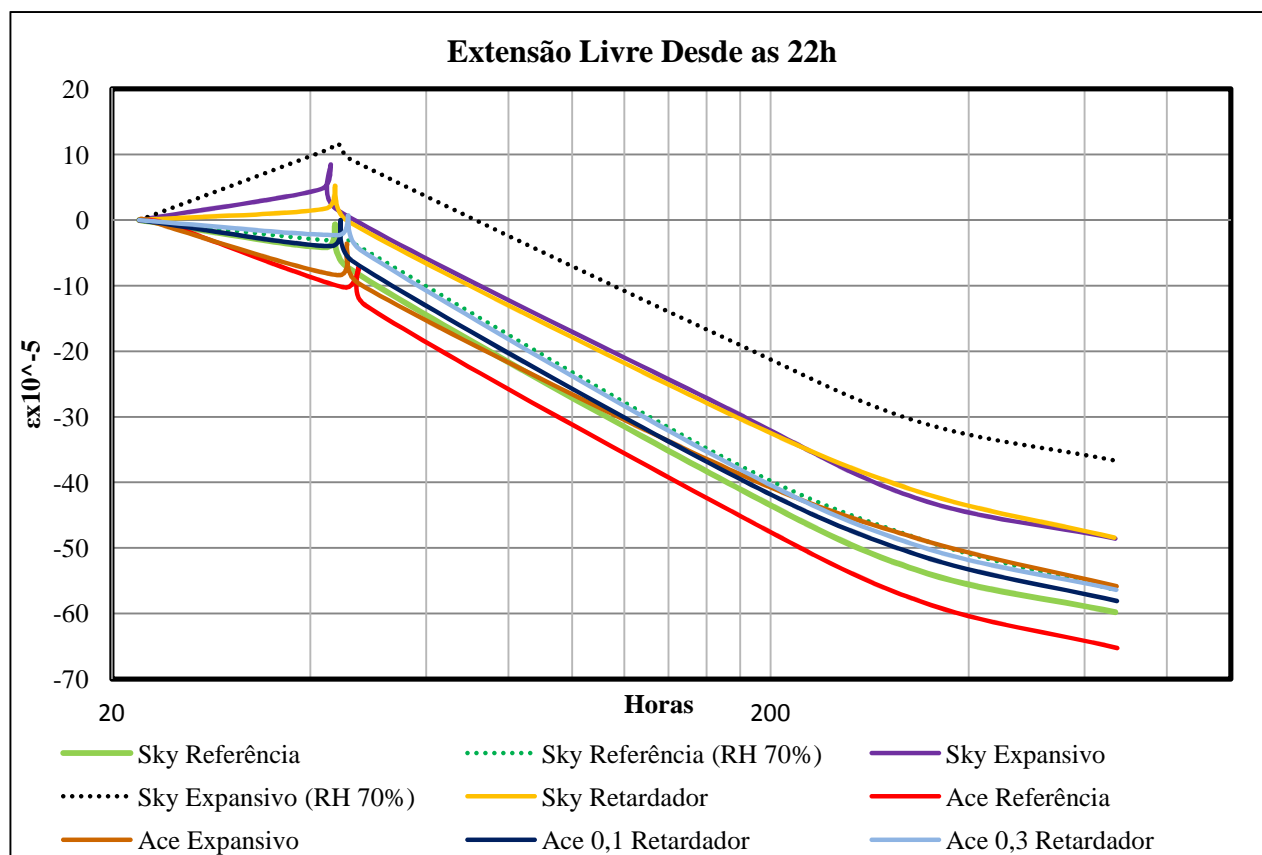
Figura 6.30 - Retração total livre de provetes com as dimensões 2,5x2,5x28,5cm, desde as 22h
