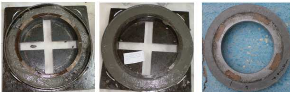
Figura 6.10- Ensaio de anel, moldagem (esquerda), após moldagem (meio) e desmoldado (direita)
