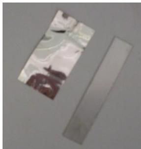
**Figura 3.4.** À esquerda, eléctrodo auxiliar (chapa de platina) e à direita, eléctrodo de trabalho (chapa de aço inoxidável).
