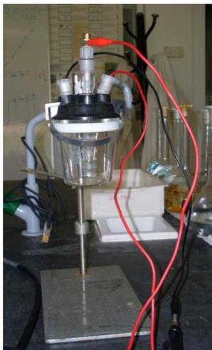
**Figura 3.2. Célula eletroquímica e sistema de três elétrodos.**
