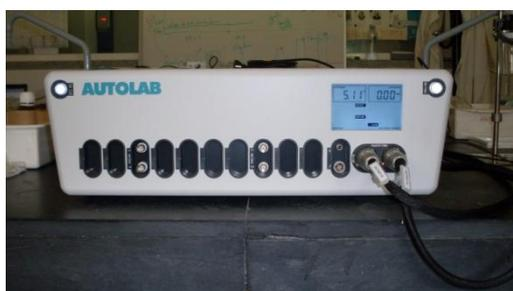
Figura 3.1. Potencióstato/Galvanóstato AUTOLAB PGSTAT 128N.
