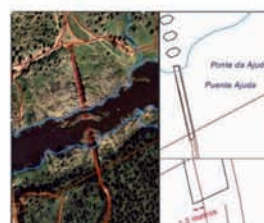
Figura 2. Test de continuidad de las cartografías a escala 1:10000. Del lado portugués, la del IGP y del lado español, la de la DGUOT-JE.
